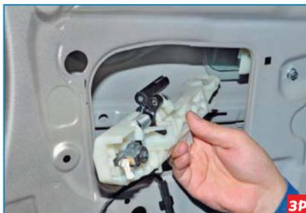
...и снимаем основание ручки.
