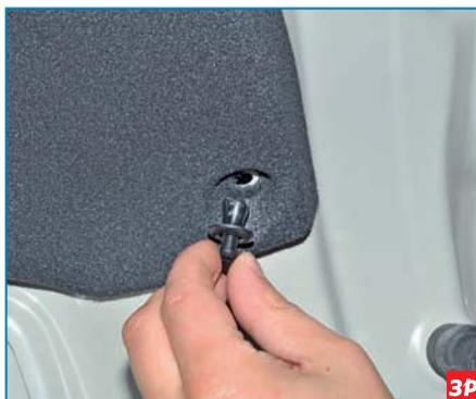
...и извлекаем pistоны из отверстий внутренней панели багажника.
