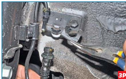
Пассатижами вынимаем стопорную скобу крепления верхнего наконечника шланга к кронштейну кузова и выводим верхний наконечник шланга из кронштейна кузова.
