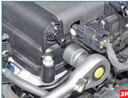
Головкой «на 21» выворачиваем клапан из резьбового отверстия в крышке головки блока цилиндров...
