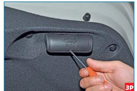
Поддев отверткой крышку ручки...
