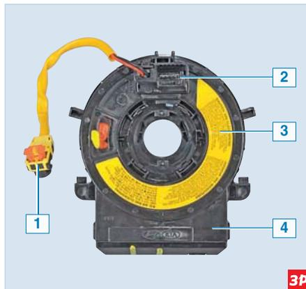
**Барабанное устройство со спиральным кабелем:** 1 – колодка проводов подушки безопасности; 2 – поводок; 3 – барабан; 4 – корпус устройства
