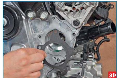
Снимаем уплотнительную прокладку насоса.
