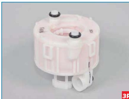
Топливный фильтр с уплотнительными кольцами на входном и выходном штуцерах.
