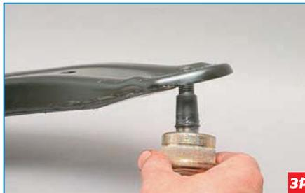
...выпрессовываем шаровую из рычага. Снимаем пыльник с новой шаровой опоры. Запрессовываем новую опору в рычаг до упора...
