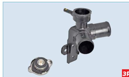
Заливная горловина и крышка заливной горловины
