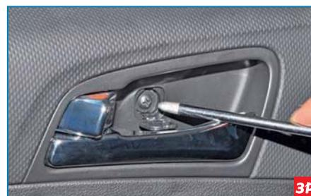
Крестообразной отверткой отворачиваем саморез крепления декоративной накладки к внутренней панели двери.
