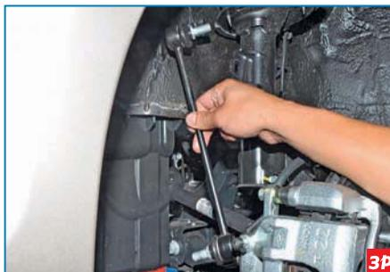
Снимаем стойку стабилизатора поперечной устойчивости.
