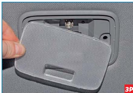
...и снимаем рассеиватель.
