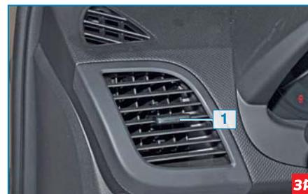
**Дефлектор системы отопления и вентиляции: 1 – рычаг изменения направления потоков воздуха**
