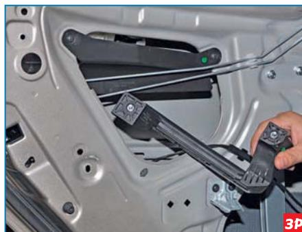
...и вынимаем ее через технологическое отверстие во внутренней панели двери.
