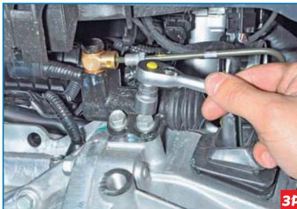
Головкой «на 12» отворачиваем два болта крепления рабочего цилиндра к картеру сцепления...
