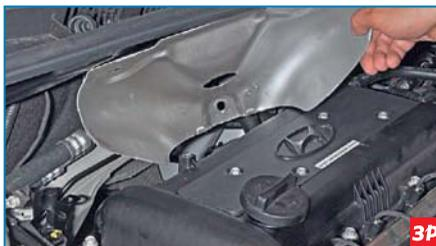
Снимаем теплозащитный экран через моторный отсек.
