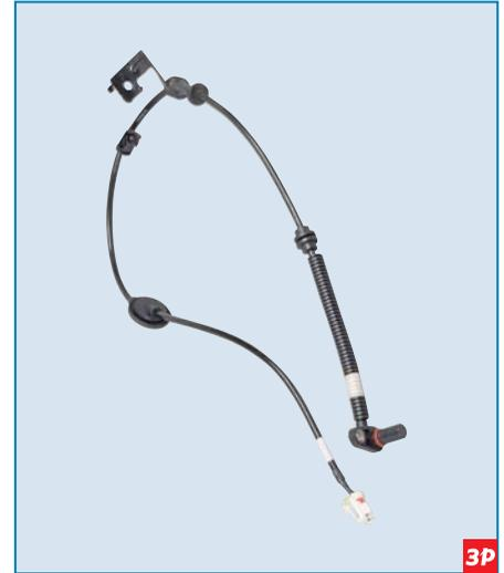
Датчик скорости вращения заднего колеса со жгутом проводов и держателем. Датчик правого заднего колеса снимаем аналогично.
