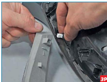
Отсоединяем колодку проводов от разъема корпуса бокового указателя поворотов.
