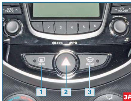
**Расположение верхних выключателей на центральной консоли:** 1 – выключатель обогрева заднего стекла; 2 – выключатель аварийной сигнализации; 3 – выключатель обогрева ветрового стекла в зоне остановки щеток
