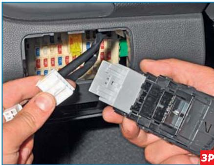
Снимаем блок регуляторов (см. «Снятие выключателей и регуляторов», с. 223).
