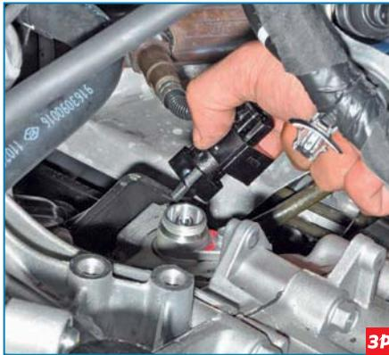
Рукой отворачиваем датчик скорости. Если таким образом снять датчик не удалось, то отворачиваем его ключом «на 22» за шестигранник, выполненный на корпусе датчика. Устанавливаем датчик скорости автомобиля в обратной последовательности. При этом...
