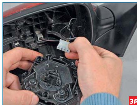
...отсоединяем ее от разъема блока мотор-редукторов.
