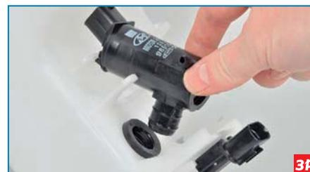
...и, преодолевая сопротивление уплотнительного кольца, вынимаем корпус насоса из кольца и фиксатора.
