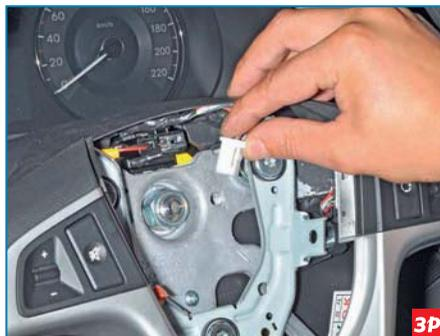
Отсоединяем колодку жгута проводов рулевого колеса.
