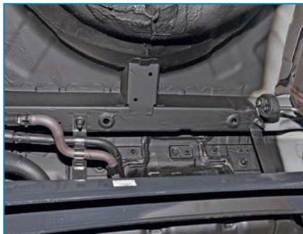
Расположение шлангов, трубок и элементов крепления топливного бака.
