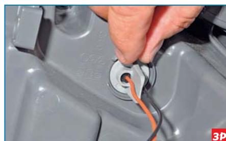
Поворачиваем против часовой стрелки патрон лампы света заднего хода.
