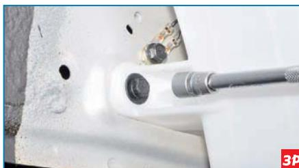
Головкой «на 10» отворачиваем болт среднего крепления бачка.
