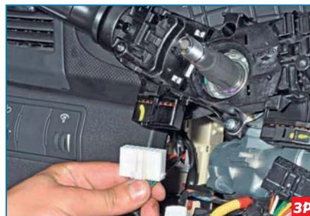
Нажав на фиксатор колодки, отсоединяем колодку проводов от левого подрулевого переключателя.
