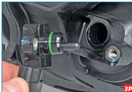
...и вынимаем датчик из гнезда трубопровода.
