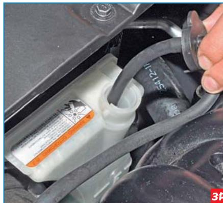
...снимаем крышку расширительного бачка вместе со шлангом.
