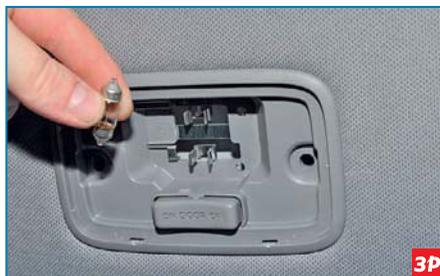
**Вынимаем лампу из плафона.**
