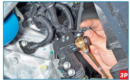
Снимаем защитный колпачок со штуцера прокачки гидропривода сцепления.
