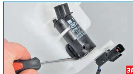
Шлицевой отверткой поддеваем корпус насоса...
