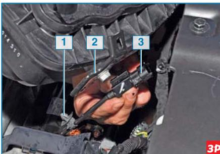
...отсоединяем держатель 1 жгута проводов датчика детонации и колодку 3
