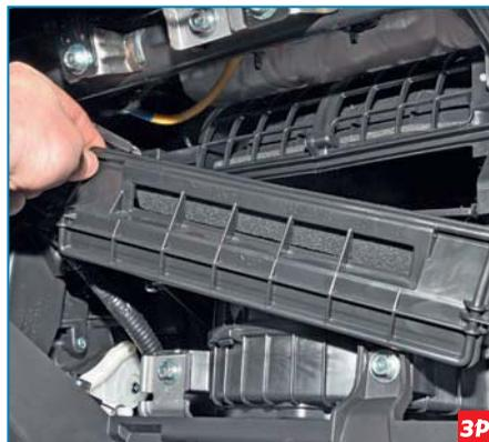
...и снимаем крышку.
