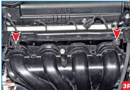
Головкой «на 10» отворачиваем два болта крепления к впускному трубопроводу кожуха жгута проводов форсунок...
