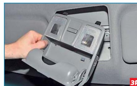
Вынимаем плафон из обивки потолка.
