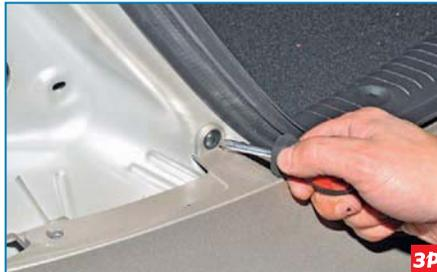
Крестообразной отверткой отворачиваем саморез.
