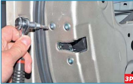
Ключом Torx T-30 отворачиваем три винта крепления замка к торцу двери...
