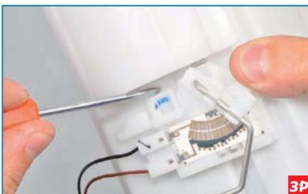
Поддев шлицевой отверткой фиксатор датчика указателя уровня топлива...
