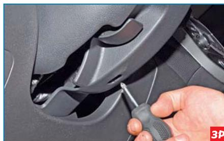
Этим же инструментом отворачиваем саморез нижнего крепления кожуха.
