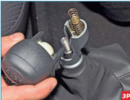
Отвернув рукоятку, снимаем ее с рычага переключения передач.
