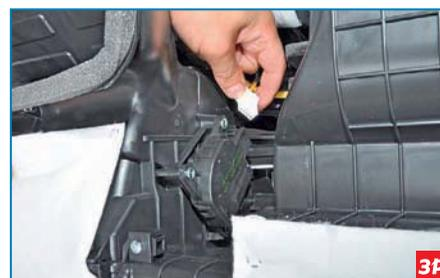
Нажав на фиксатор колодки, отсоединяем колодку проводов от электропривода заслонки рециркуляции.
