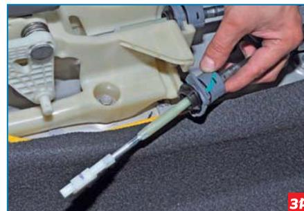
...и вынимаем наконечник оболочки троса выбора передач из основания механизма управления.
