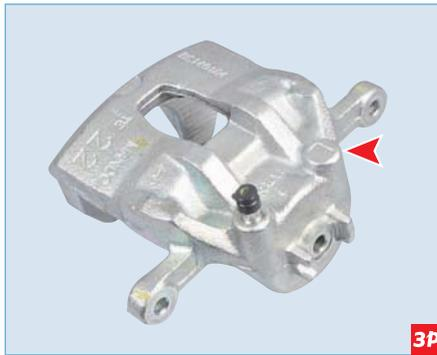
**На суппорте левого тормозного механизма имеется маркировка L. На суппорте правого тормозного механизма – маркировка R**
