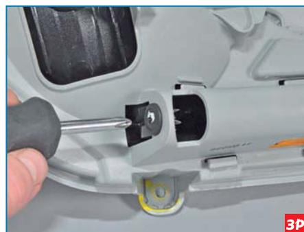
Крестообразной отверткой выворачиваем винт пистона...
