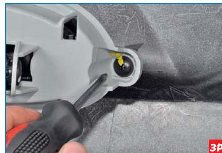
Крестообразной отверткой отворачиваем четыре самореза крепления фары к бамперу.
