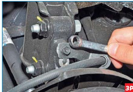
Ключом «на 10» отворачиваем болт крепления держателя тормозного шланга к поворотному кулаку...
