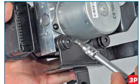
Шестигранником «на 5» отворачиваем специальный винт крепления втулки...
