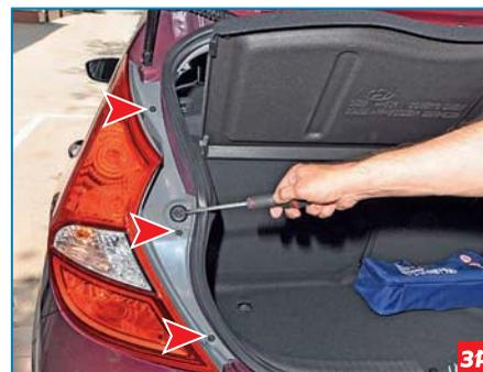
...и крестообразной отверткой отворачиваем четыре самореза крепления заднего фонаря к кузову.
