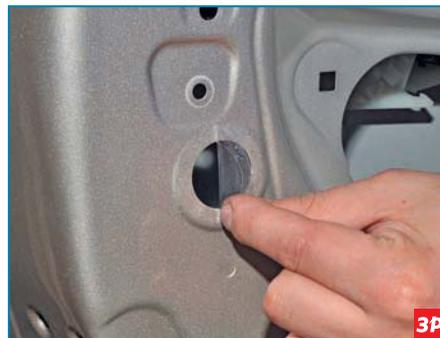
Отклеиваем прозрачную пленку, закрывающую отверстие во внутренней панели двери.
