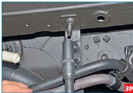
...сзади две гайки (по одной на каждой хомут)...
