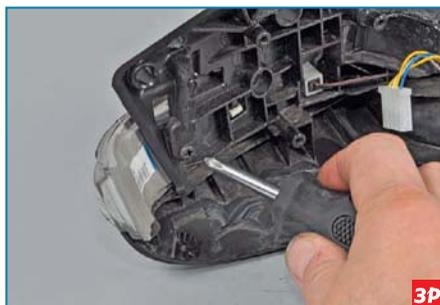
Крестообразной отверткой отворачиваем саморез крепления корпуса бокового указателя поворотов.
