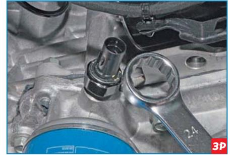
Накидным ключом «на 24» выворачиваем датчик из отверстия в поддоне картера...
