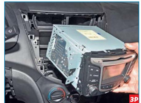
...снимаем головное устройство системы звуковоспроизведения (см. «Снятие головного устройства системы звуковоспроизведения», с. 230).
