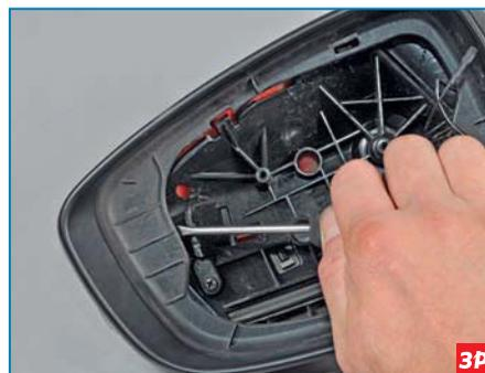
...шлицевой отверткой поддеваем пластмассовую рамку корпуса зеркала...
