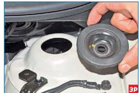
...и снимаем верхнюю резинометаллическую шайбу.
