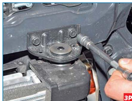
Головкой «на 10» отворачиваем два болта крепления левой верхней опоры радиатора...
