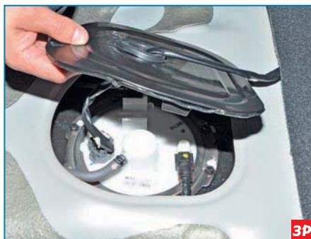
...и отводим крышку лючка. При выключенном зажигании сжимаем фиксаторы колодки жгута проводов...
