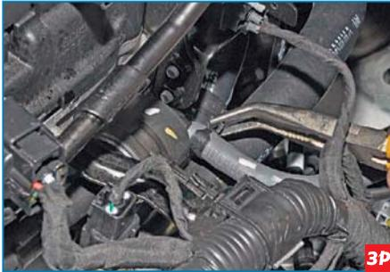
Сжав концы хомута крепления шланга подвода паров топлива к клапану...
