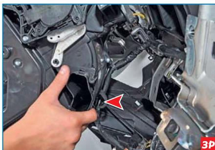
Выводим жгут проводов из держателя на корпусе отопителя.
