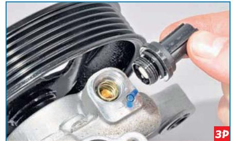
...и снимаем его с насоса.
