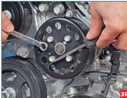
...накидным ключом «на 10» поочередно ослабляем затяжку каждого из четырех болтов крепления шкива.
