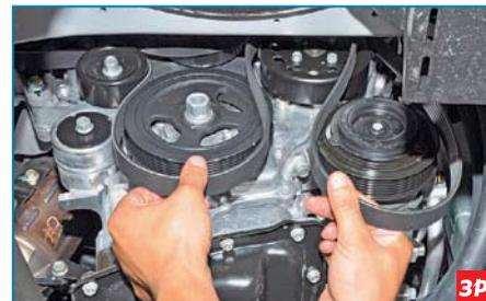
...и снимаем ремень привода вспомогательных агрегатов.
