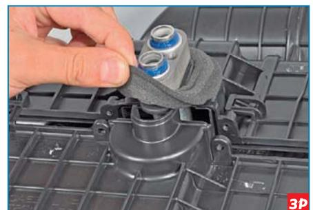
Снимаем поролоновый уплотнитель с кожуха испарителя.
