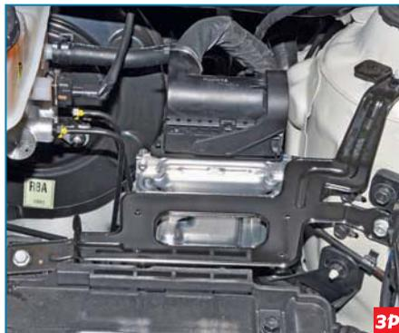
Расположение блока управления в моторном отсеке.
