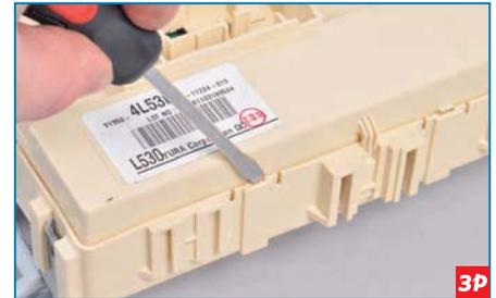
...отверткой поочередно отжимаем шесть фиксаторов нижней крышки блока.
