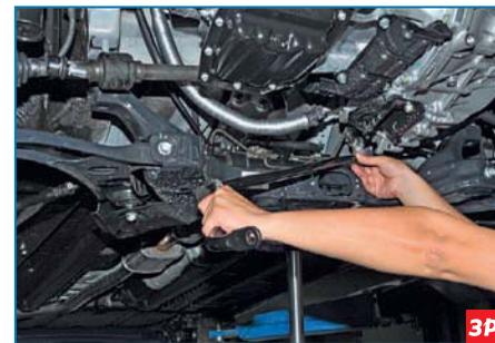
Снимаем штангу стабилизатора поперечной устойчивости.
