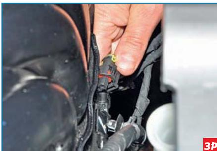
Нажав на фиксатор, отсоединяем колодку жгута проводов от колодки проводов датчика детонации.
