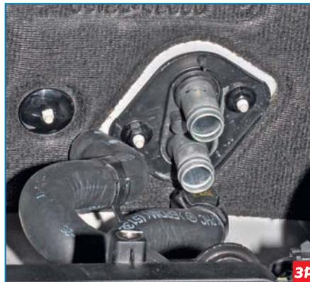
Отсоединяем шланги системы охлаждения от патрубков радиатора отопителя.
