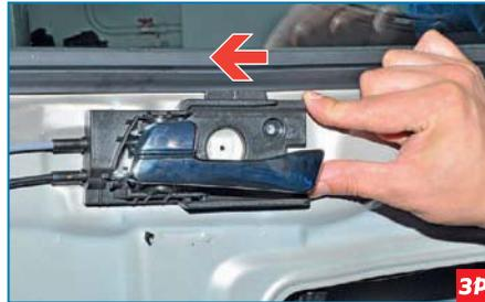
Сдвигаем внутреннюю ручку назад так, чтобы лапки основания ручки вышли из квадратных отверстий во внутренней панели двери.
