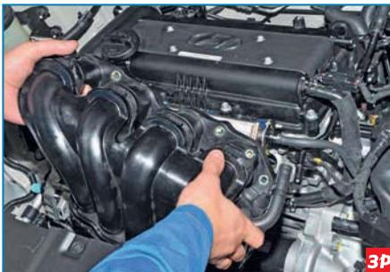
Сдвигаем впускной трубопровод со шпилек головки блока цилиндров, и повернув трубопровод...
