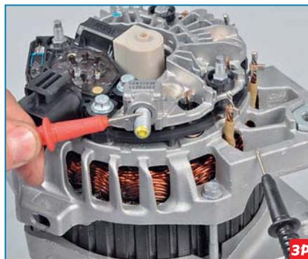
...«плюс» цифрового тестера (в режиме проверки диодов) подсоединяем к выводу «В+» генератора, а «минус» – к его корпусу.
