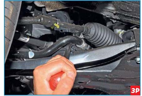
**Монтажной лопаткой пытаемся сдвинуть штангу стабилизатора относительно подрамника.**
