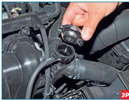
Снимаем крышку заливной горловины.
