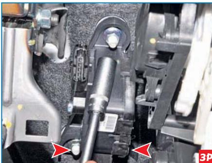
Высокой головкой «на 12» отворачиваем три гайки шпилек крепления педали к щитку передка...
