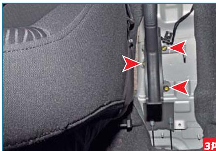
Головкой «на 12» отворачиваем три болта крепления кронштейна рычага стояночного тормоза к полу.
