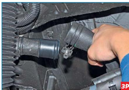
...и снимаем шланг с патрубка наливной трубы.
