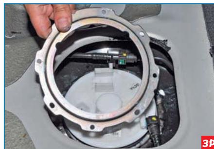
...и снимаем пластину.
