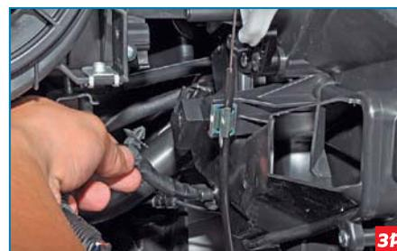
Отсоединяем от корпуса отопителя держатель проводов, расположенный между корпусом отопителя и корпусом вентилятора.
