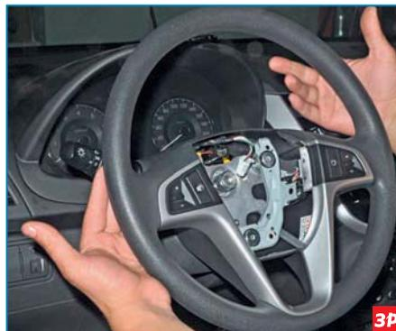
Покачивая, тянем на себя рулевое колесо и снимаем его со шлицов вала. Помечаем маркером взаимное положение вала и ступицы рулевого колеса.
