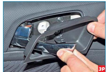
Снимаем декоративную накладку внутренней ручки, выводя рычаг ручки через отверстие в накладке.
