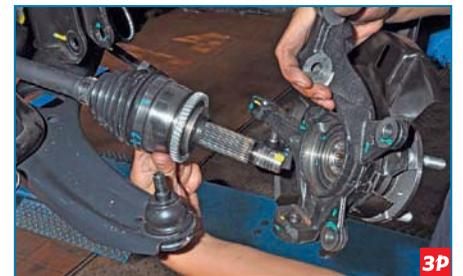
Снимаем поворотный кулак. Зажимаем его в тисках.
