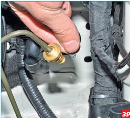
...снимаем уплотнительное кольцо и заменяем новым.
