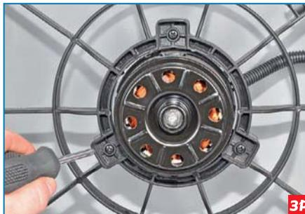
Крестообразной отверткой отворачиваем три винта крепления электродвигателя к кожуху...
