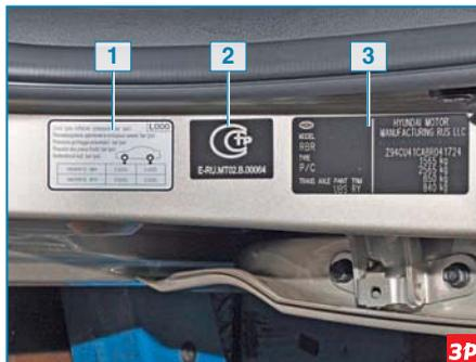
В нижней части стойки двери водителя наклеены таблички производителя, в которых содержится информация об автомобиле.
