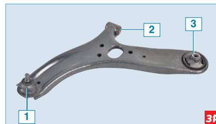
**Рычаг передней подвески:** 1 – шаровая опора; 2 – сайлент-блок переднего крепления к подрамнику; 3 – сайлент-блок заднего крепления к подрамнику
