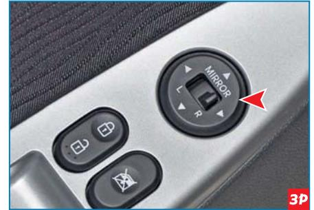
**Регулятор управления электроприводом наружных зеркал заднего вида**
