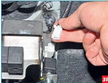
Нажав на фиксатор, отсоединяем колодку жгута проводов от выключателя реле стартера.
