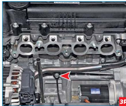
Расположение датчика детонации на передней стенке блока цилиндров (для наглядности показано при снятом впускном трубопроводе).
