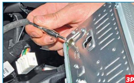
Вынимаем из гнезда штекер антенны.
