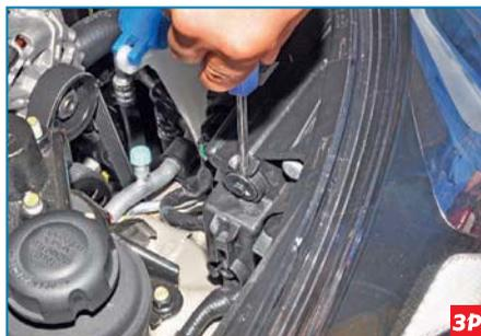
Поворачивая крестообразной отверткой регулятор, расположенный ближе к оси автомобиля, изменяем положение светового пучка в вертикальной плоскости.
