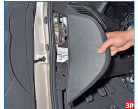
Поддев отверткой, снимаем с двух сторон панели приборов боковые облицовки.
