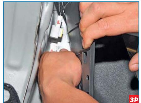
...отсоединяем колодку жгута проводов датчика от разъема жгута проводов.
