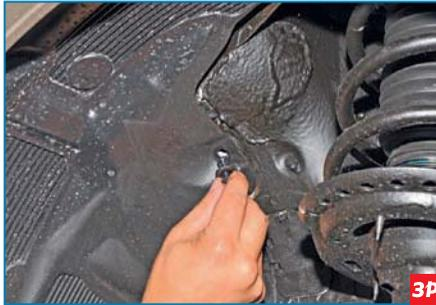
Аналогично вынимаем пистон верхнего переднего крепления подкрылка в арке переднего колеса.
