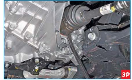
Опираясь лопаткой на ребро картера коробки передач, преодолеваем сопротивление стопорного кольца и выталкиваем хвостовик корпуса внутреннего шарнира наружу из шлицевого отверстия полуосевой шестерни дифференциала.
