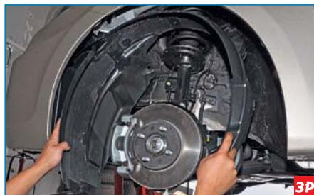
...и подкрылок переднего колеса (см. «Снятие брызговиков и подкрылков передних колес», с. 234).
