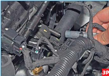
...снимаем шланг со штуцера клапана.
