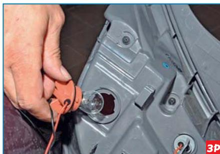
Вынимаем патрон с лампой из корпуса фонаря.
