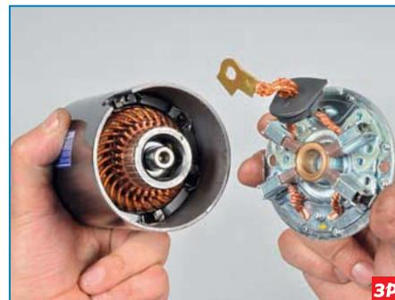
Снимаем заднюю крышку со щеткодержателем.
