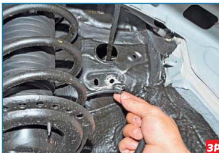
Вынимаем держатель жгута проводов датчика из отверстия кузова в арке колеса.
