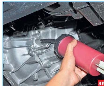
...шприцем (для трансмиссионного масла) доливаем масло в коробку передач до нижней кромки отверстия (масло начнет вытекать из отверстия). Доливаем масло той же марки, что и было залито в коробку передач.
