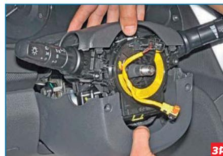
Преодолевая сопротивление пластмассовых защелок, разъединяем кожухи (рулевое колесо для наглядности снято)...
