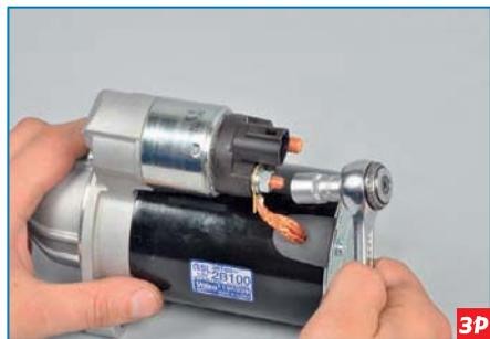
Головкой «на 10» отворачиваем гайку...
