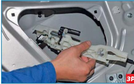
...и снимаем основание ручки. Устанавливаем наружную ручку задней двери в обратной последовательности.
