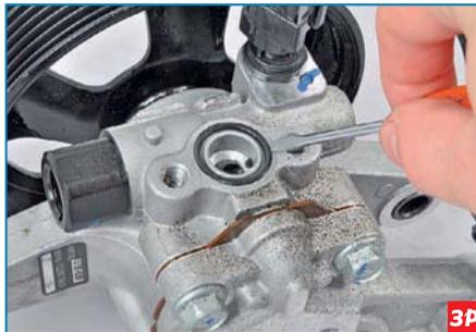
Если резиновое уплотнительное кольцо фланца трубки наливной магистрали повреждено или потеряло эластичность, отверткой поддеваем его и заменяем новым.
