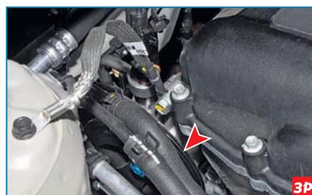
Насос гидроусилителя рулевого управления расположен в моторном отсеке, с правой стороны, между двигателем и щитком передка.
