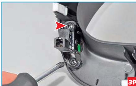
...крестообразной отверткой отворачиваем два самореза крепления кнопки к накладке...
