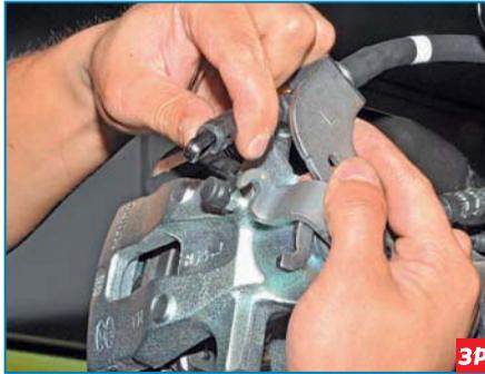
Потянув наконечник троса назад, снимаем его с рычага суппорта.
