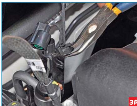
Пассатижами сжимаем лапки держателя провода...
