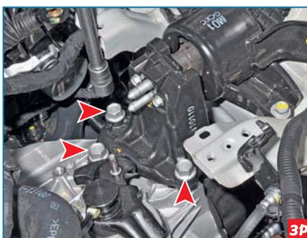
...и три болта крепления кронштейна левой опоры двигателя к картеру коробки передач.
