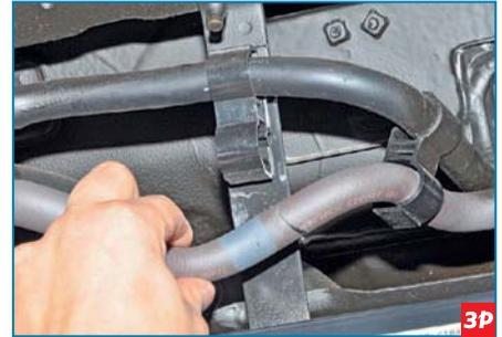
Выводим шланг подвода воздуха к адсорберу из пластмассового держателя, расположенного на левом стальном хомуте крепления бака.
