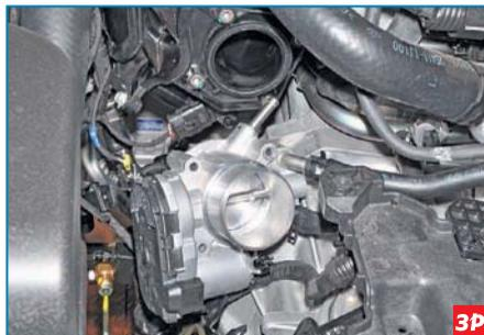
...отводим дроссельный узел в сторону, не отсоединяя от его штуцеров шланги подвода и отвода охлаждающей жидкости.
