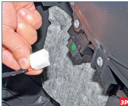
Нажав на фиксатор, отсоединяем колодку проводов от выключателя электростеклоподъемника...
