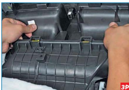
Отжимая отопитель от панели приборов, выводим концы воздухопроводов из фланца отопителя.
