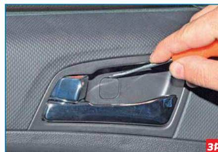
Поддеваем отверткой заглушку в декоративной накладке внутренней ручки двери...
