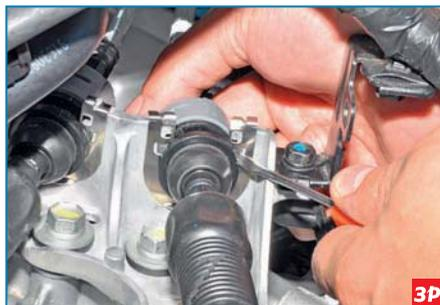
Отверткой поджимаем с обеих сторон фиксаторы стопорной скобы...
