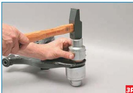
...используя головки «на 41» и «46» или отрезки труб подходящих диаметров. Фиксируем опору стопорным кольцом и устанавливаем пыльник.
