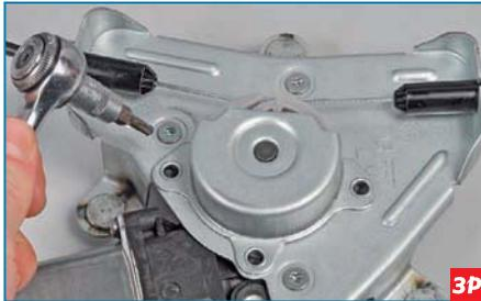
...ключом Torx T-20 отворачиваем три самореза крепления мотор-редуктора к кронштейну...
