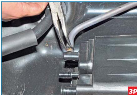
Сжав концы хомута крепления шланга подвода паров топлива к адсорберу, сдвигаем хомут по шлангу...
