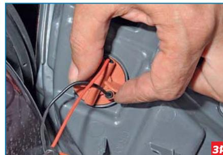
Поворачиваем против часовой стрелки патрон лампы противотуманного света.
