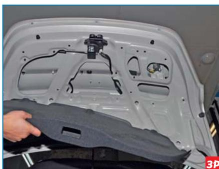
Снимаем обивку крышки багажника. Устанавливаем обивку крышки багажника в обратной последовательности.
