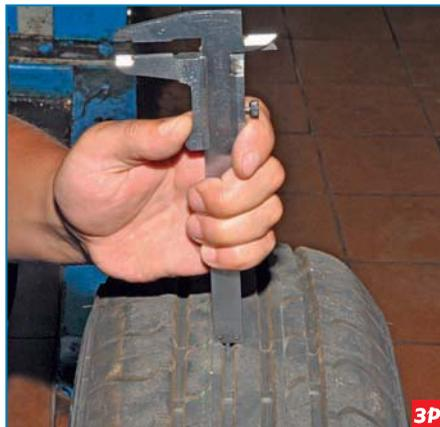
...опускаем в канавку в средней части протектора (как правило, в этой зоне протектор изнашивается быстрее) щуп глубиномера и удостоверяемся, что высота рисунка протектора более 1,6 мм.
