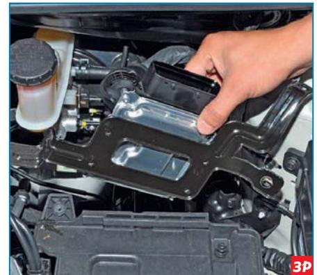
Снимаем электронный блок управления двигателем (см. «Снятие электронного блока управления двигателем», с. 82).
