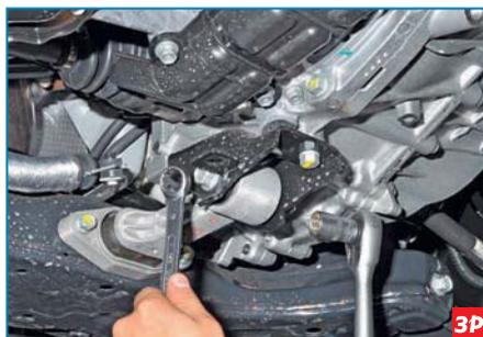
Головкой «на 17» отворачиваем гайку болта крепления опоры к кронштейну коробки передач, удерживая болт от проворачивания накидным ключом того же размера...
