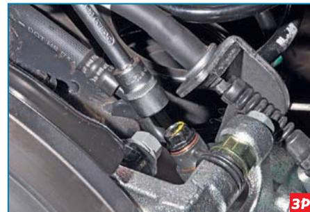
Головкой «на 12» отворачиваем болт-штуцер крепления наконечника задней части тормозного шланга к суппорту.
