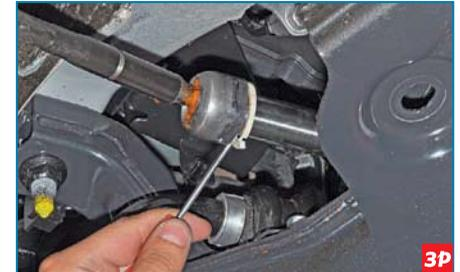
Отверткой разжимаем буфер рулевой тяги...
