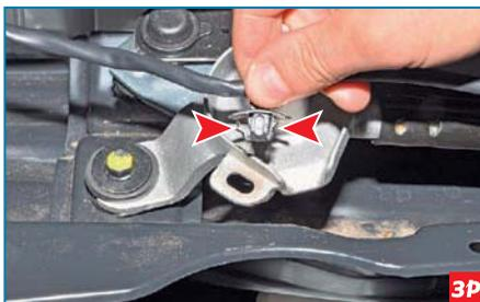
Сжав фиксаторы держателя жгута проводов обогрева зоны остановки щеток стеклоочистителя, снимаем его с правого кронштейна очистителя.
