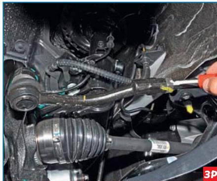
Перед отворачиванием наконечника краской помечаем его положение относительно рулевой тяги или при отворачивании подсчитываем число оборотов, на которые был завернут наконечник.
