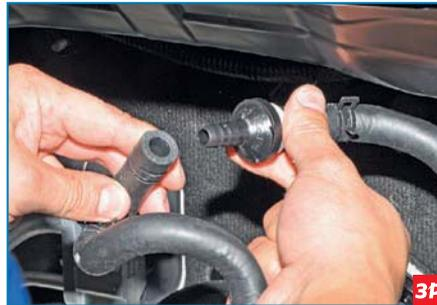
Снимаем шланг со штуцера обратного клапана.
