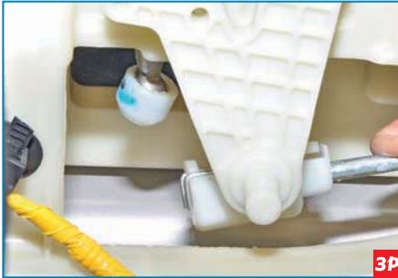
...и снимаем его с пластмассового вкладыша рычага переключения передач.
