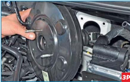
Выводим толкатель усилителя из отверстия щитка передка...
