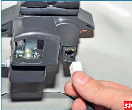
Отсоединяем колодку проводов от замка крышки багажника.
