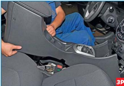
Снимаем облицовку туннеля пола, продев рамку с декоративным чехлом рычага переключения передач через отверстие в облицовке.
