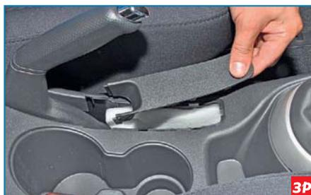
Преодолев сопротивление фиксаторов, снимаем декоративную накладку рычага стояночного тормоза.
