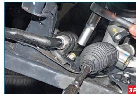
Головкой «на 14» отворачиваем по одному болту и по одной гайке крепления скоб стабилизатора с левой и правой сторон.
