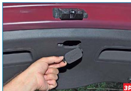
...и снимаем заглушку обивки.
