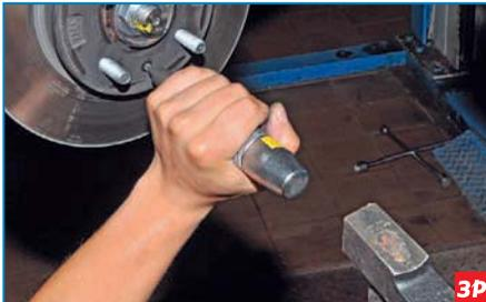
...отворачиваем их ударной отверткой.
