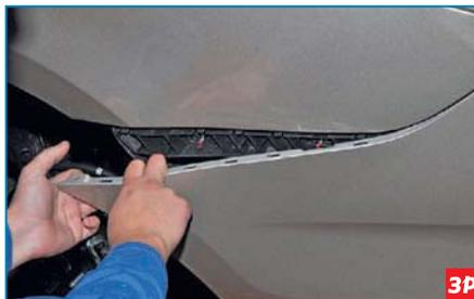
Потянув, отделяем левую боковину бампера от кузова, преодолевая сопротивление фиксаторов пластмассового держателя.
