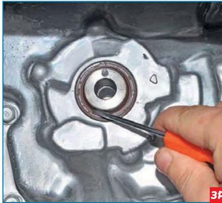
Поддев отверткой, вынимаем сальник из гнезда крышки привода ГРМ.
