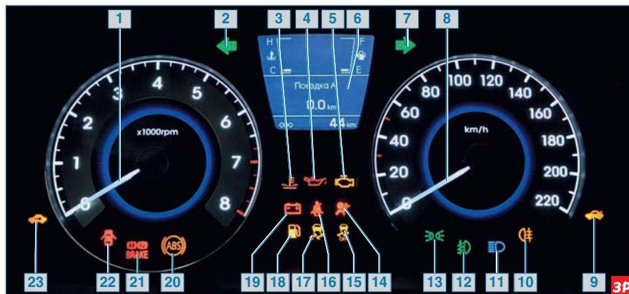
в системе смазки двигателя. В этом случае необходимо остановить двигатель и проверить уровень масла в поддоне картера двигателя. При уровне ниже минимального значения доливаем масло и снова пускаем двигатель. Если сигнализатор продолжает гореть, останавливаем двигатель. Определяем причину неисправности (см. «Диагностика неисправностей», с. 42) и устраняем ее. Если неисправность устранить не удалось, необходимо обратиться на СТО;
