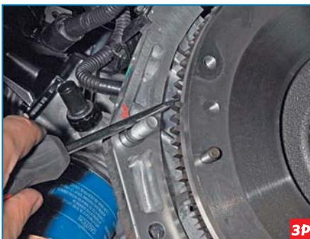
От проворачивания коленчатый вал удерживаем большой отверткой или монтажной лопаткой. Для этого вставляем ее между зубьями маховика и опираем на болт, установленный в отверстие поддона картера двигателя (для наглядности нажимной диск снят).
