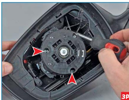
...крестообразной отверткой отворачиваем три самореза крепления блока к корпусу зеркала.
