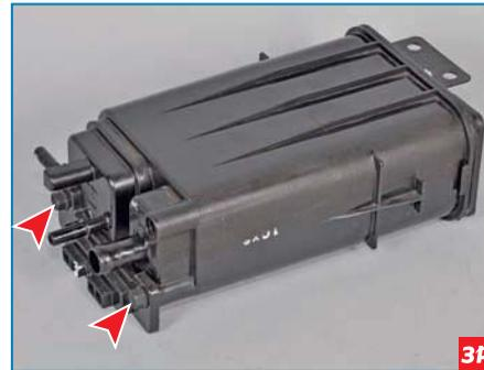
Аналогично демонтируем левый кронштейн, отвернув два болта его крепления к адсорберу.
