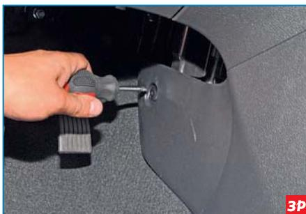
С левой стороны крестообразной отверткой отворачиваем фиксатор пистона бокового крепления облицовки туннеля пола...
