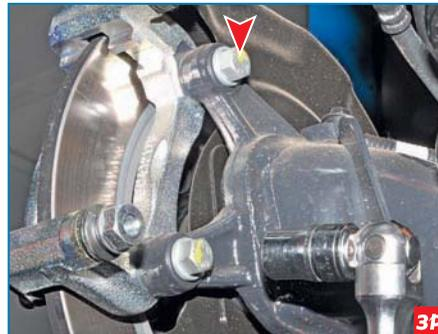
Головкой «на 14» отворачиваем два болта крепления направляющей колодок к фланцу рычага балки задней подвески...
