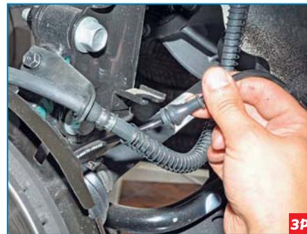
Выводим резиновую втулку жгута проводов из отверстия кронштейна амортизаторной стойки.
