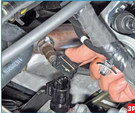
Нажав на пружинный фиксатор колодки переднего жгута проводов, отсоединяем колодку от разъема датчика скорости.
