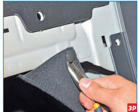
Пассатижами извлекаем пистон крепления коврового покрытия...
