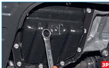
Накидным ключом «на 17» ослабляем затяжку пробки сливного отверстия.
