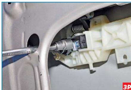
Вставив в отверстие внутренней панели двери головку «на 10» с удлинителем, отворачиваем болт крепления вкладыша наружной ручки...
