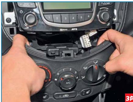
Потянув блок на себя, выводим из зацепления четыре фиксатора...
