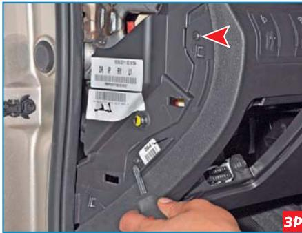
...крестообразной отверткой отворачиваем с левой стороны два самореза.
