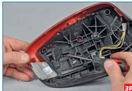
Шлицевой отверткой нажимаем на фиксатор верхней облицовки зеркала...
