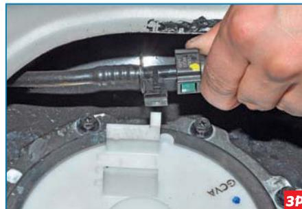
Выводим держатель трубки подвода паров топлива к электромагнитному клапану продувки адсорбера из отверстия в кронштейне крышки модуля.
