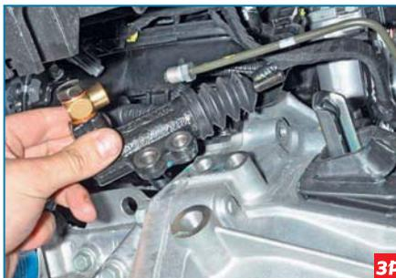
...и снимаем рабочий цилиндр.
