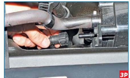
Нажав на фиксаторы наконечника трубки отвода паров топлива из адсорбера, отсоединяем наконечник от штуцера адсорбера.
