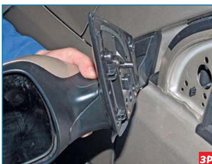
...и снимаем наружное зеркало. Устанавливаем наружное зеркало в обратной последовательности.
