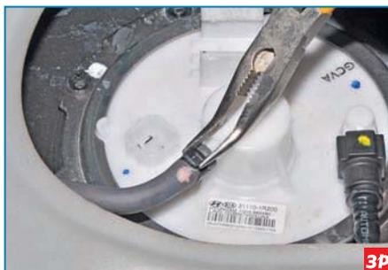
Сжав пассатижами концы хомута крепления шланга подвода паров топлива к адсорберу, сдвигаем хомут по шлангу...
