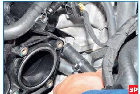
Аналогично отсоединяем шланг вентиляции картера от патрубка впускного трубопровода.
