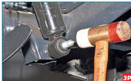
Молотком с пластмассовым наконечником выбиваем болт нижнего крепления амортизатора к рычагу...
