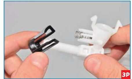
...и снимаем фиксатор клапана.
