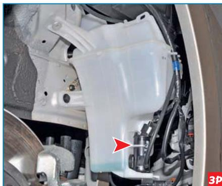
Насос расположен в пластмассовом фиксаторе на бачке омывателя.
