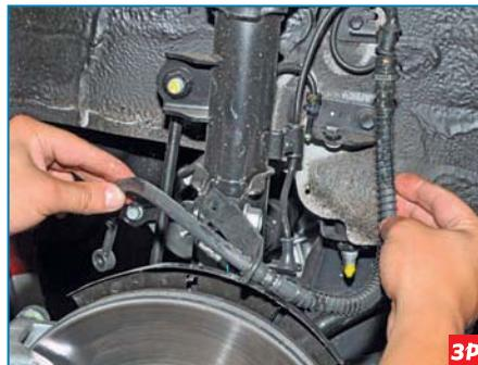
...и снимаем тормозной шланг вместе с держателем.
