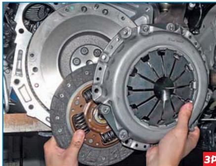
Снимаем нажимной и ведомый диски сцепления.
