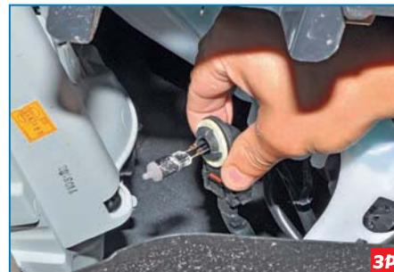
...и вынимаем лампу из корпуса фары.
