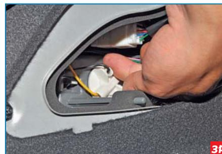
Поворачиваем против часовой стрелки патрон лампы указателя поворота.
