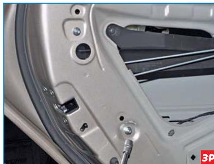
Головкой «на 10» отворачиваем две гайки крепления направляющей стекла...
