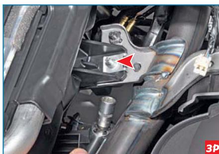
Головкой «на 10» отворачиваем болт крепления отопителя к панели приборов.
