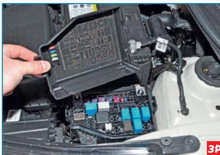
...снимаем крышку монтажного блока.
