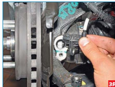
...и снимаем датчик.
