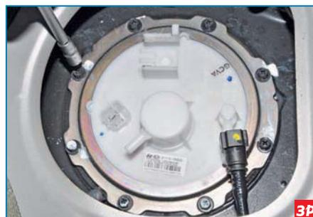
Головкой «на 8» отворачиваем восемь болтов крепления прижимной пластины крышки модуля...
