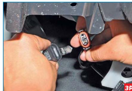
...и отсоединяем колодку от лампы.
