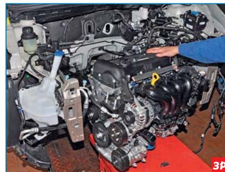
Придерживая силовой агрегат от падения, выкатываем его на тележке из моторного отсека.
