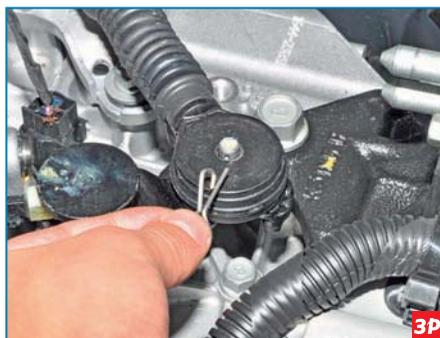
...и вынимаем его из отверстия оси рычага включения передач.
