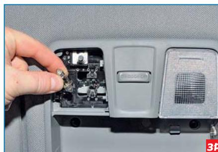
Вынимаем лампу из плафона.
