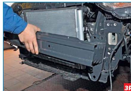
...и снимаем усилитель бампера.
