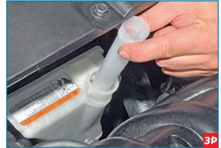
Вытягиваем заливную трубку из бачка... и, повернув ее против часовой стрелки, фиксируем трубку.
