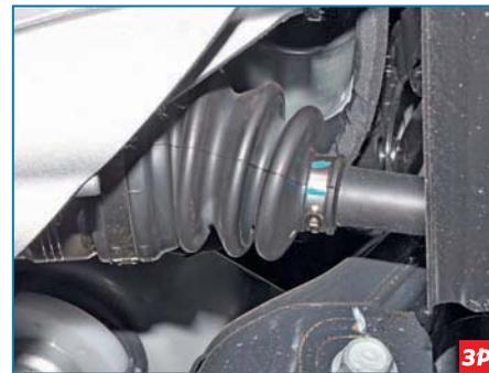
...и внутренних шарниров приводов передних колес, проверяем надежность их крепления хомутами.
