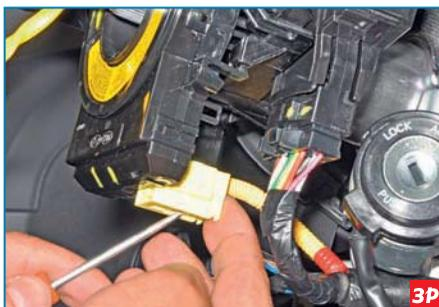
...отверткой нажимаем на фиксатор колодки...
