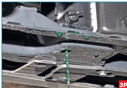
...и сливаем охлаждающую жидкость из радиатора в подставленную емкость. Чтобы ускорить слив жидкости нажимаем на крышку заливной горловины системы охлаждения и поворачиваем ее против часовой стрелки.
