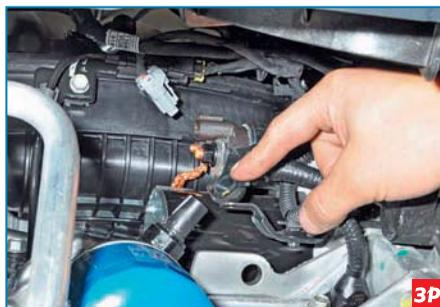
Снимаем резиновый защитный колпак с контактного болта тягового реле.
