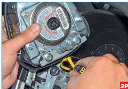
Снимаем подушку безопасности водителя (см. «Снятие подушки безопасности водителя», с. 231).
