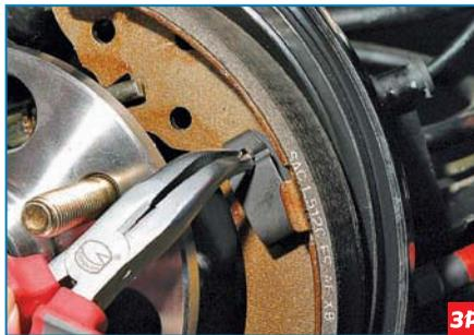
...пассатижами нажимаем на скобу и поворачиваем стойку за хвостовик до его совмещения с прорезью в скобе.
