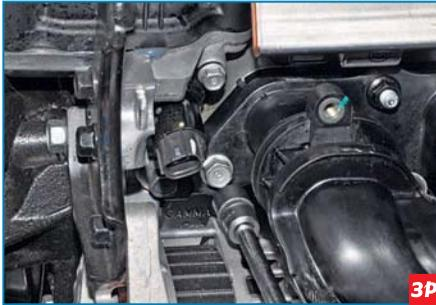
Головкой «на 12» отворачиваем три болта и две гайки шпилек крепления впускного трубопровода к головке блока цилиндров.
