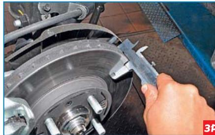
**Штангенциркулем измеряем толщину диска, которая должна быть не менее 20,0 мм. При этом в разных частях диска она не должна отличаться более чем на 0,1 мм.**
