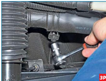
Головкой «на 10» ослабляем затяжку хомута крепления шланга топливного бака...
