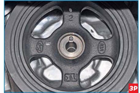
...совпадение его паза со штифтом носка коленчатого вала.
