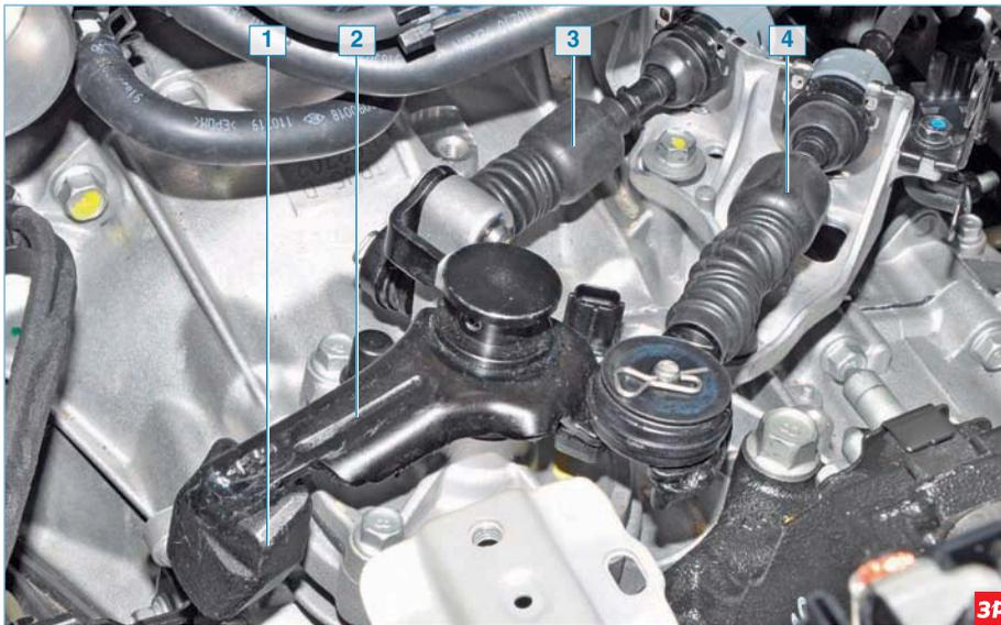
**Механизма переключения коробки передач:** 1 – инерционный груз; 2 – рычаг переключения передач; 3 – трос выбора передач; 4 – трос включения передач
