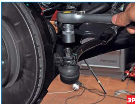
Головкой или ключом «на 17» отворачиваем гайку крепления пальца шарнира наконечника к рычагу поворотного кулака.
