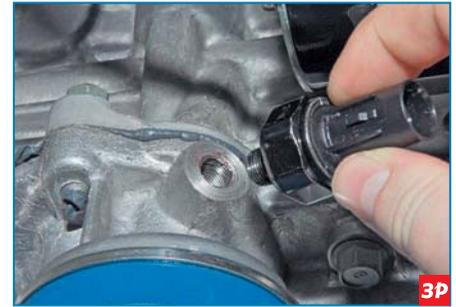
...и снимаем датчик.
