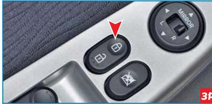
Для блокировки замков всех боковых дверей, крышки багажника или двери багажного отделения (автомобиль с кузовом хэтчбек) изнутри автомобиля следует нажать на переднюю часть клавиши блокировки центрального замка, а чтобы разблокировать – на заднюю
