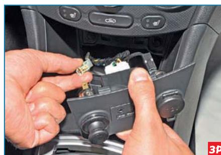
Нажав на фиксатор, снимаем колодку проводов с выводов прикуривателя.
