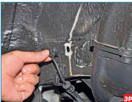
Вынимаем держатель жгута проводов датчика из отверстия кузова в арке колеса.
