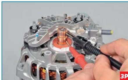
...подсоединяем щупы тестера (в режиме омметра) к контактным кольцам. Если тестер покажет бесконечность, значит, в обмотке есть обрыв и ротор необходимо заменить.
