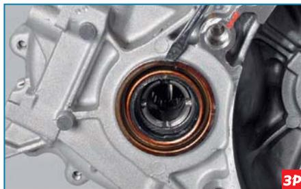
Вставляем отвертку в зазор между картером и отбортовкой наружной обоймы.
