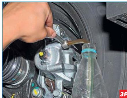
Прокачиваем, как описано выше, тормозной механизм левого переднего колеса, отворачивая штуцер прокачки ключом того же размера.
