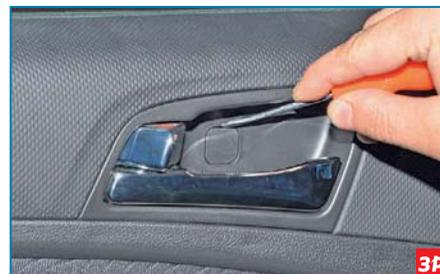
Поддеваем отверткой заглушку в декоративной накладке внутренней ручки двери...
