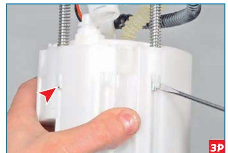
Отжав шлицевой отверткой на корпусе стакана фиксаторы двух направляющих стержней крышки топливного модуля...
