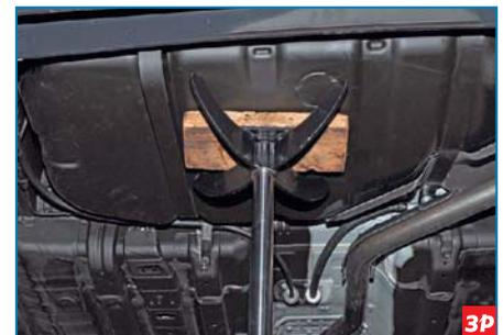
Приспускаем бак на упоре так, чтобы были доступны болты крепления адсорбера.
