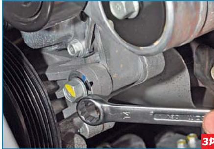
Тем же ключом отворачиваем нижний болт крепления насоса...
