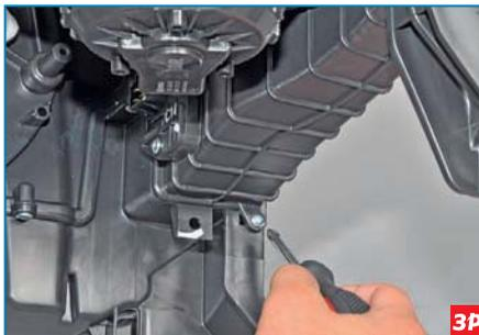
Этим же инструментом отворачиваем саморез нижнего крепления корпуса вентилятора к корпусу отопителя.
