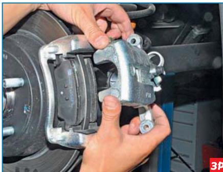
Снимаем суппорт с направляющей колодок и осторожно опускаем его, стараясь не повредить тормозной шланг и трос стояночного тормоза.
