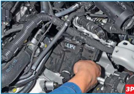
Снимаем теплозащитный экран внутреннего шарнира привода правого колеса. Снизу автомобиля...
