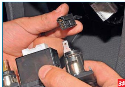
Нажав на фиксатор, снимаем колодку проводов с выводов электрической розетки.
