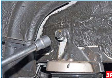
Головкой «на 19» отворачиваем болт верхнего крепления амортизатора к кузову автомобиля.
