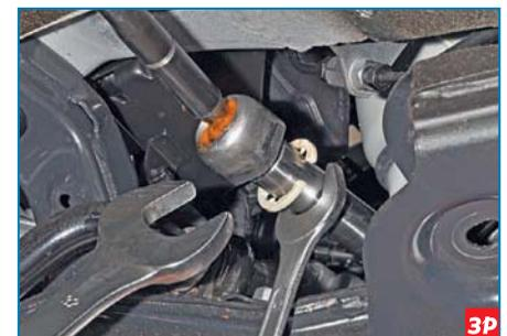
Удерживая ключом «на 21» рейку рулевого механизма за место, где зубья только начинаются, выворачиваем ключом «на 32» резьбовой наконечник шарнира рулевой тяги из рейки...
