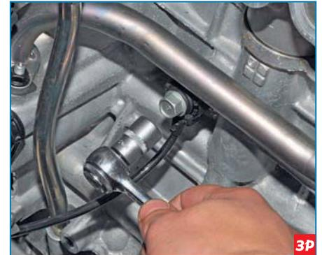
Головкой «на 12» отворачиваем болт крепления датчика к блоку цилиндров...
