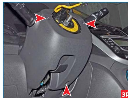
Расположение саморезов крепления нижнего кожуха рулевой колонки (рулевое колесо для наглядности снято).
