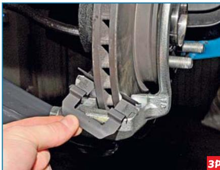
...снимаем нижнюю направляющую пластину.
