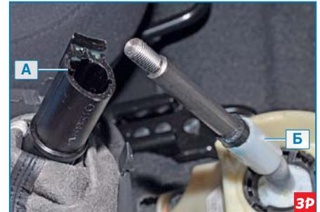
Направляющие пазы А блокиратора и направляющие выступы Б рычага переключения передач.
