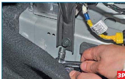
...и отогнув ковровое покрытие с левой стороны туннеля, головкой «на 10» отворачиваем болт крепления кронштейна панели приборов к туннелю пола.
