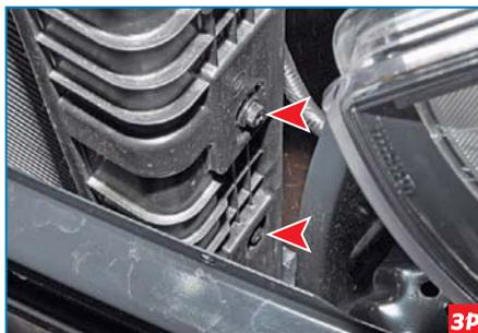
Аналогично отворачиваем два болта крепления левого направляющего кожуха к кронштейну бачка радиатора...
