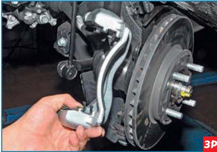
...и снимаем направляющую колодок.
