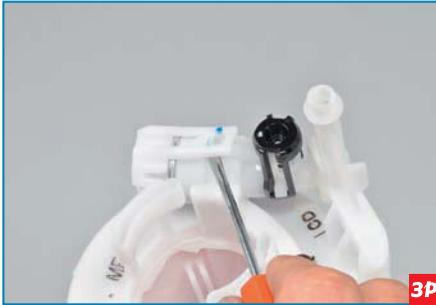
Поддев шлицевой отверткой два ушка фиксатора регулятора давления топлива и трубки слива топлива...
