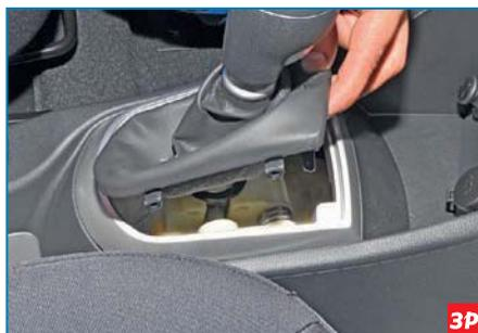
Преодолев сопротивление фиксаторов, вынимаем из отверстия облицовки туннеля пола рамку крепления декоративного чехла рычага переключения передач.
