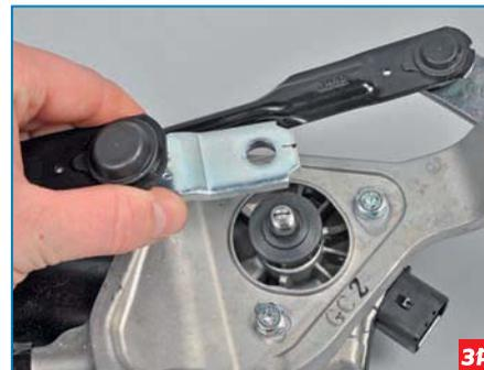
...снимаем кривошип с вала мотор-редуктора.
