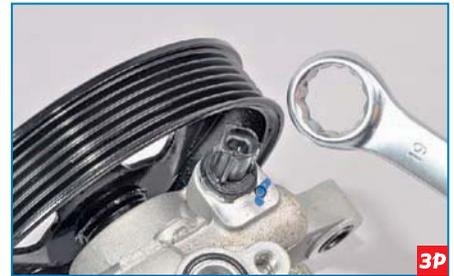
Накидным ключом «на 19» отворачиваем датчик давления...
