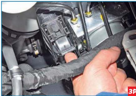
Приподняв фиксатор колодки жгута проводов...
