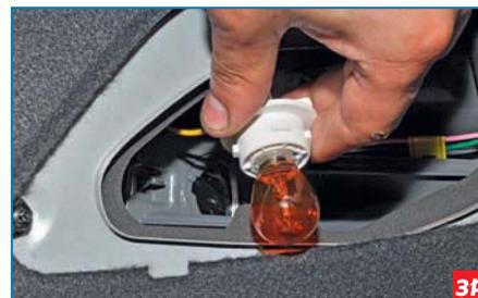
Вынимаем патрон с лампой из корпуса фонаря.
