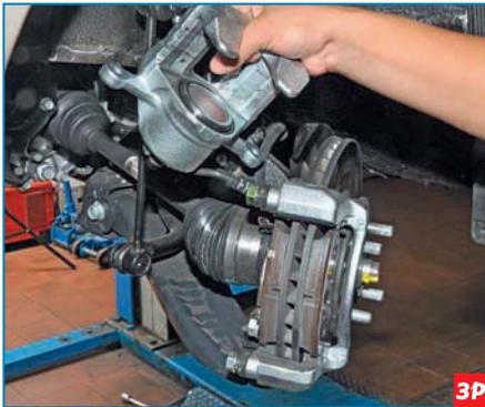
Снимаем суппорт с направляющей колодок (не отсоединяя от суппорта тормозной шланг)...
