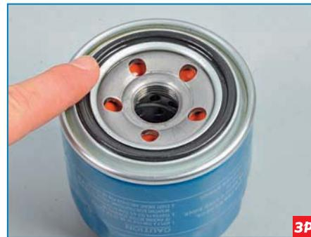
Наносим моторное масло на уплотнительное кольцо фильтра.
