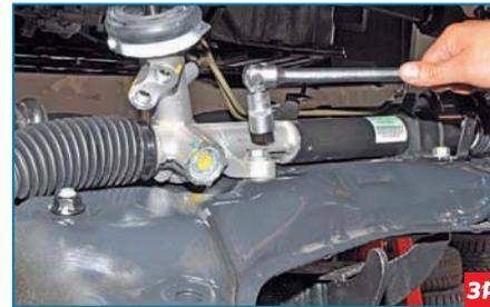
Головкой «на 17» отворачиваем два болта крепления картера рулевого механизма и два болта крепления опоры гидроцилиндра к подрамнику передней подвески.
