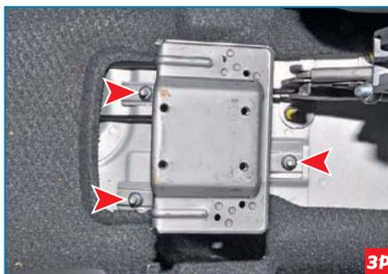
Расположение гаек крепления, поддерживающего кронштейна облицовки туннеля пола.
