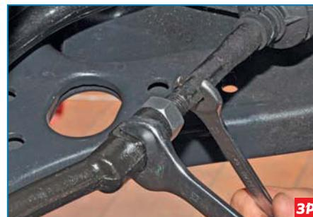
Ключом «на 19» отворачиваем наконечник, удерживая рулевую тягу от проворачивания за шестигранник ключом «на 13».
