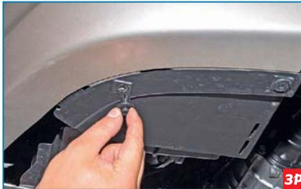
Также вынимаем два пистона нижнего переднего крепления подкрылка к переднему бамперу...
