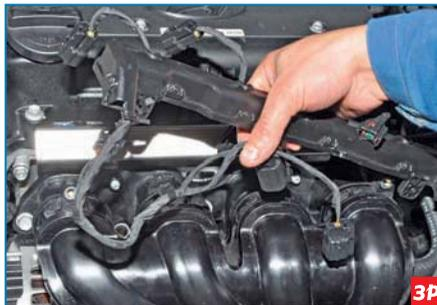
...и отводим кожух со жгутом проводов от впускного трубопровода.
