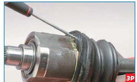
Отверткой с тонким лезвием отводим чехол от корпуса, чтобы уравнять давление воздуха внутри и снаружи чехла.
