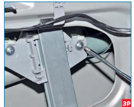
Крестообразной отверткой отворачиваем саморезы крепления двух держателей стекла к ползуну электростеклоподъемника.
