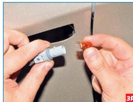
Потянув лампу за колбу, вынимаем ее из контактных зажимов патрона. Устанавливаем новую лампу WY5W в обратной последовательности.
