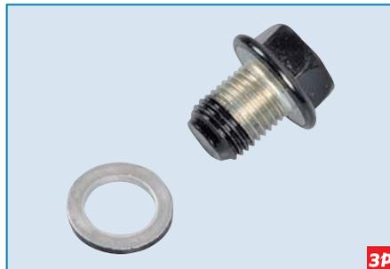
Проверяем состояние уплотнительной алюминиевой шайбы пробки.
