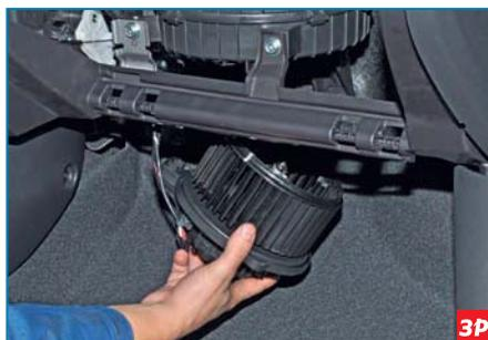
...и снимаем вентилятор отопителя.
