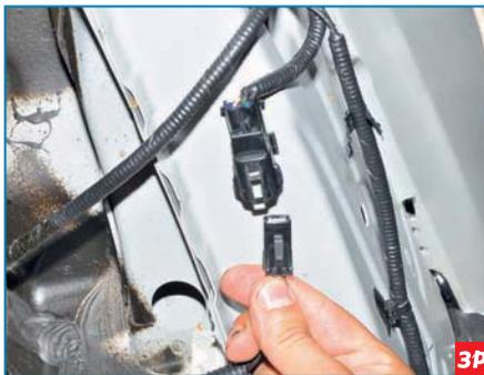
...и отсоединяем колодку жгута проводов от разъема жгута проводов датчика.
