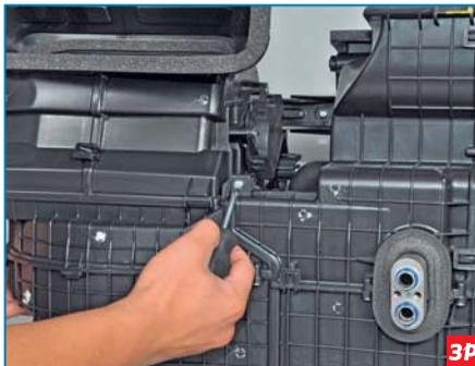
...и центрального нижнего крепления корпуса вентилятора к корпусу отопителя.
