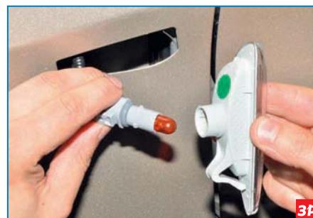
Повернув патрон лампы против часовой стрелки, вынимаем его из корпуса указателя.
