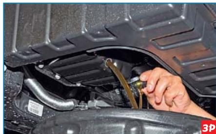
Отвернув пробку вручную, сливаем масло.
