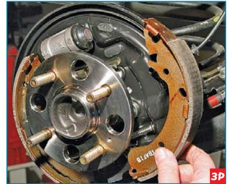
Снимаем переднюю тормозную колодку.
