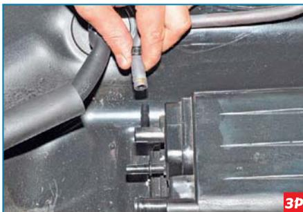
...и снимаем шланг со штуцера адсорбера.
