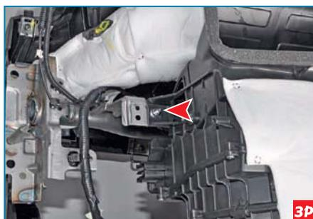
Этим же инструментом отворачиваем гайку крепления корпуса вентилятора к панели приборов.
