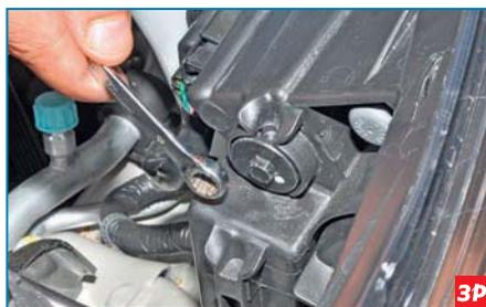
Поворачивать регуляторы можно также ключом «на 8».
