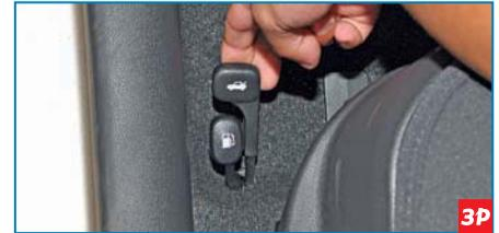
Изнутри автомобиля багажник можно открыть, приподняв рычаг, расположенный на полу слева от водительского сиденья
