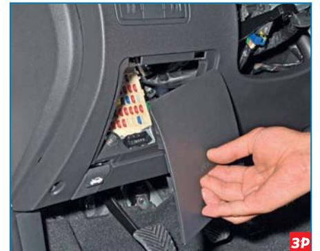
В салоне автомобиля снимаем крышку монтажного блока реле и предохранителей.
