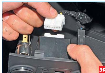
Нажав на фиксатор, отсоединяем колодку жгута проводов от входов головного устройства системы звуковоспроизведения.
