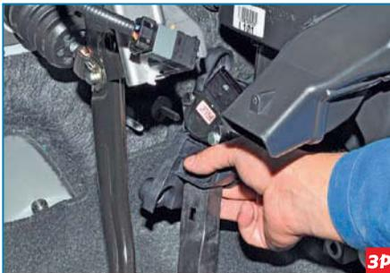
...и снимаем педаль «газа» в сборе с датчиком.
