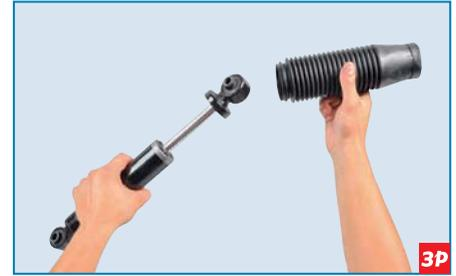
Снимаем чехол через верхнюю часть амортизатора.
