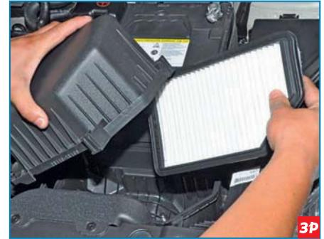
...и вынимаем сменный элемент из корпуса воздушного фильтра.
