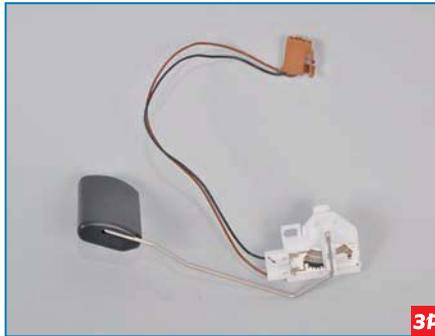
...и снимаем датчик с проводами. Нажав фиксатор колодки проводов топливного насоса...
