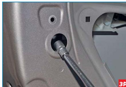
Вставив в отверстие головку «на 10» с удлинителем, отворачиваем болт крепления вкладыша наружной ручки...
