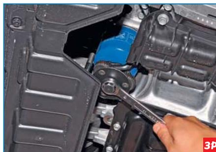
...ослабляем затяжку фильтра съемником.
