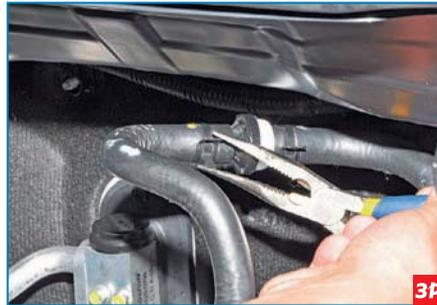
Пассатижами сжимаем концы хомута крепления шланга подвода разрежения к обратному клапану со стороны впускного трубопровода и сдвигаем хомут по шлангу.
