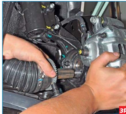
Отводим поворотный кулак с амортизаторной стойкой наружу и выводим шлицевой хвостовик корпуса наружного шарнира из ступицы колеса.
