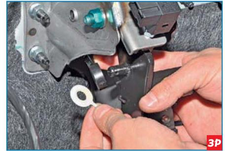
Снимаем с пальца педали пластмассовую шайбу и толкатель главного цилиндра сцепления.
