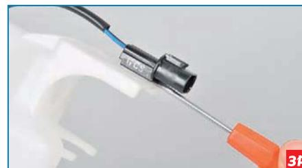
...шлицевой отверткой нажимаем на фиксатор крепления разъема датчика к кронштейну...
