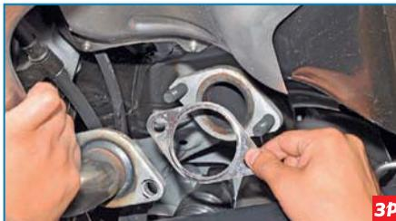
Снимаем со шпилек фланца трубы основного глушителя уплотнительную прокладку.
