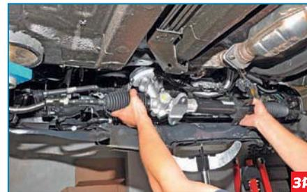
Снимаем рулевой механизм с подрамника.
