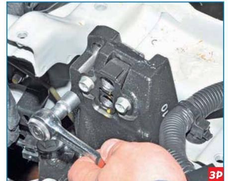
...головкой «на 10» отворачиваем два болта крепления к кронштейну стопорной пластины гаек.
