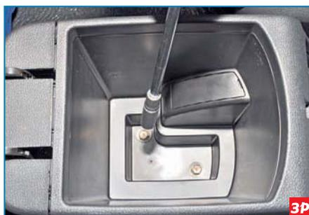
Головкой «на 10» отворачиваем два болта заднего крепления облицовки туннеля пола к кронштейну.
