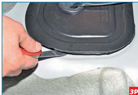
Ножом подрезаем герметик по периметру крышки лючка топливного модуля...
