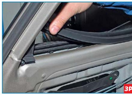
Снимаем внутренний уплотнитель стекла.
