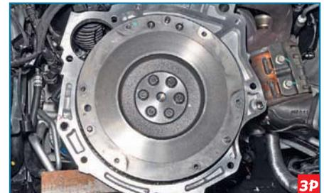
Снимаем «корзину» и ведомый диск сцепления (см. «Замена «корзины» и ведомого диска сцепления», с. 124).
