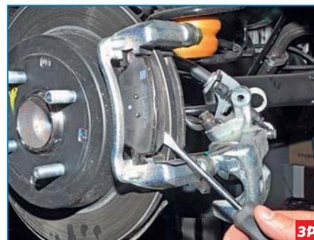
Отверткой сдвигаем наружную тормозную колодку по направляющим пластинам...
