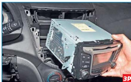
Снимаем головное устройство системы звуковоспроизведения. Установку выполняем в обратной последовательности.
