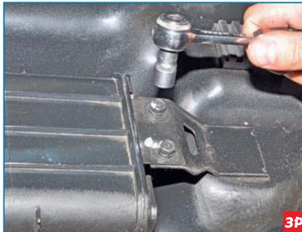
Головкой «на 10» отворачиваем два болта крепления правого кронштейна адсорбера к кронштейну топливного бака...
