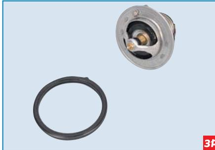
Снимаем резиновую прокладку с фланца термостата.
