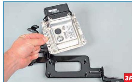
...и снимаем блок управления. Устанавливаем электронный блок управления двигателем в обратной последовательности.
