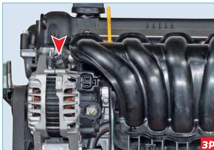
Электромагнитный клапан системы изменения фаз установлен в гнезде головки блока цилиндров
