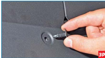
...извлекаем два пистона верхнего крепления левой вертикальной обивки задней полки.
