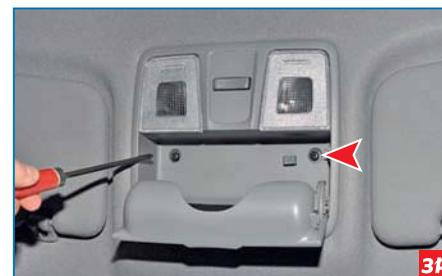
...крестообразной отверткой отворачиваем два самореза его крепления к кузову.
