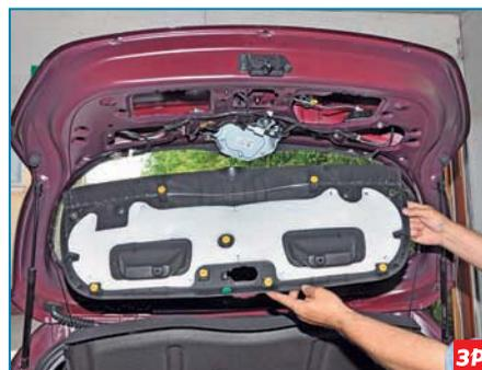
...снимаем обивку двери багажного отделения.
