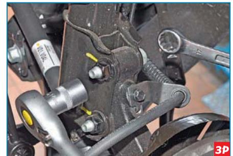
Головкой «на 17» отворачиваем две гайки крепления корпуса стойки к поворотному кулаку, удерживая от проворачивания болт ключом «на 17».
