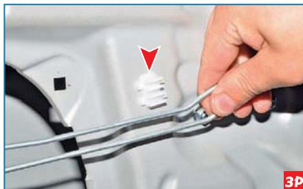
Извлекаем обе тяги внутренней ручки из пластмассовой направляющей.
