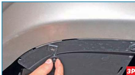
Вынимаем по два пистона крепления левого и правого подкрылков к переднему бамперу (см. «Снятие брызговиков и подкрылков передних колес», с. 234).
