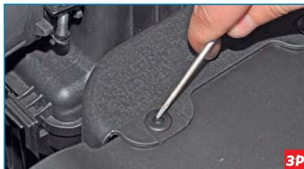
...острым инструментом или тонкой отверткой проталкиваем внутрь фиксаторы двух пистонов крепления воздухозаборника воздушного фильтра к накладке облицовки радиатора...
