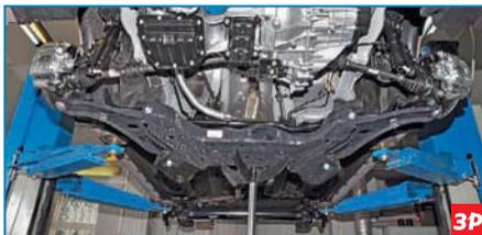
Снизу автомобиля устанавливаем регулируемый упор под подрамник передней подвески.
