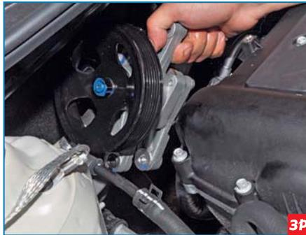
...и вынимаем насос из моторного отсека.
