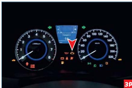
**Сигнализатор неисправности системы управления двигателем в комбинации приборов**
