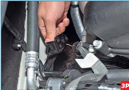
Отводим фланец трубки наливной магистрали от насоса.
