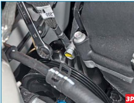
Накидным ключом «на 14» отворачиваем верхний болт крепления насоса к приливу головки блока цилиндров.
