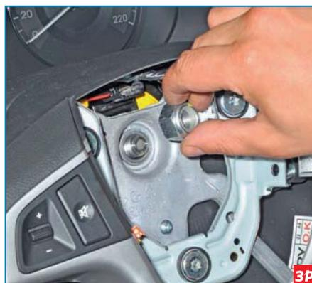
Полностью отворачиваем гайку крепления рулевого колеса.
