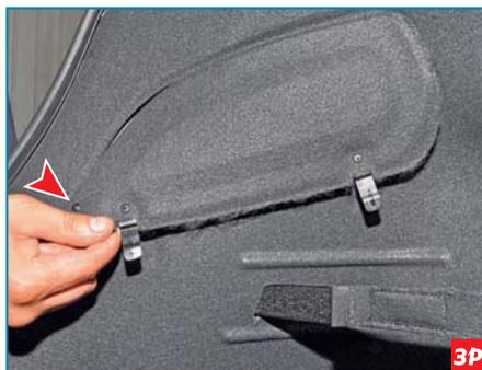
...и преодолевая сопротивление двух фиксаторов, тянем на себя клапан обивки багажника.
