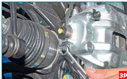
Ключом «на 12» отворачиваем болт-штуцер крепления наконечника тормозного шланга к суппорту.
