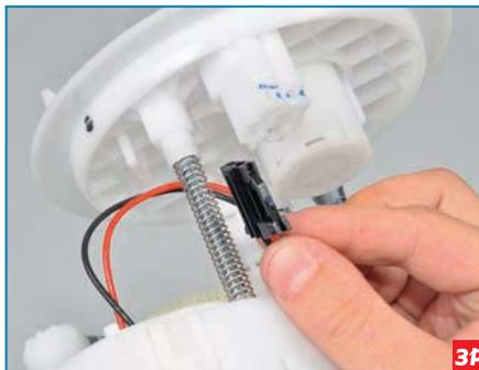
...отсоединяем колодку от разъема крышки топливного модуля.
