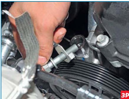
Снимаем с болта наконечник провода «массы».
