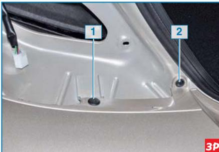
Под задними фонарями бампер крепится pistоном 1 и саморезом 2.
