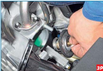
Вынимаем термостат из гнезда блока цилиндров.
