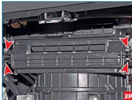
Сжимаем фиксаторы крышки фильтра...
