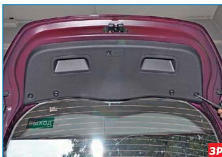
Открываем дверь багажного отделения и крестообразной отверткой отворачиваем два самореза крепления обивки.
