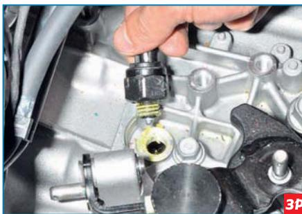
...и вынимаем его из отверстия картера коробки передач.
