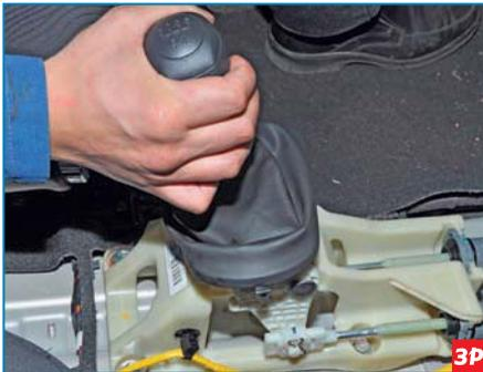
Вращаем рукоятку рычага вместе с рамкой и декоративным чехлом против часовой стрелки.
