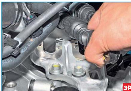
Аналогично вынимаем из кронштейна коробки передач трос выбора передач.
