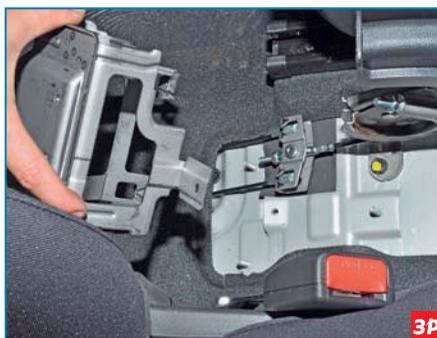
...и снимаем его.
