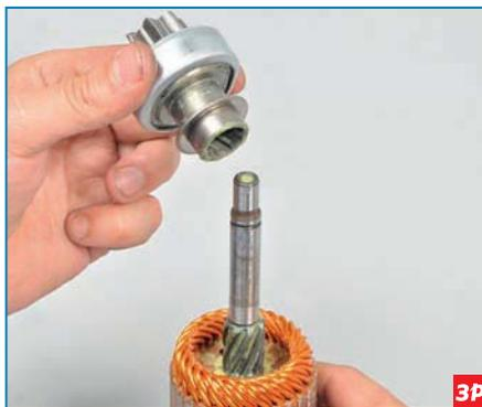
Снимаем привод в сборе.
