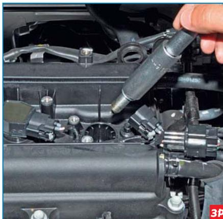
...и вынимаем ее из свечного колодца. При установке свечи необходимо наживлять и вворачивать, вращая удлинитель рукой, без воротка, во избежание повреждения резьбы свечного отверстия в головке блока цилиндров. Если свеча пошла не по резьбе, будет ощущаться сильное сопротивление вращению. В этом случае необходимо полностью вывернуть свечу и, очистив резьбу, повторно завернуть. Окончательно затягиваем свечу требуемым моментом.
