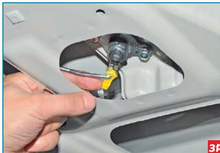
Отжав пластмассовый фиксатор тяги цилиндрического механизма замка и, повернув его вокруг оси...
