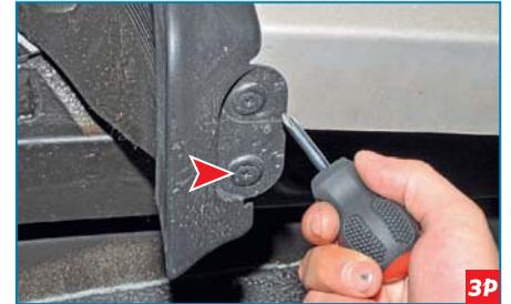
...крестообразной отверткой выворачиваем фиксаторы двух пистонов нижнего крепления брызговика к заднему бамперу...
