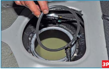
Вынимаем резиновое уплотнительное кольцо герметизирующее соединение крышки модуля и фланца отверстия бака.
