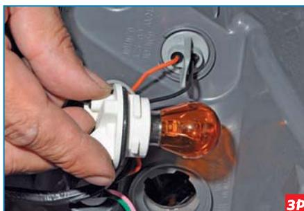
Вынимаем патрон с лампой из корпуса фонаря.
