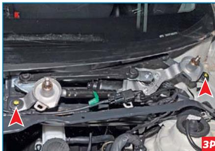
Головкой «на 10» отворачиваем два болта крепления очистителя...
