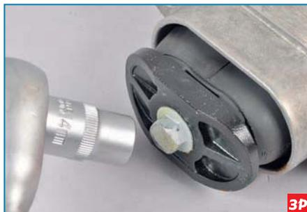
...головкой «на 14» отворачиваем стягивающий болт опоры и разбираем ее.
