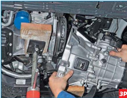
Снимаем коробку передач (см. «Снятие коробки передач», с. 134).
