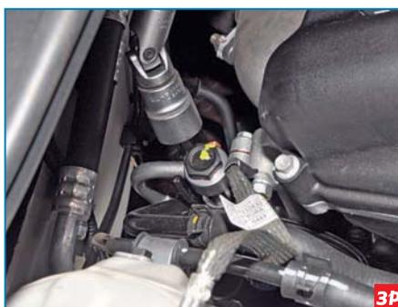
Головкой «на 24» отворачиваем болт-штуцер крепления наконечника трубки нагнетательной магистрали...
