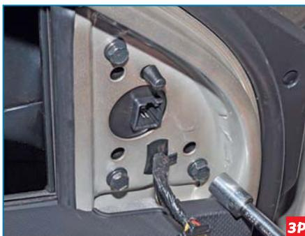
Головкой «на 10» отворачиваем три болта крепления кронштейна наружного зеркала к двери...
