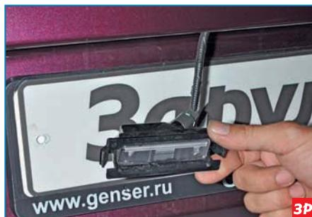
...вынимаем фонарь из гнезда в накладке и вытягиваем провода на длину, удобную для замены лампы.
