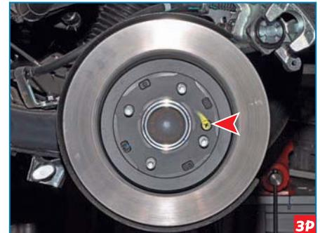
Металлической щеткой очищаем от грязи и коррозии головку винта крепления диска к ступице заднего колеса.
