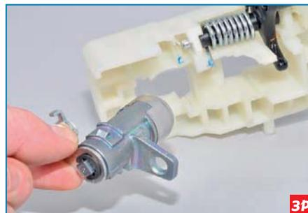
...и вынимаем цилиндрический механизм замка из основания ручки.
