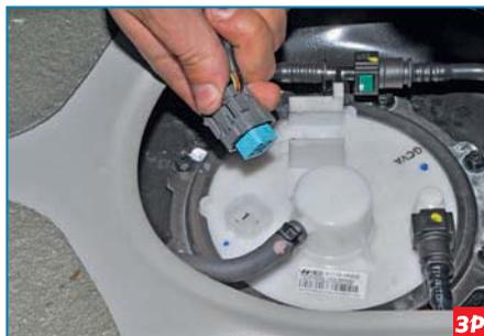
...и отсоединяем колодку от разъема крышки топливного модуля.
