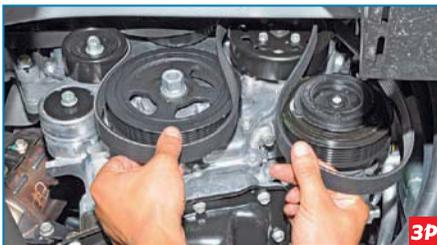
Снимаем ремень привода вспомогательных агрегатов (см. «Проверка и за-
