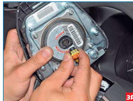
Отсоединяем колодку проводов от разъема подушки.
