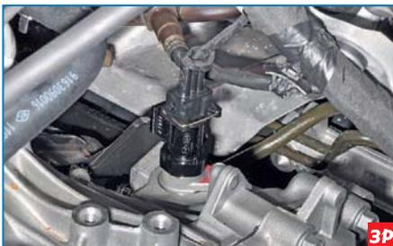
Расположение датчика скорости автомобиля на коробке передач.
