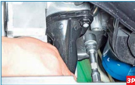
Головкой «на 12» отворачиваем два болта крепления крышки термостата к блоку цилиндров...
