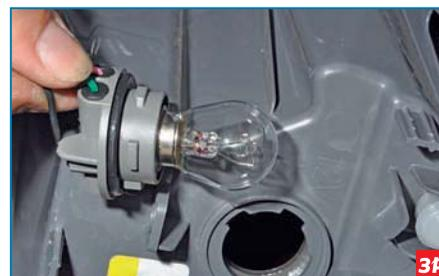
Вынимаем патрон с лампой из корпуса фонаря.
