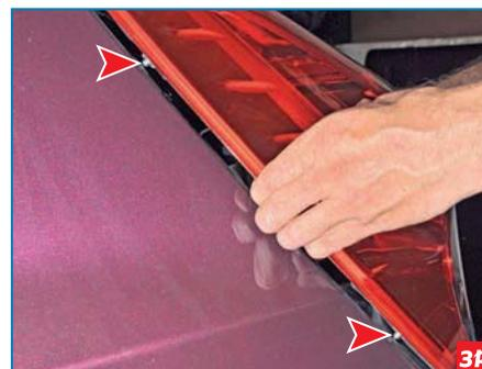
Потянув на себя корпус фонаря и выводим два фиксатора из отверстия в кузове.
