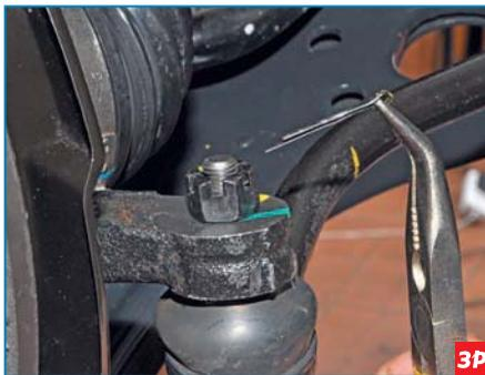
Пассатижами вынимаем шплинт из отверстия пальца шарнира.
