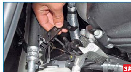
Поднимаем кронштейн насколько позволяет длина провода датчика...
