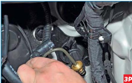
...и снимаем шланг со штуцера главного цилиндра сцепления.
