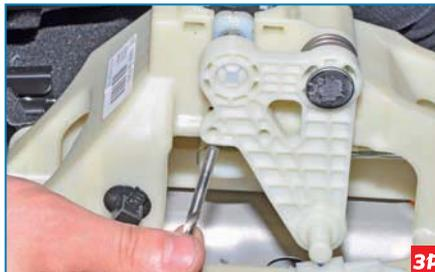
...вставив в отверстия рычага и основания механизма управления сверло диаметром 5 мм.
