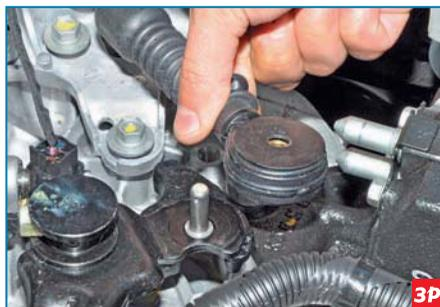
Снимаем наконечник троса включения передач с оси рычага.
