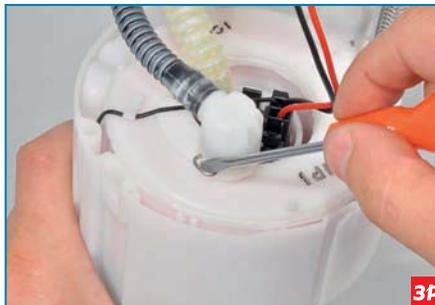
Поддев отверткой пружинный фиксатор наконечника трубки подвода топлива от фильтра к крышке модуля...
