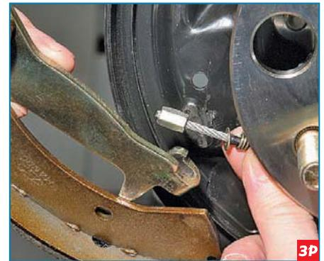
...и отсоединяем наконечник троса от рычага привода стояночного тормоза. Перед установкой колодок необходимо уменьшить длину распорной планки, завернув храповик до упора. Устанавливаем новые колодки в обратной последовательности. Для удобства установки скобы опорной стойки колодки сжимаем ее пассатижами...
