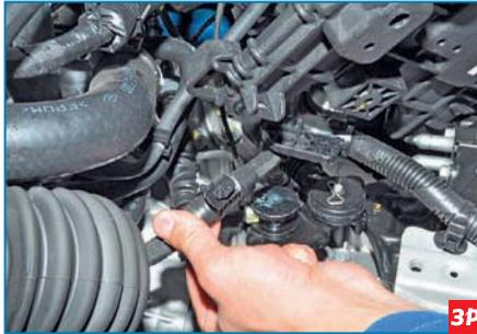
Вынимаем держатель проводов из отверстия площадки, снимаем ее. Перед снятием блока ABS помечаем расположение на нем тормозных трубок.
