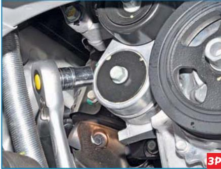
...головкой «на 17» отворачиваем болт крепления натяжного устройства.
