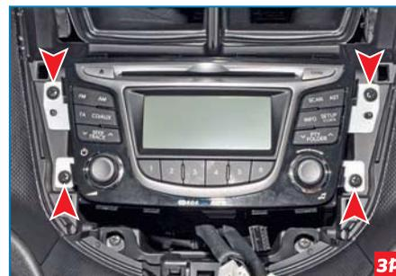
Крестообразной отверткой отворачиваем четыре самореза крепления головного устройства...
