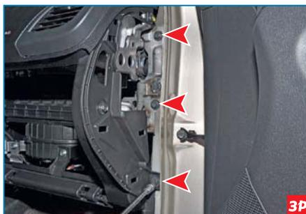
С правой стороны головкой «на 10» отворачиваем три болта крепления панели приборов к кузову.
