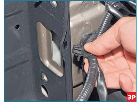
Выводим держатель переднего жгута проводов из отверстия рамки радиатора.
