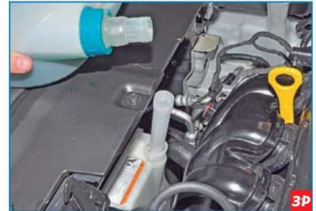
Долivаем в бачок охлаждающую жидкость, немного не доводя уровень до метки F.
