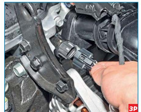
...электромагнитного клапана системы регулирования фаз двигателя...
