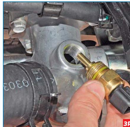
...и снимаем датчик.
