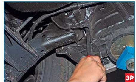
**...вставляем монтажную лопатку между проушиной рычага и кронштейном его крепления и пытаемся сдвинуть рычаг в разных направлениях.**
