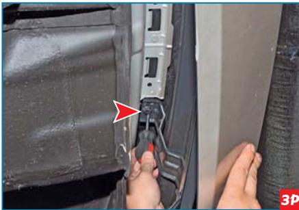
Аналогично вынимаем pistоны верхнего крепления бампера к двум кронштейнам усилителя.
