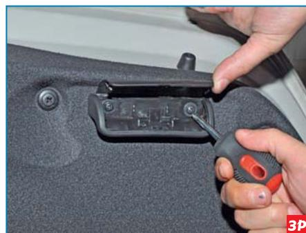
Крестообразной отверткой отворачиваем два самореза крепления ручки...
