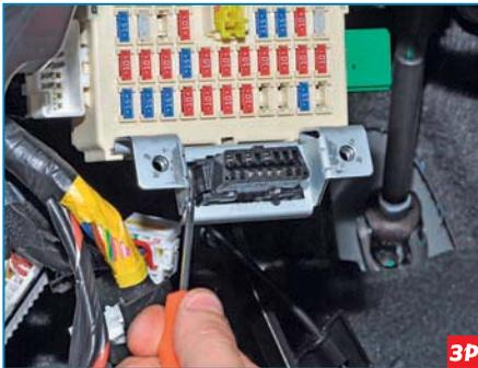
Нажав отверткой на фиксатор с одной стороны диагностического разъема...
