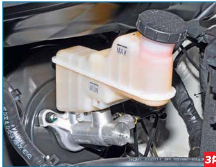
На бачке выполнены метки MIN и MAX, между которыми должен находиться уровень рабочей жидкости.
