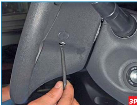
Ключом Torx T-30 отворачиваем винт крепления подушки к рулевому колесу. Аналогично отворачиваем винт с другой стороны рулевого колеса.
