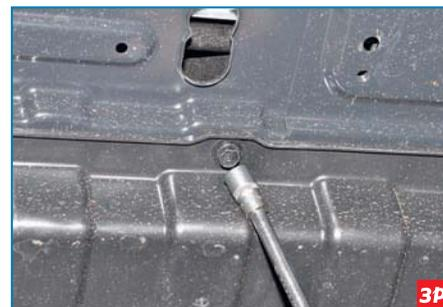
Тем же инструментом отворачиваем два болта крепления левого щитка к рамке радиатора...
