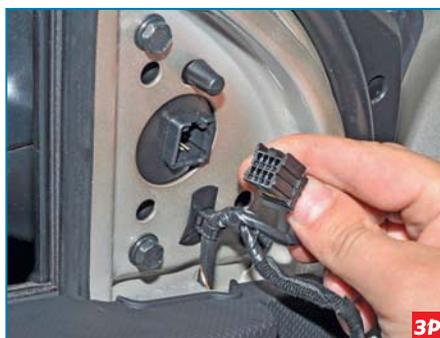
Отсоединяем колодку жгута проводов от наружного зеркала.
