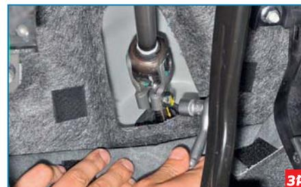
Головкой «на 12» отворачиваем болт крепления нижнего карданного шарнира промежуточного вала к валу приводной шестерни рулевого механизма. Вынимаем болт.
