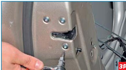
Ключом Torx T-30 отворачиваем три винта крепления замка к торцу двери...
