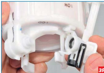
Отсоединяем от корпуса топливного фильтра трубку слива топлива.
