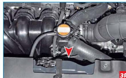
Номер двигателя нанесен на приливе передней стенки блока цилиндров под заливной горловиной.
