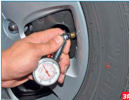
...и подсоединяем к вентилю шинный манометр или насос с манометром.
