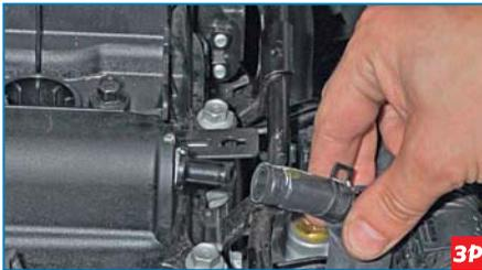
...снимаем шланг со штуцера клапана системы вентиляции картера.
