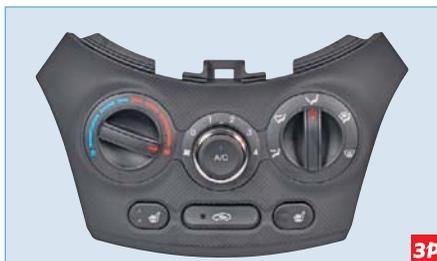
**Блок управления отоплением, вентиляцией и кондиционированием воздуха**
