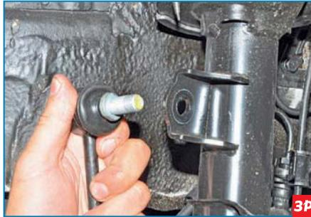
Выводим палец верхнего шарового шарнира стойки стабилизатора из отверстия кронштейна амортизаторной стойки.
