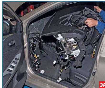
Отводим панель приборов от щитка передка и вынимаем ее из салона автомобиля через проем водительской двери.
