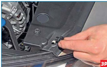
Крестообразной отверткой выворачиваем с каждой стороны по одному фиксатору пистона крепления накладки облицовки радиатора и вынимаем их.
