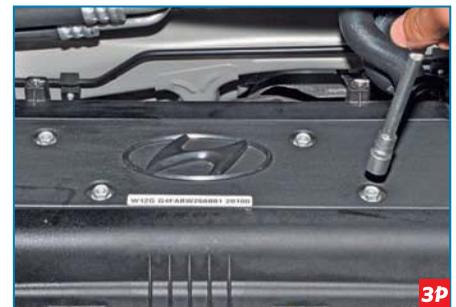
Головкой «на 10» отворачиваем четыре болта...
