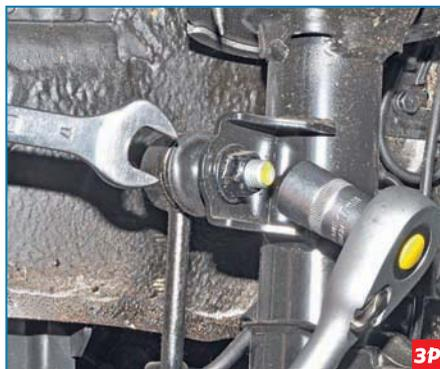
Головкой «на 17» отворачиваем гайку крепления пальца верхнего шарового шарнира стойки к кронштейну амортизаторной стойки, удерживая палец от проворачивания ключом «на 17».
