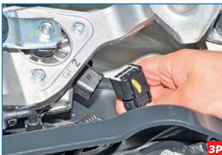
Нажав на фиксатор колодки проводов, отсоединяем ее от разъема мотор-редуктора.
