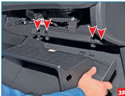
Выводим петли вещевого ящика из четырех отверстий в панели приборов и снимаем его.
