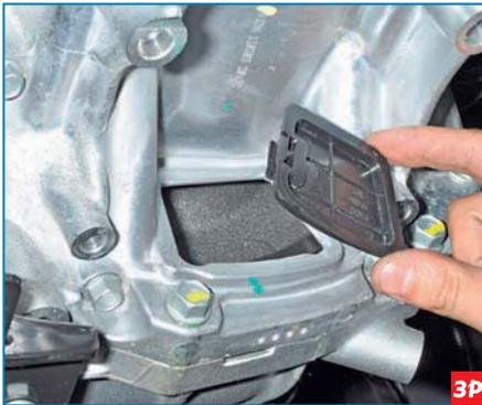
...и снимаем пластмассовую заглушку поддона картера.
