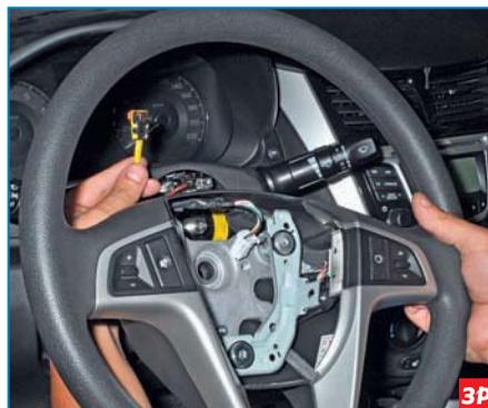
Снимаем рулевое колесо с вала, выведя колодки с проводами через отверстие в ступице колеса.
