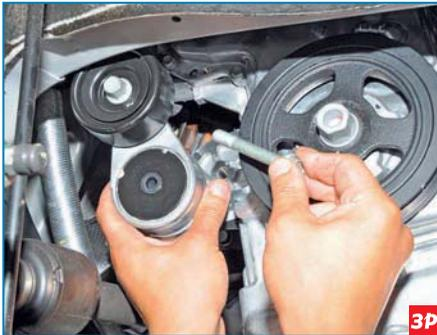
Вынимаем болт и снимаем натяжное устройство.
