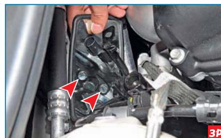
Два болта крепления кронштейна колодки датчика давления и фланца трубки наливной магистрали (обратите внимание – на фото болты показаны с помощью зеркала).
