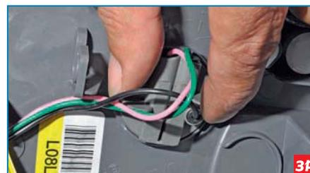
Поворачиваем против часовой стрелки патрон комбинированной лампы сигнала торможения и габаритного света.
