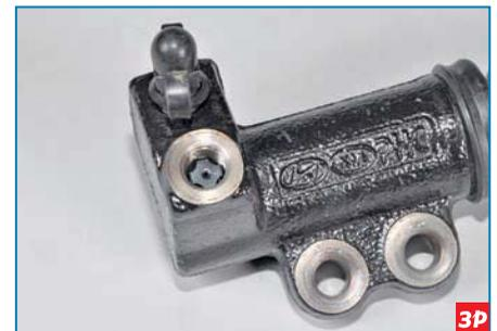
В резьбовом отверстии рабочего цилиндра установлен дроссельный клапан.
