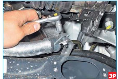
Отсоединяем от подрамника напорный шланг гидроусилителя рулевого управления спереди, отвернув болт головкой «на 10» от кронштейна...
