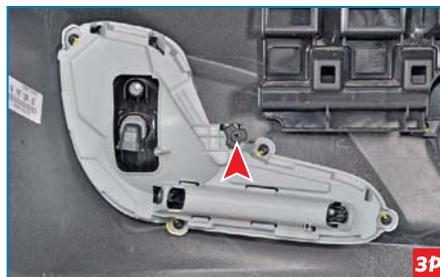
Поворачивая рукой или крестообразной отверткой регулятор, изменяем положение светового пучка в вертикальной плоскости (для наглядности показано на снятом бампере).
