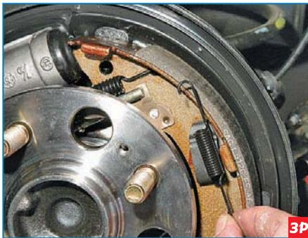
...и снимаем пружину.
