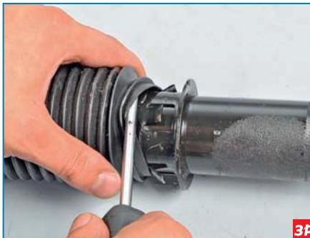
...снимаем его с металлических фиксаторов.
