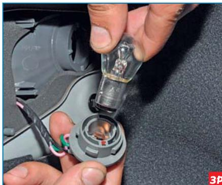
Слегка нажимая на колбу лампы, утапливаем ее в патрон, поворачиваем против часовой стрелки и вынимаем из патрона.
