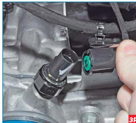
Нажав на фиксатор колодки переднего жгута проводов, отсоединяем колодку от разъема датчика.
