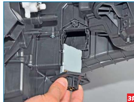
...и снимаем дополнительный резистор. Устанавливаем дополнительный резистор вентилятора отопителя в обратной последовательности.
