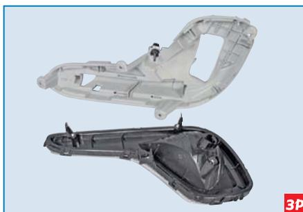
...и разъединяем фару и кронштейн. Устанавливаем противотуманную фару в обратной последовательности.
