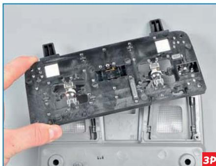
**Снимаем монтажную плату.**
