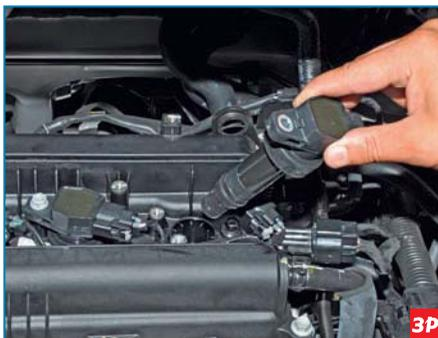
Снимаем катушку зажигания.
