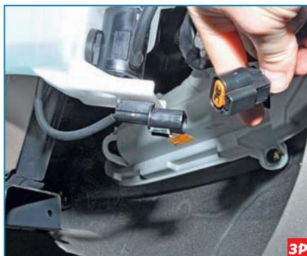
Нажав на фиксатор колодки проводов, отсоединяем ее от разъема датчика уровня омывающей жидкости.
