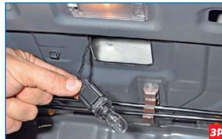
...и вынимаем патрон с лампой.
