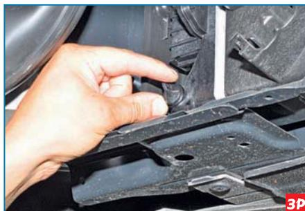
Отворачиваем на 2–3 оборота пробку сливного отверстия радиатора...
