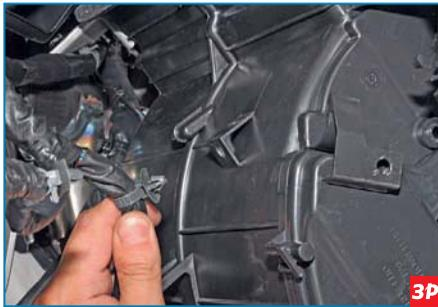
Отсоединяем от корпуса отопителя держатель проводов, расположенный между корпусом отопителя и панелью приборов.
