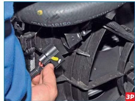
...отсоединяем колодку от разъема дополнительного резистора.
