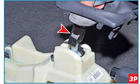
Блокиратор включения передачи заднего хода устанавливаем по направляющим рычага так, чтобы выступ А находился с левой стороны.
