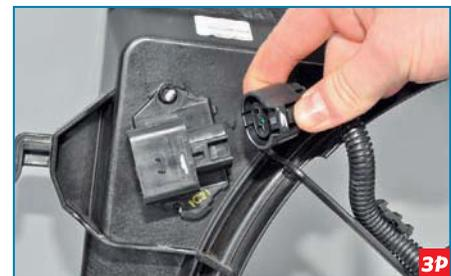
Нажав фиксатор, отсоединяем колодку жгута проводов электродвигателя вентилятора от разъема дополнительного резистора.
