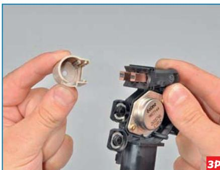
Снимаем крышку щеток.
