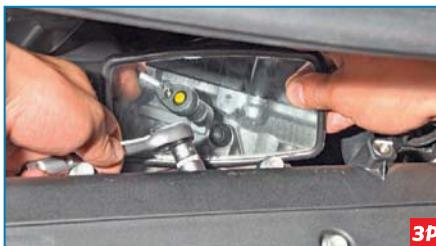
Головкой «на 12» отворачиваем девять гаек крепления катколлектора к головке блока цилиндров (одна из гаек крепления катколлектора на фото показана с помощью зеркала).
