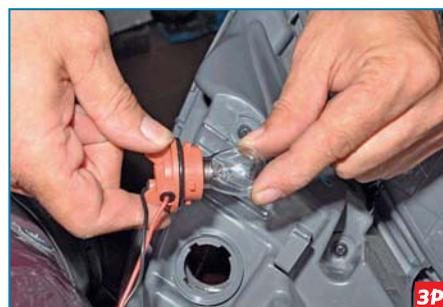
Слегка нажимая на колбу лампы, утапливаем ее в патрон, поворачиваем против часовой стрелки...
