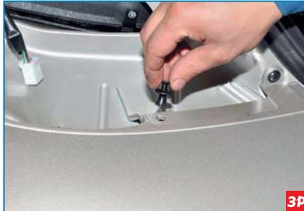
С левой стороны крестообразной отверткой выворачиваем фиксатор и вынимаем piston.
