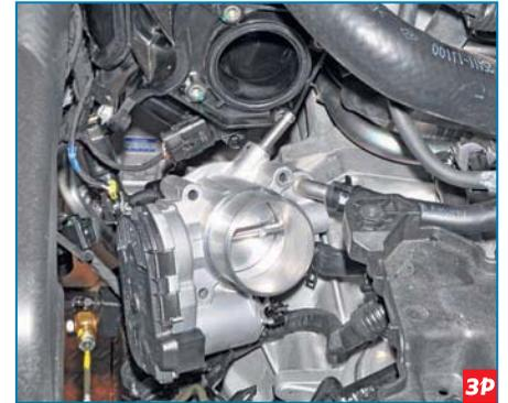
...отводим дроссельный узел от впускного трубопровода, не отсоединяя от штуцеров узла шланги подвода и отвода охлаждающей жидкости.
