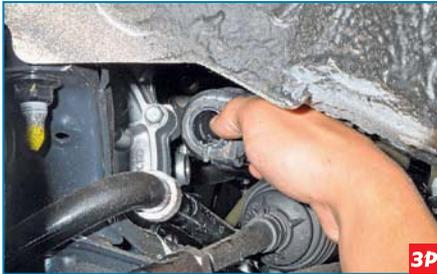
Снимаем разрезную резиновую подушку.
