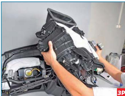
Снимаем отопитель с панели приборов.
