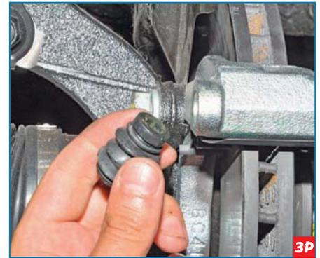
...и снимаем защитный чехол. Аналогично снимаем защитный чехол нижнего направляющего пальца.
