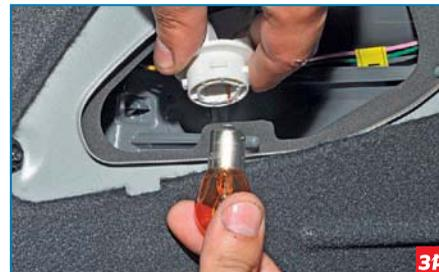
Слегка нажимая на колбу лампы, утапливаем ее в патрон, поворачиваем против часовой стрелки и вынимаем из патрона.
