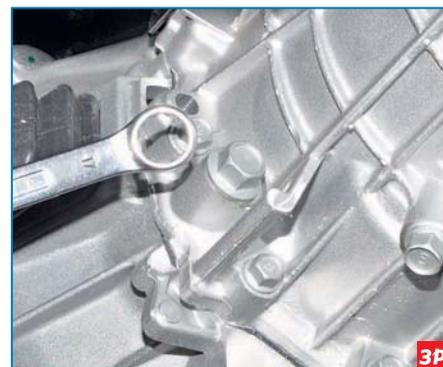
Накидным ключом «на 17» отворачиваем пробку контрольного отверстия.
