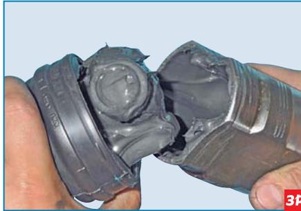
Вынимаем трехшиповик из корпуса.
