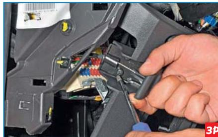
Крестообразной отверткой отворачиваем основание ручки открывания капота и снимаем нижнюю декоративную накладку панели приборов. В моторном отсеке снимаем мотор-редуктор очистителя ветрового стекла (см. «Снятие мотор-редуктора очистителя ветрового стекла», с. 225).
