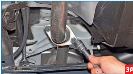
Головкой «на 19» отворачиваем две гайки шпилек крепления фланцев труб основного и дополнительного глушителей.
