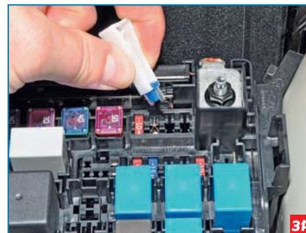
Пинцетом извлекаем предохранитель. Заменяем перегоревший предохранитель новым.
