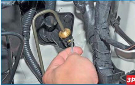
Поддев отверткой, сдвигаем пружинный фиксатор вперед...
