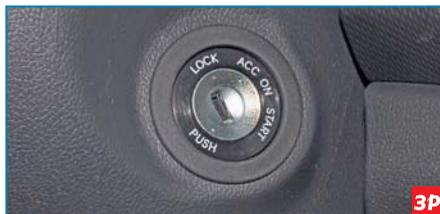
**Ключ может находиться в одном из четырех положений замка зажигания: «LOCK» (блокировка), «ACC» (стоянка), «ON» (зажигание включено) и «START» (стартер)**
