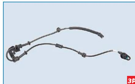
Датчик скорости вращения левого переднего колеса со жгутом проводов и держателем.
