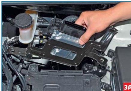
Снимаем кронштейн с блоком управления в сборе.
