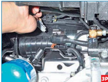
Нажав на фиксатор колодки, отсоединяем колодку проводов от управляющего вывода тягового реле.
