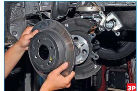
Снимаем диск тормозного механизма со ступицы.
