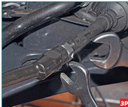
Ключом «на 22» ослабляем затяжку контргайки, удерживая наконечник ключом «на 19» за приливы.
