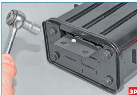
...головкой «на 10» отворачиваем четыре болта крепления правого кронштейна к адсорберу...
