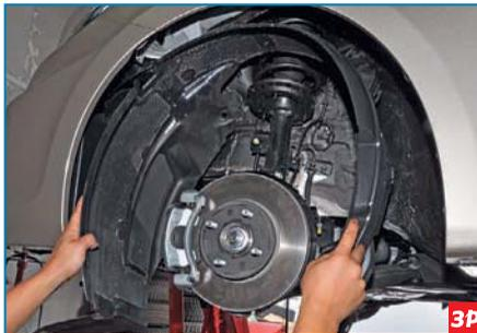
...и снимаем подкрылок. Устанавливаем подкрылок левого переднего колеса в обратной последовательности.
