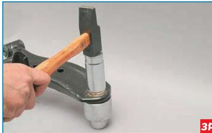
Подставив инструментальную головку «на 46» или отрезок трубы подходящего диаметра под рычаг, ударами молотка через высокую головку «на 30»...
