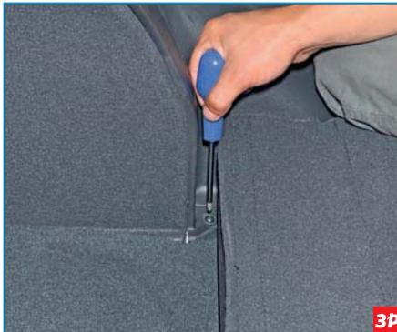
Крестообразной отверткой отворачиваем саморез нижнего крепления обивки полки...
