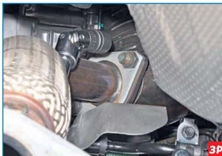
Головкой «на 19» отворачиваем гайки двух шпилек крепления фланца промежуточной трубы к фланцу катколлектора.
