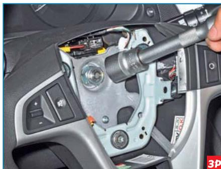
Головкой «на 22» отворачиваем на несколько оборотов гайку крепления рулевого колеса.
