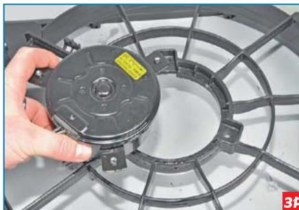
...и снимаем электродвигатель. Сборку и установку вентилятора проводим в обратной последовательности. При сборке узла необходимо совместить...
