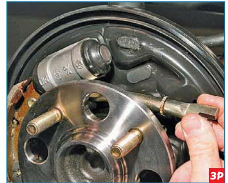
Снимаем распорную планку. Снимаем с тормозного щита заднюю колодку так же, как переднюю...
