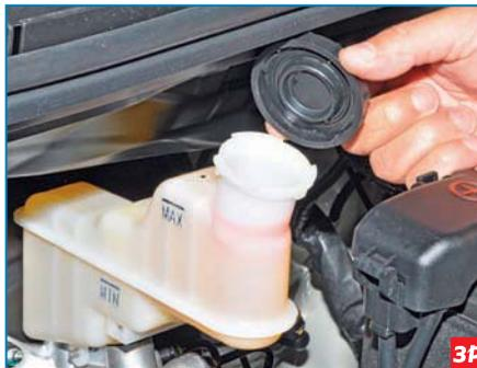
...и снимаем крышку с бачка.
