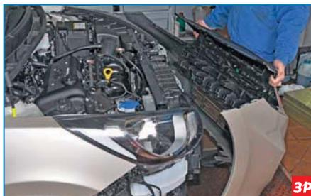
...и снимаем передний бампер.
