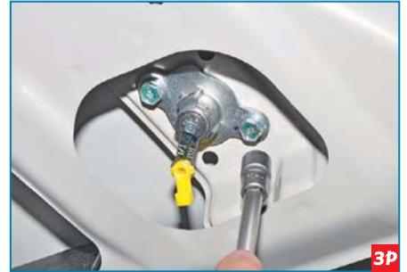
Головкой «на 10» отворачиваем два болта крепления цилиндрического механизма...
