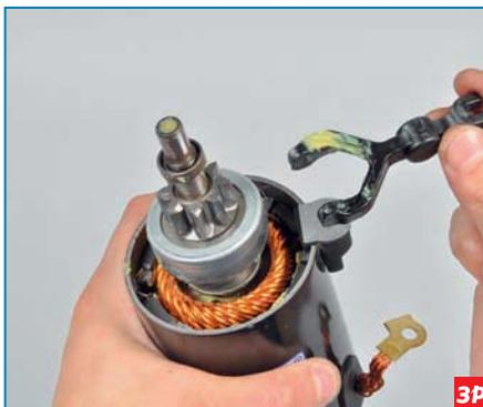
Снимаем рычаг привода.
