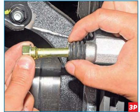
...вынимаем верхний направляющий палец из отверстия направляющей колодок...
