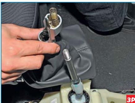
Снимаем с рычага декоративный чехол вместе с блокиратором включения передачи заднего хода.
