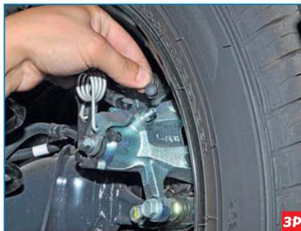
...и снимаем с него защитный колпачок.
