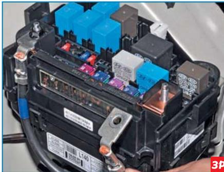
Снимаем со шпильки наконечник провода.
