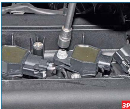
Головкой «на 10» отворачиваем болт крепления катушки зажигания.
