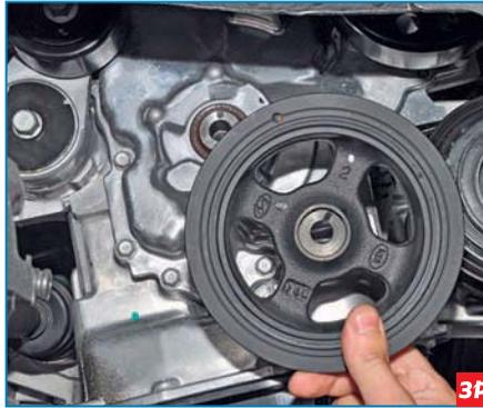
Отвернув болт, снимаем шкив.
