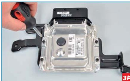
Крестообразной отверткой отворачиваем четыре винта крепления блока управления к кронштейну...
