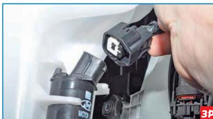
Нажав на фиксатор колодки проводов, отсоединяем ее от разъема насоса.
