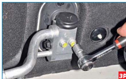
На щитке передка головкой «на 10» отворачиваем два болта крепления
