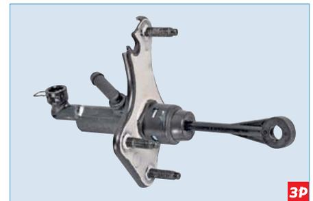
**Главный цилиндр гидропривода сцепления в сборе с толкателем**
