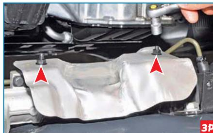
Головкой «на 10» отворачиваем две гайки крепления теплозащитного экрана...
