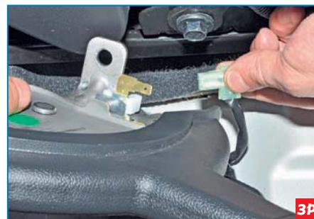
Отсоединяем колодку проводов от наконечника выключателя сигнализатора стояночного тормоза.
