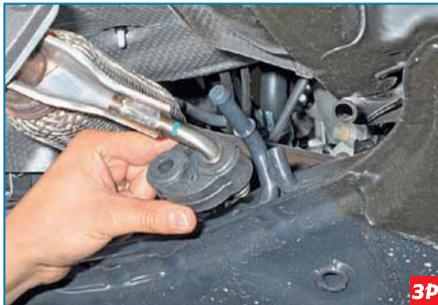
Снимаем переднюю подушку системы выпуска отработавших газов.
