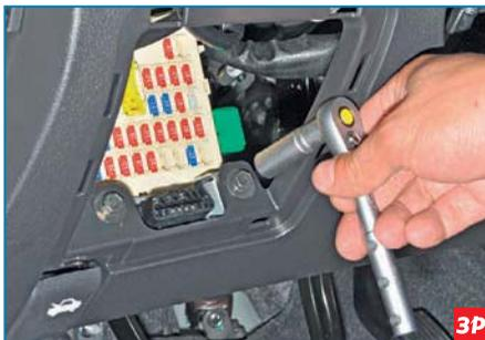
Головкой «на 10» отворачиваем два болта крепления нижней декоративной накладки панели приборов.
