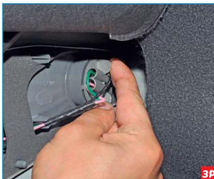
Поворачиваем против часовой стрелки патрон комбинированной лампы сигнала торможения и габаритного света.
