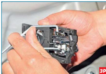
...и вынимаем конец тяги из отверстия рычага.
