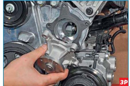
...и снимаем насос охлаждающей жидкости.
