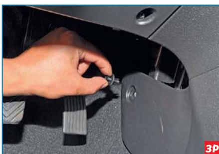
...и вынимаем пистон. Аналогично вынимаем пистон бокового крепления облицовки туннеля пола с правой стороны.
