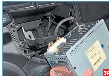
...и вынимаем устройство из посадочного места.
