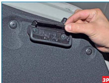
...и, преодолев сопротивление фиксаторов, открываем ее.
