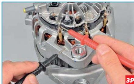
...подсоединяем щупы тестера (в режиме омметра) к выводу обмотки и корпусу генератора.
