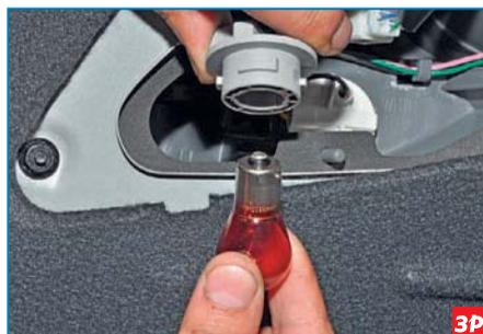
Слегка нажимая на колбу лампы, утапливаем ее в патрон, поворачиваем против часовой стрелки и вынимаем из патрона.
