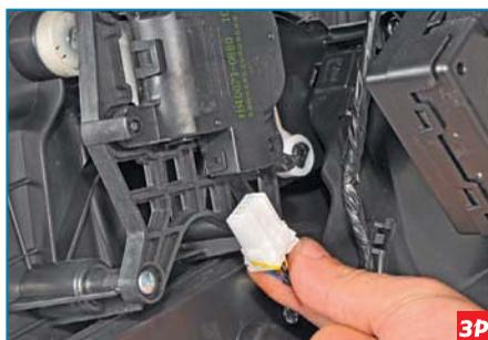
Нажав на фиксатор колодки, отсоединяем колодку проводов от электропривода распределительных заслонок.
