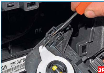
Отверткой поворачиваем оболочку тяги привода заслонки регулятора температуры...
