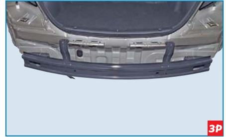
Под задним бампером установлен усилитель.
