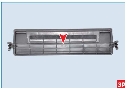
Крышку фильтра устанавливаем так, чтобы стрелка на крышке была направлена вверх.
