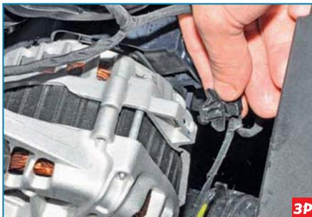
...вынимаем держатель из отверстия крышки генератора.
