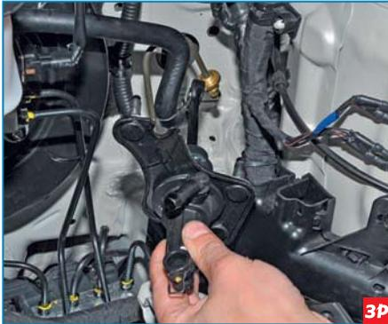
Выводим толкатель через отверстие в щитке передка и вынимаем главный цилиндр из моторного отсека.
