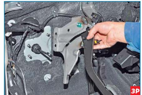
Снимаем педальный узел со шпилек фланца главного цилиндра.
