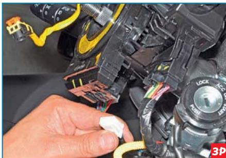
Нажав на фиксатор колодки, отсоединяем колодку проводов белого цвета от барабанного устройства.
