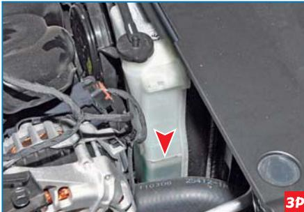
На стенке бачка нанесены метки F и L, между которыми должен находиться уровень жидкости на холодном двигателе (метка L на фото не видна).
