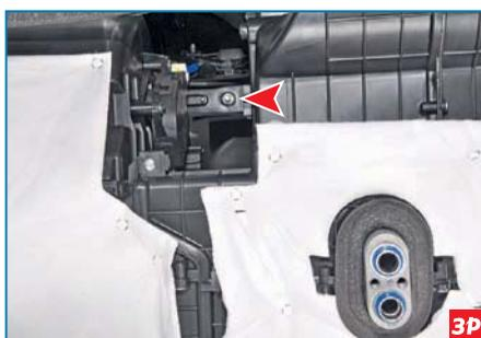
Этим же инструментом отворачиваем гайку центрального крепления отопителя к панели приборов.
