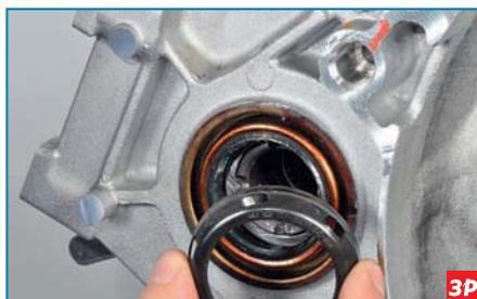
...извлекаем из полости сальника запорную металлическую обойму.
