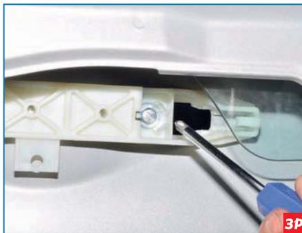
Крестообразной отверткой отворачиваем саморез переднего крепления основания наружной ручки...
