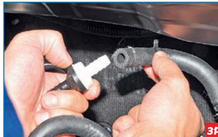
Аналогично снимаем шланг со штуцера клапана со стороны вакуумного усилителя тормозов.
