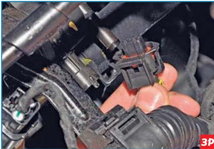
Нажав фиксатор колодки жгута проводов системы управления двигателем, отсоединяем колодку от разъема клапана. Сдвигаем клапан с резиновым держателем вперед, снимая его с кронштейна головки блока цилиндров...
