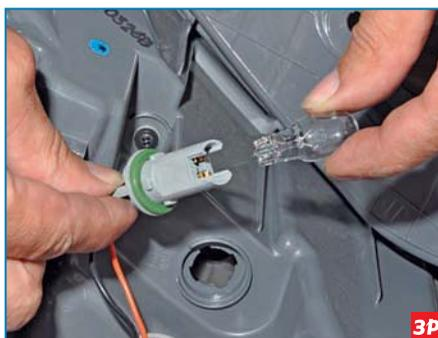
Потянув за колбу, вынимаем лампу из контактных зажимов патрона.
