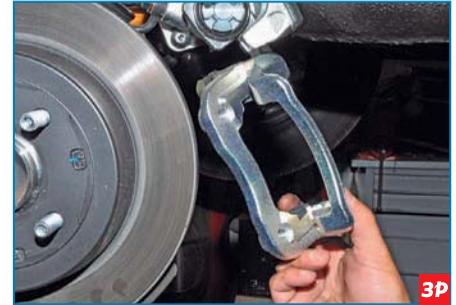
...и снимаем направляющую колодок.
