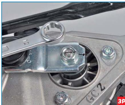
Ключом «на 12» отворачиваем гайку крепления кривошипа к валу мотор-редуктора.
