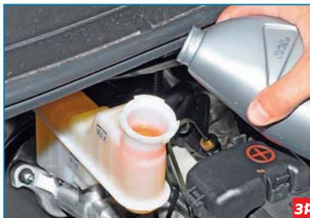
Доливаем жидкость типа DOT-4 в бачок до метки MAX.
