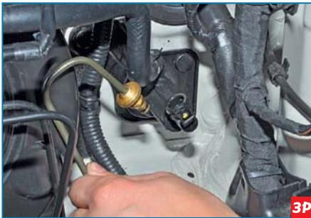
...и вынимаем штуцер трубки подвода жидкости к рабочему цилиндру сцепления из отверстия главного цилиндра сцепления.
