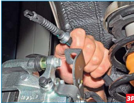
Вынимаем оболочку с наконечником троса из отверстия опорного кронштейна на суппорте.
