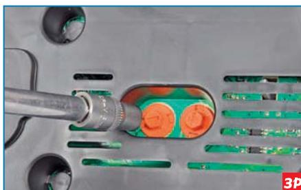
...головкой «на 10» поворачиваем патрон лампы против часовой стрелки...
