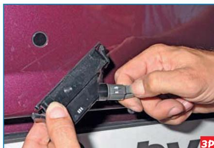
Поворачиваем патрон по часовой стрелке до упора...
