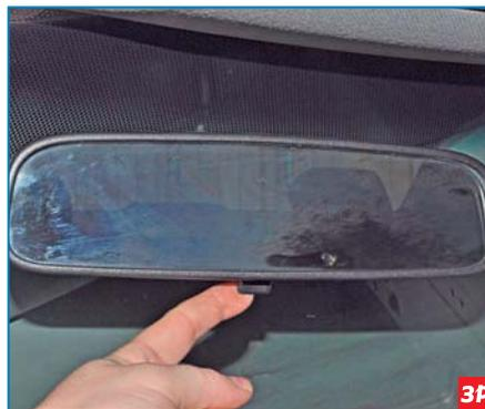
**Для этого перемещаем регулятор положения зеркала на себя...**
