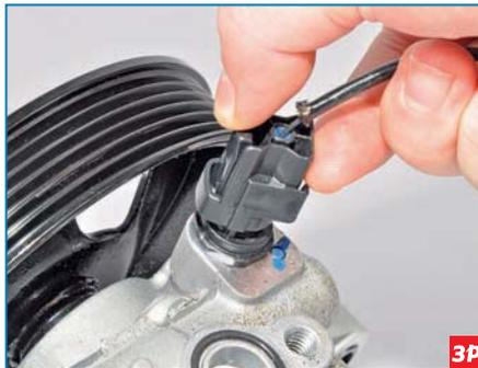
Нажав на «фиксатор» колодки...
