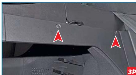
Расположение двух пистонов верхнего крепления левой вертикальной обивки задней полки.
