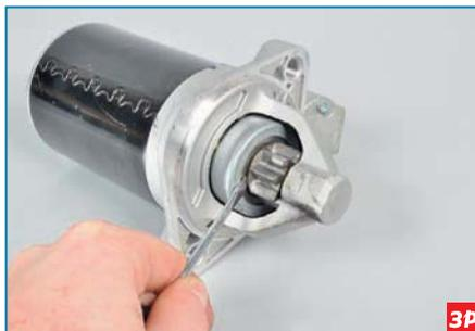
Отверткой сдвигаем шестерню привода по валу.
