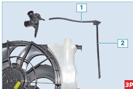
Шланги 1 и 2, присоединенные к штуцерам крышки расширительного бачка, связывают бачок с заливной горловиной системы охлаждения
