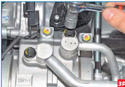
Головкой «на 12» отворачиваем болт крепления трубки высокого давления.
