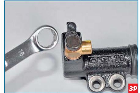
Накидным ключом «на 16» отворачиваем болт-штуцер крепления переходника к рабочему цилиндру...
