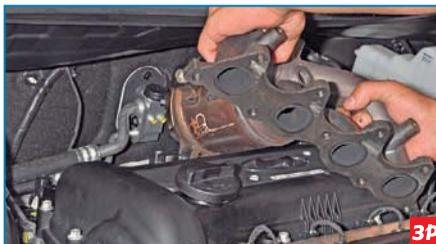
Сдвигаем катколлектор по шпилькам головки блока цилиндров и вынимаем его вверх.
