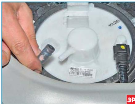
...и снимаем шланг со штуцера крышки топливного модуля. Нажав фиксаторы наконечника трубки подачи топлива к рампе...
