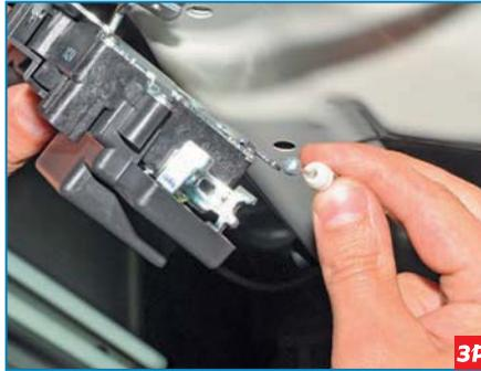
...и отсоединяем наконечник троса привода замка от рычага.
