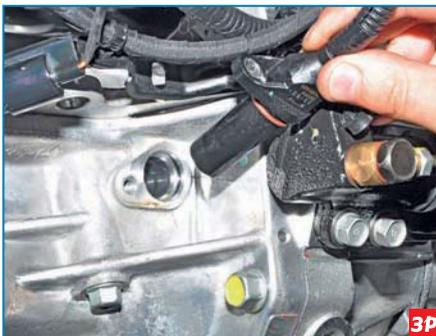
...и вынимаем датчик из гнезда поддона картера.
