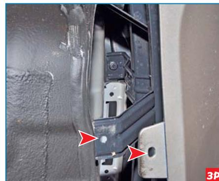
...из отверстий бампера и кронштейна усилителя.
