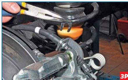
...извлекаем стопорную скобу из проточки оболочки троса.
