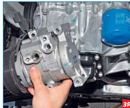
Снимаем компрессор кондиционера. Устанавливаем компрессор в обратной последовательности.
