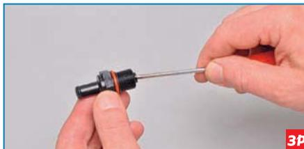
...вставляем тонкий стержень со стороны резьбовой части клапана и нажимаем на стержень.
