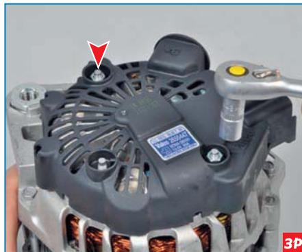
Головкой «на 8» отворачиваем две гайки...
