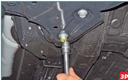
Головкой «на 19» отворачиваем болт заднего крепления подрамника к кузову.
