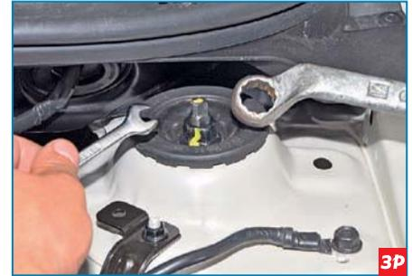
Z-образным ключом «на 17» отворачиваем гайку крепления верхней опоры амортизаторной стойки...
