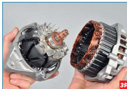
Снимаем заднюю крышку в сборе со статором и выпрямительным блоком.
