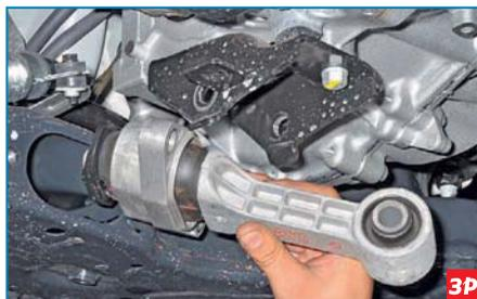
...и снимаем опору.
