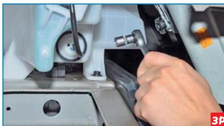
Головкой «на 10» отворачиваем болт нижнего крепления бачка.
