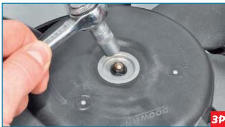
Головкой «на 8» отворачиваем гайку крепления крыльчатки вентилятора...
