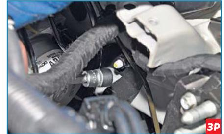
Головкой «на 12» отворачиваем гайку крепления кронштейна блока к лонжерону кузова...
