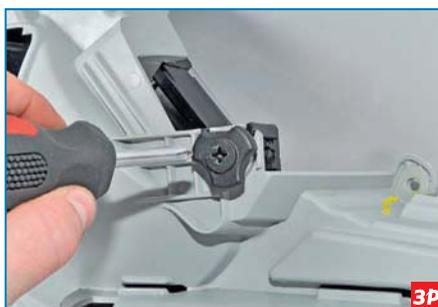
Рукой или крестообразной отверткой отворачиваем регулировочный винт...
