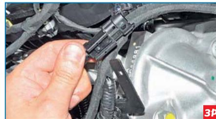
Сдвигаем колодку жгута проводов датчика с кронштейна вверх.
