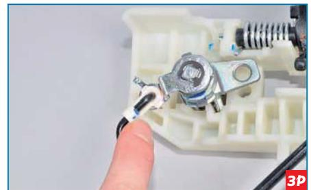
Отжав пластмассовый фиксатор тяги цилиндрического механизма замка...
