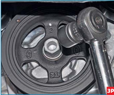
Головкой «на 22» с воротком отворачиваем болт крепления шкива.
