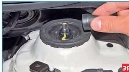
...снимаем защитный резиновый колпачок штока амортизатора.
