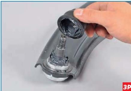
...снимаем пыльник с шаровой опоры.
