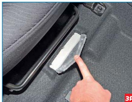
Идентификационный номер (VIN) расположен в салоне автомобиля перед правым передним креслом, под клапаном коврового покрытия пола.
