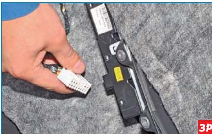
Нажав на фиксатор, отсоединяем колодку проводов от выключателей электростеклоподъемников и центрального замка.
