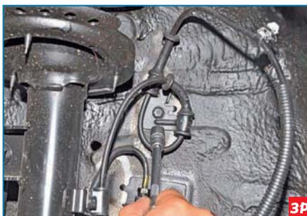
Головкой «на 10» отворачиваем болт крепления держателя жгута проводов к кузову и отводим его от кузова.
