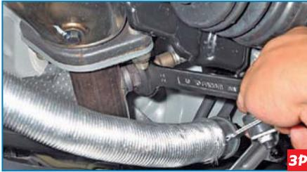
Ключом «на 22» выворачиваем датчик из резьбового отверстия промежуточной трубы системы выпуска отработавших газов...
