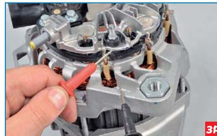
...«плюс» тестера (в режиме проверки диодов) подсоединяем к выводу одной из фазных обмоток статора, а минус – к корпусу генератора.
