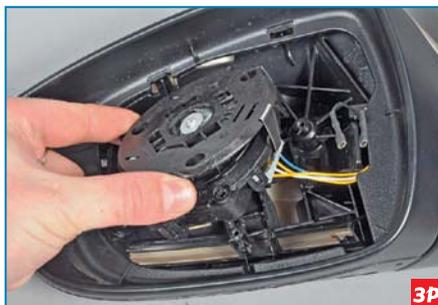
Отводим блок мотор-редукторов в сторону.
