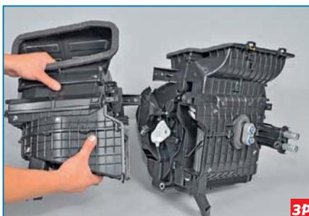
Разъединяем корпуса вентилятора и отопителя.
