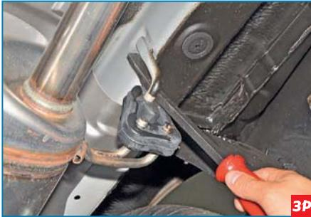
...с помощью большой отвертки стягиваем с кронштейна кузова заднюю подушку подвески основного глушителя.
