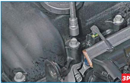
Головкой «на 10» отворачиваем шестнадцать болтов крепления крышки головки блока цилиндров...
