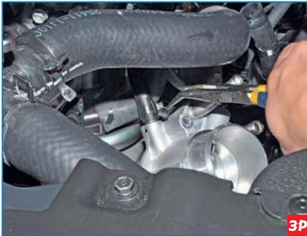
Сжав пассатижами концы хомута крепления шланга подвода паров топлива, сдвигаем хомут по шлангу...
