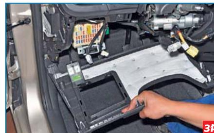
Отсоединяем колодки проводов выключателя зажигания и катушки АПС от выключателя зажигания.
