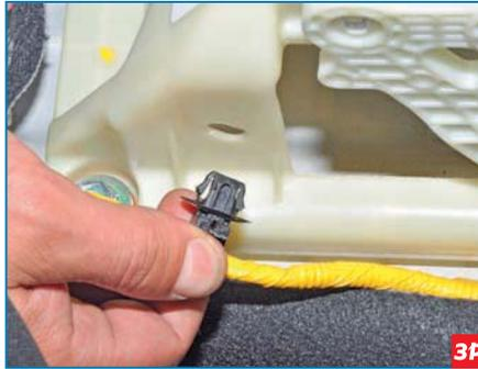
Сжимаем фиксаторы держателя жгута проводов и вынимаем его из отверстия основания механизма управления.
