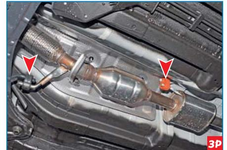
...и дополнительного глушителя с резонатором.
