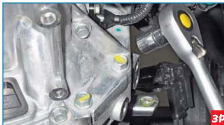
Головкой «на 14» отворачиваем четыре болта крепления коробки передач к поддону картера двигателя и один болт крепления к блоку цилиндров.
