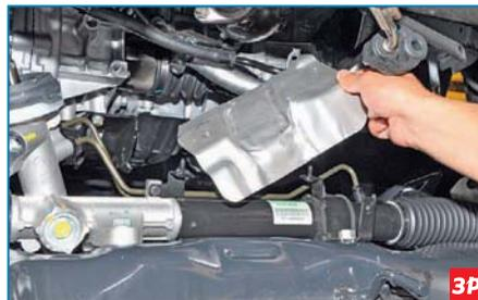
...и снимаем его с рулевого механизма.
