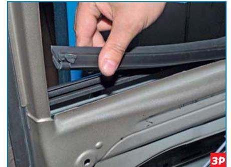
Снимаем внутренний уплотнитель стекла.
