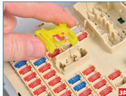
...и вынимаем группу предохранителей.
