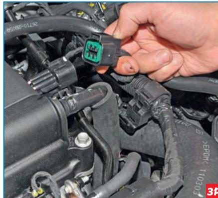
Нажав фиксатор колодки переднего жгута проводов, отсоединяем колодку от колодки жгута проводов катушек зажигания.
