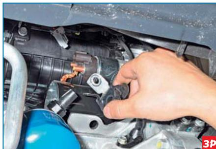
...и снимаем наконечник провода с контактного болта тягового реле.
