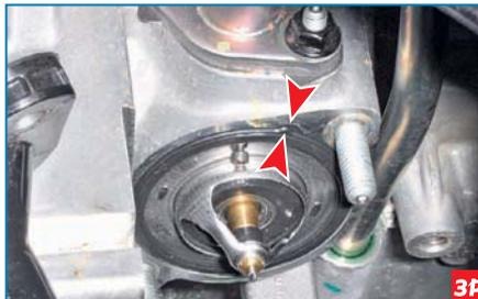
...ориентируем его так, чтобы выступ уплотнительной прокладки совпал с пазом в гнезде.
