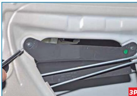
Крестообразной отверткой отворачиваем два самореза крепления пластмассового прижима тяг внутренней ручки двери...
