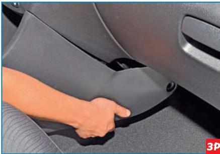
Отжимаем боковины туннеля пола в стороны, преодолевая сопротивление фиксаторов.
