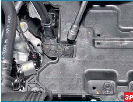
Головкой «на 10» отворачиваем болт крепления пластмассового держателя проводов аккумуляторной батареи.
