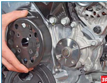
...снимаем шкив со ступицы насоса.
