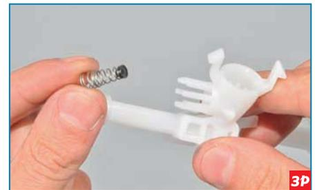
Вынимаем пружину с резиновой шайбой клапана.
