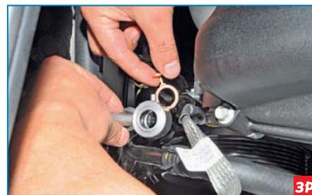
Отводим наконечник трубки от насоса и вынимаем другую медную прокладку.
