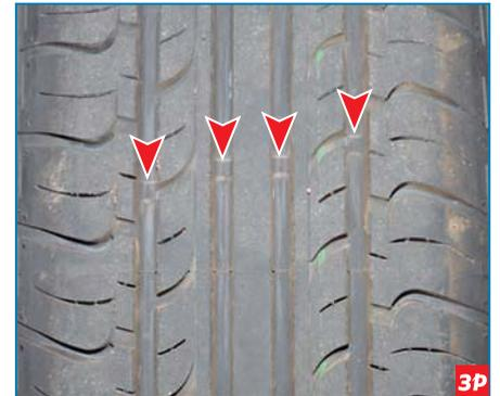
Для контроля износа протектора в его канавках выполнены индикаторы в виде выступов высотой 1,6 мм.
