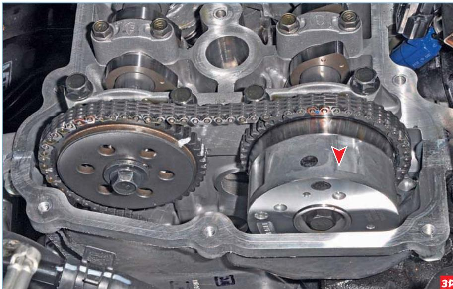
Исполнительный механизм системы изменения фаз установлен на носке распределительного вала впускных клапанов и совмещен со звездочкой привода вала
