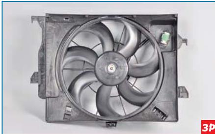
Снимаем кожух с вентилятором (см. «Снятие вентилятора и радиатора», с. 111).
