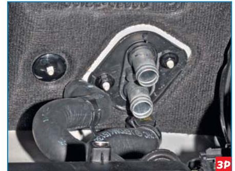
Сжав концы хомутов крепления подводящего и отводящего шлангов отопителя, сдвигаем их по шлангам и снимаем шланги с патрубков отопителя.
