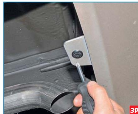
Снизу автомобиля крестообразной отверткой выворачиваем фиксаторы двух пистонов крепления бампера к кронштейнам усилителя бампера...
