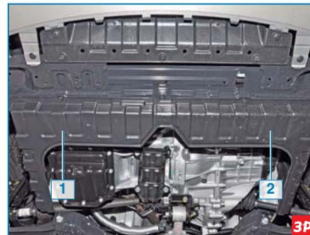
Правый 1 и левый 2 грязезащитные щитки моторного отсека.
