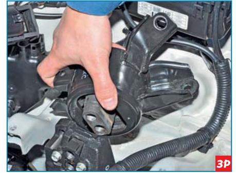
...и снимаем опору.
