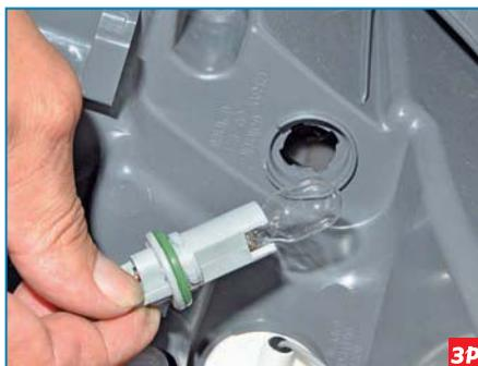
Вынимаем патрон с лампой из корпуса фонаря.
