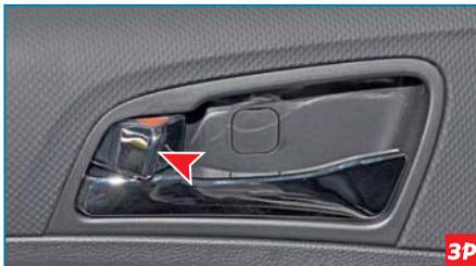
Чтобы разблокировать замок двери, тянем клавишу переключателя внутренней ручки на себя, при этом на клавише будет видна метка красного цвета.
