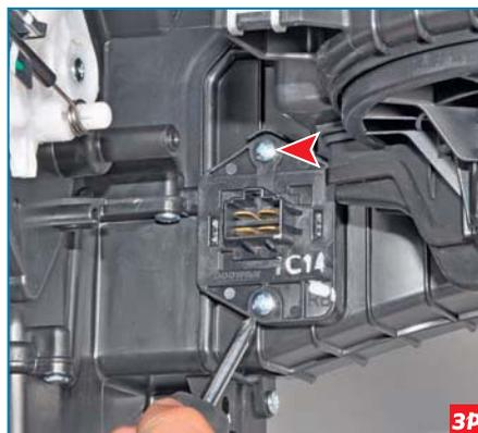
Крестообразной отверткой отворачиваем два самореза...
