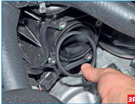
...вынимаем кольцо из проточки фланца впускного коллектора.
