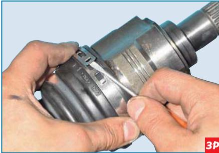
Отверткой поддеваем конец большого хомута крепления чехла так, чтобы не повредить при этом корпус шарнира...
