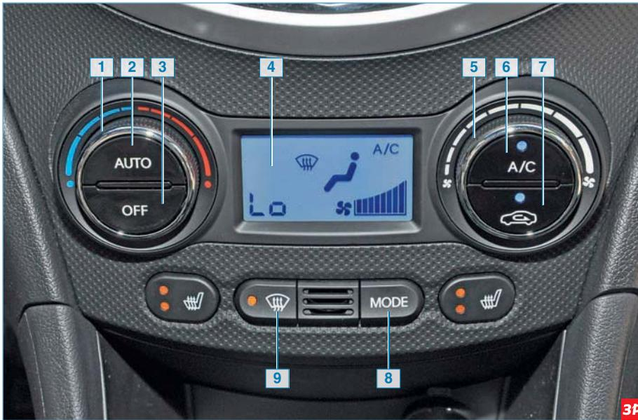
**Блок управления системой климат-контроля:** 1 – регулятор температуры воздуха; 2 – кнопка включения системы автоматического управления микроклиматом; 3 – кнопка выключения системы автоматического режима; 4 – информационный дисплей; 5 – переключатель скорости вращения вентилятора; 6 – кнопка включения кондиционера; 7 – кнопка включения режима рециркуляции воздуха; 8 – кнопка распределения потоков воздуха в салоне; 9 – кнопка включения режима удаления инея/влаги с ветрового стекла
