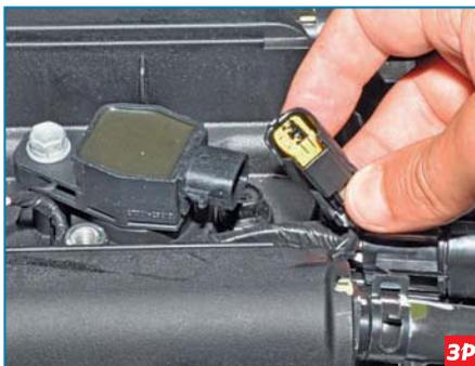
...и отсоединяем колодку проводов от катушки зажигания.
