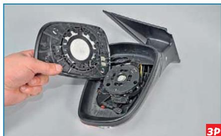
Отводим отражающий элемент в сторону.
