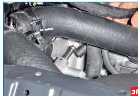
...и снимаем шланг со штуцера дроссельного узла.
