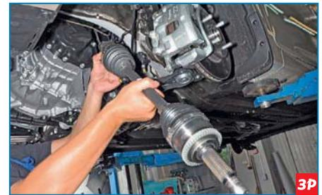
Снимаем привод левого колеса.
