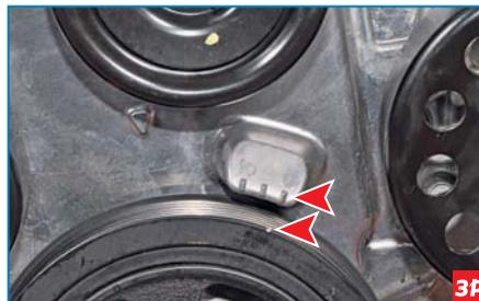
При этом метка (риска) на шкиве привода вспомогательных агрегатов должна совпадать с меткой «0» на приливе крышки привода ГРМ.
