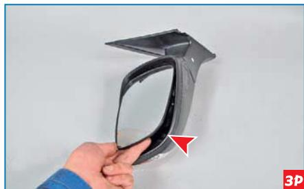
Поддев рукой, тянем его на себя и отверткой отжимаем (отвертку вставляем в направлении стрелки)...
