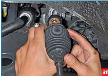
Сдвигаем защитный чехол по рулевой тяге...
