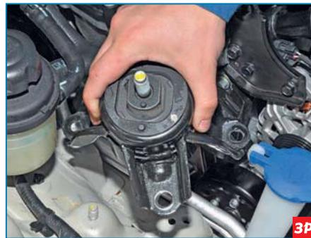
...и вынимаем опору из моторного отсека.
