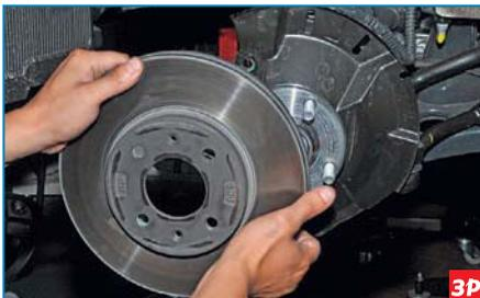
Снимаем диск тормозного механизма со ступицы.
