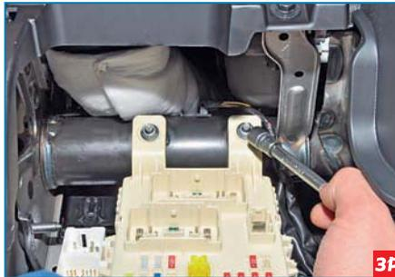
Головкой «на 10» отворачиваем две гайки крепления монтажного блока.
