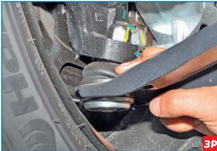
**Проверяем состояние защитных чехлов шаровых опор.**
