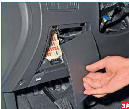
...потянув, снимаем крышку монтажного блока с панели приборов.
