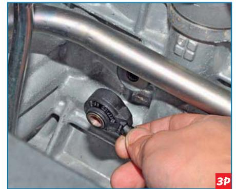
...и снимаем датчик детонации.
