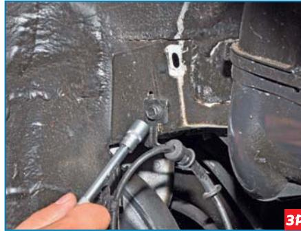
Головкой «на 10» отворачиваем болт крепления держателя жгута проводов к кузову и отводим его от кузова.
