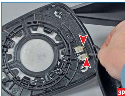
Отсоединяем две клеммы проводов от контактов элемента обогрева.
