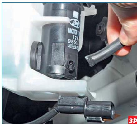
Отсоединяем шланг от штуцера насоса (насос омывателя автомобиля с кузовом хэтчбек имеет два штуцера).
