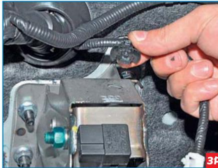
Извлекаем держатель жгута проводов из отверстия в кронштейне педального узла.
