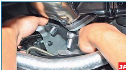
Головкой «на 10» отворачиваем две гайки крепления теплозащитного экрана рулевой рейки...
