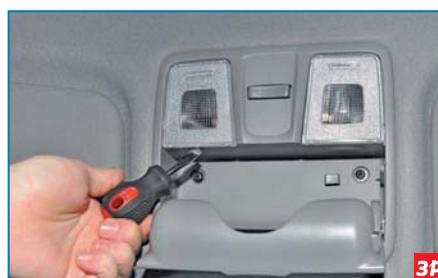
...поддеваем отверткой рассеиватель плафона.
