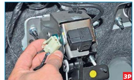
Нажав на фиксатор колодки переднего жгута проводов, отсоединяем колодку от разъема датчика положения начала хода педали сцепления.
