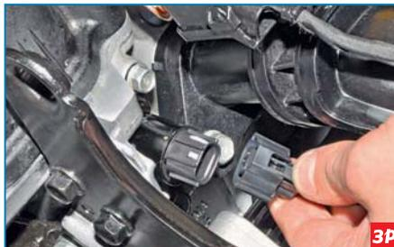
Нажав фиксатор колодки переднего жгута проводов, отсоединяем колодку от разъема клапана.
