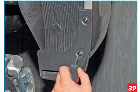
Крестообразной отверткой отворачиваем два самореза крепления брызговика и подкрылка к заднему бамперу.
