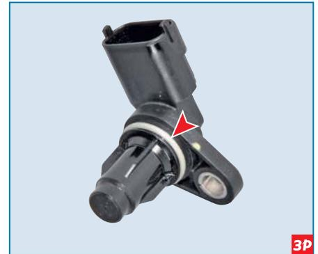
Соединение датчика с головкой блока цилиндров уплотняется резиновым кольцом.
