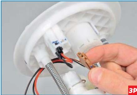
Нажав фиксатор колодки проводов датчика указателя уровня топлива, отсоединяем колодку от разъема крышки модуля.
