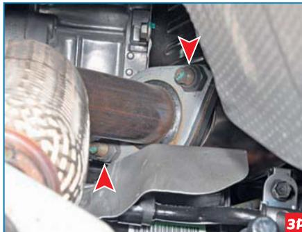
Проверяем и при необходимости подтягиваем крепления промежуточной трубы к выпускному коллектору...
