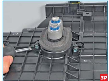
Крестообразной отверткой отворачиваем девять саморезов крепления кожуха испарителя.
