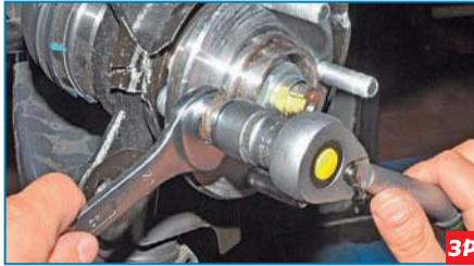
Запрессовываем шпильку до упора ее головки во фланец ступицы, наворачивая на шпильку колесную гайку через подходящую втулку.
