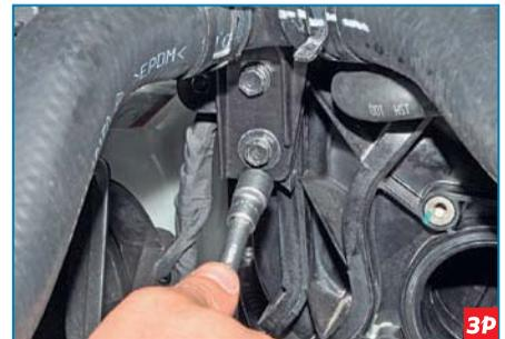
Головкой «на 10» отворачиваем два болта крепления кронштейна заливной горловины системы охлаждения к впускному трубопроводу ...
