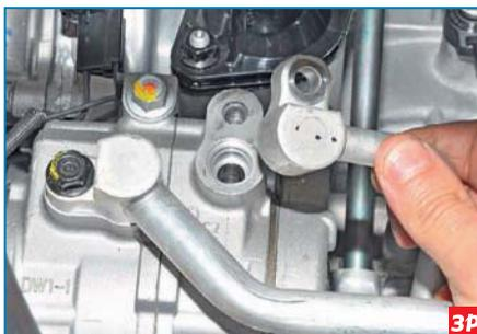
Отводим наконечник трубки высокого давления.
