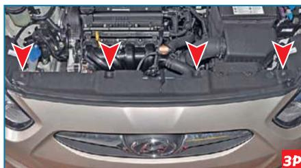
Головкой «на 10» отворачиваем четыре болта крепления накладки облицовки радиатора.
