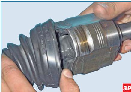
Стягиваем чехол с корпуса внутренне-го шарнира и сдвигаем по валу.
