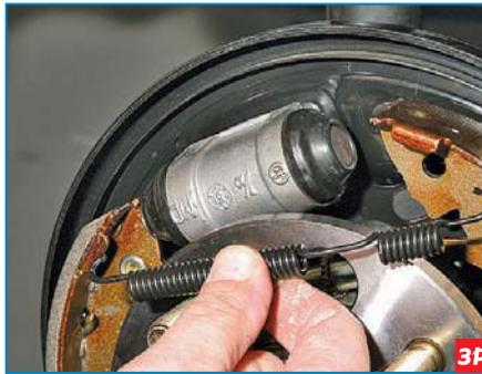
...снимаем верхнюю стяжную пружину.
