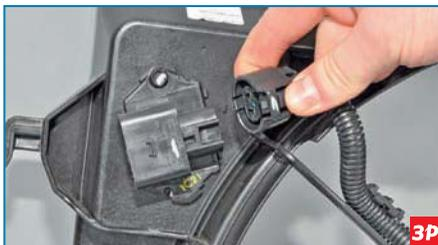
Нажав фиксатор, отсоединяем колодку жгута проводов электродвигателя от разъема дополнительного резистора.
