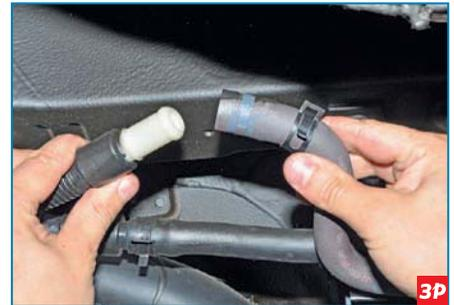
...и снимаем шланг с наконечника пластмассовой трубки наливной трубы.
