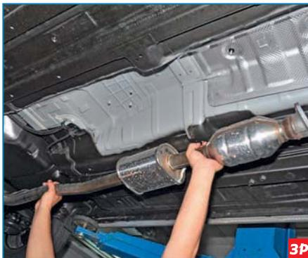
Снимаем дополнительный глушитель с резонатором.
