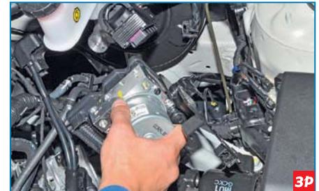
...и вынимаем блок ABS с кронштейном из моторного отсека.
