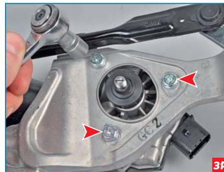
Головкой «на 10» отворачиваем три болта крепления мотор-редуктора к кронштейну механизма очистителя.
