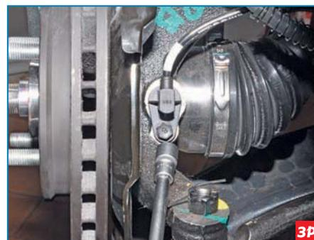
Головкой «на 10» отворачиваем болт крепления датчика к поворотному кулаку...
