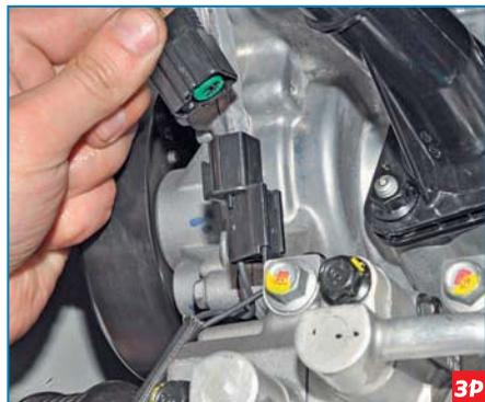
Нажав на фиксатор, отсоединяем колодку переднего жгута проводов от колодки компрессора.
