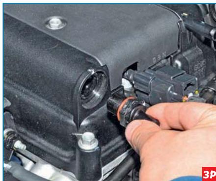
...и снимаем клапан.
