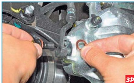
Вынимаем болт-штуцер из отверстия наконечника тормозного шланга и снимаем две медные уплотнительные шайбы.
