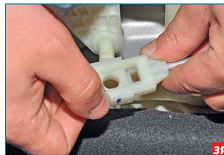
...и снимаем наконечник с пальца рычага.
