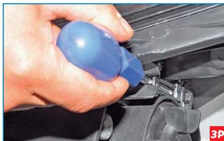
Поворачивая крестообразной отверткой регулятор, расположенный ближе к крылу автомобиля, изменяем положение светового пучка в горизонтальной плоскости.
