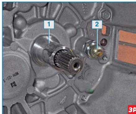
1 – цилиндрическая поверхность картера, по которой перемещается подшипник; 2 – опора вилок выключения сцепления
