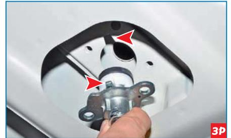
...и повернув его так, чтобы выступ на корпусе механизма совпал с пазом на усилителе крышки багажника, снимаем механизм.
