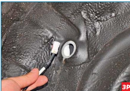
...и выводим колодку жгута проводов датчика через отверстие в арке.
