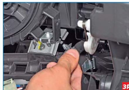
Отсоединяем второй держатель проводов от корпуса вентилятора.
