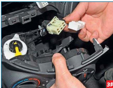
Нажав на фиксаторы колодок, отсоединяем две колодки проводов от разъемов блока.
