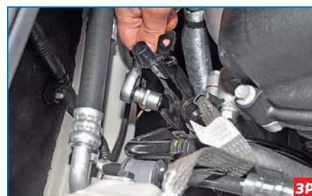
Головкой «на 12» отворачиваем два болта крепления кронштейна колодки датчика давления и фланца трубки наливной магистрали.
