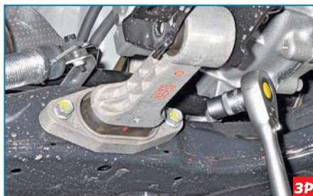
Головкой «на 14» отворачиваем два болта крепления задней опоры к подрамнику передней подвески...
