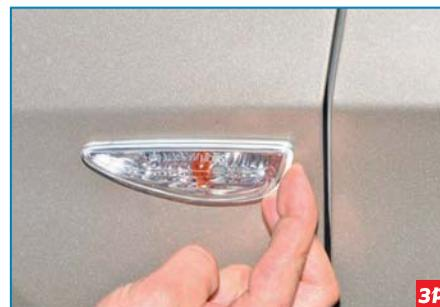
Сдвигаем боковой указатель поворота в сторону передней части автомобиля...
