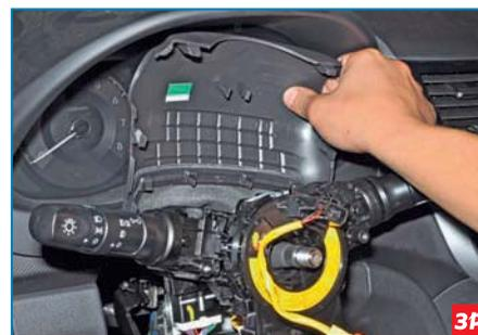
Поднимаем верхний кожух рулевой колонки.
