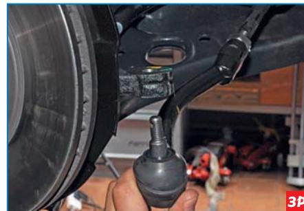
...выводим палец шарового шарнира из отверстия в рычаге.
