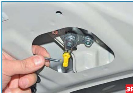
...вынимаем конец тяги из отверстия рычага цилиндрического механизма замка.
