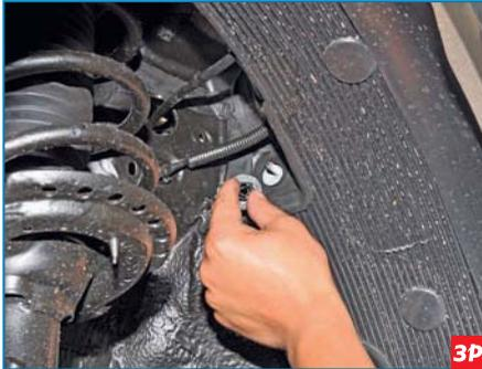
Ключом «на 14» отворачиваем гайку верхнего заднего крепления подкрылка в арке переднего колеса.
