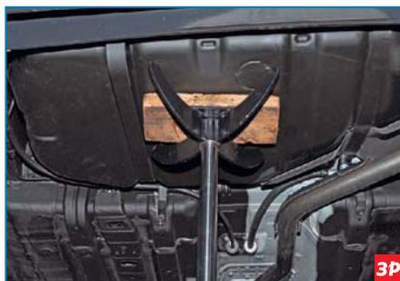
Подставляем под топливный бак через деревянный брусок регулируемый упор.
