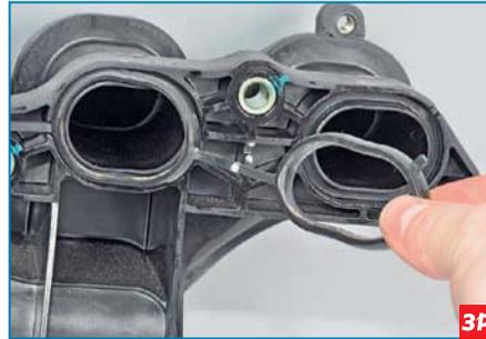
Вынимаем резиновую уплотнительную прокладку из пазов фланца впускного трубопровода.
