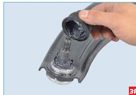
**Корпус шаровой опоры запрессован в рычаг передней подвески и застопорен, а палец шаровой опоры крепится к поворотному кулаку с помощью конического соединения с гайкой**
