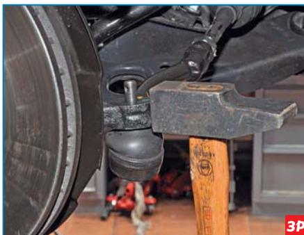
Отжимая монтажной лопаткой наконечник рулевой тяги вниз и нанося удары молотком по торцу рычага поворотного кулака, выпрессовываем палец из отверстия в рычаге.
