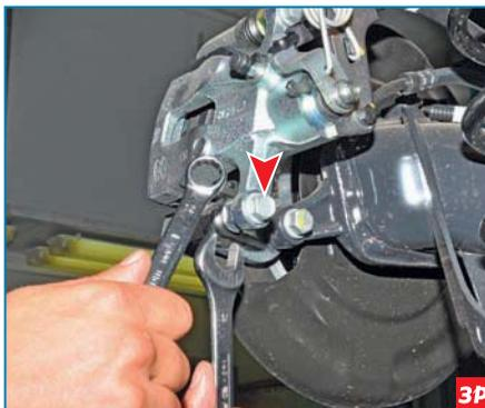
Накидным ключом «на 14» отворачиваем нижний болт крепления суппорта к направляющему пальцу, удерживая направляющий палец ключом «на 17». Аналогично отворачиваем верхний болт крепления суппорта к направляющему пальцу.
