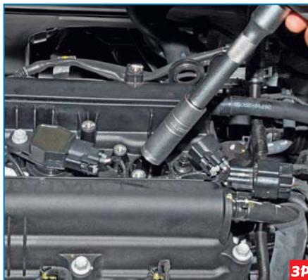
Высокой головкой «на 16» с удлинителем выворачиваем свечу...
