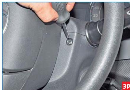
...крестообразной отверткой отворачиваем другой саморез крепления нижнего кожуха.
