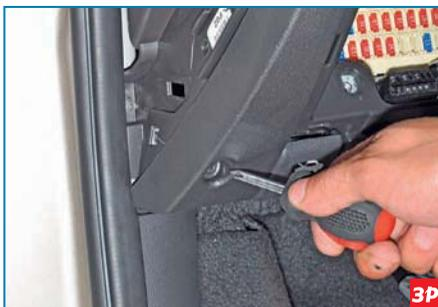
Крестообразной отверткой с двух сторон накладки отворачиваем по саморезу.
