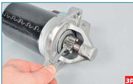
...отверткой проворачиваем шестерню привода.
