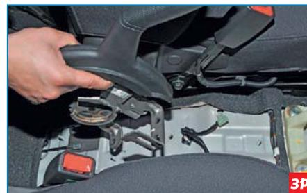
Снимаем рычаг стояночного тормоза.
