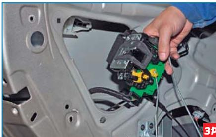
...и выводим его в сборе с электроприводом и тягами через технологи-
