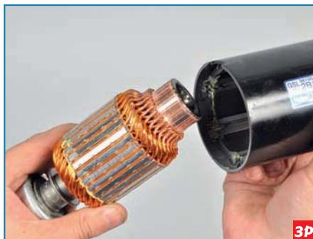
Вынимаем якорь из корпуса стартера.
