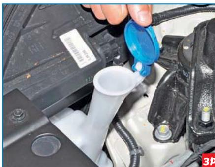
Открываем крышку заливной горловины бачка.
