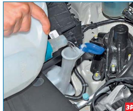
...доливаем жидкость. Закрываем крышку бачка.
