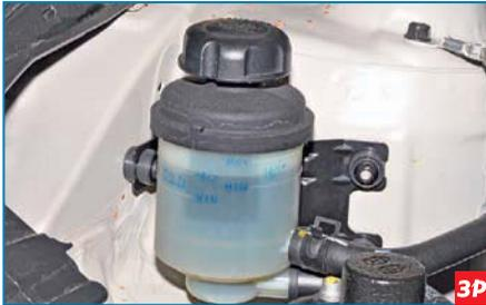
На бачке нанесены метки MIN и MAX (COLD), между которыми должен находиться уровень рабочей жидкости при холодном двигателе.
