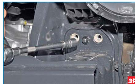
Головкой «на 10» отворачиваем гайку крепления усилителя бампера к рамке радиатора.
