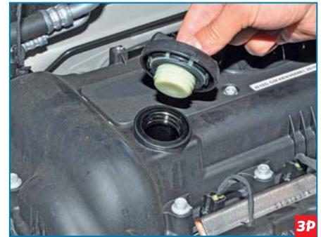
...отворачиваем против часовой стрелки и снимаем крышку маслозаливной горловины.
