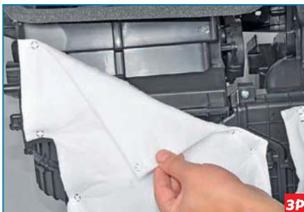
...снимаем его с корпуса вентилятора. Аналогично снимаем теплоизоляционный лист с корпуса отопителя.
