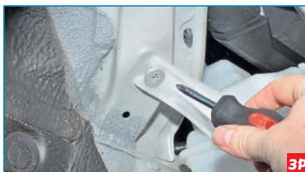
Крестообразной отверткой отворачиваем винт верхнего крепления бачка.
