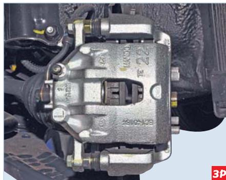
**Тормозной механизм переднего колеса**
