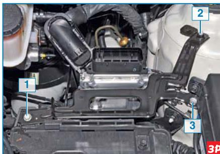
Головкой «на 10» с удлинителем отворачиваем болт 1 крепления кронштейна блока управления к площадке аккумуляторной батареи, а также гайку 2 и болт 3 крепления кронштейна к брызговiku.
