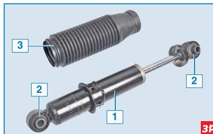
**Амортизатор задней подвески:** 1 – амортизатор; 2 – резинометаллические шарниры; 3 – чехол
