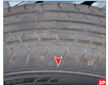
В местах нахождения индикаторов износа на боковинах шин нанесены метки в виде треугольника или букв TWI.
