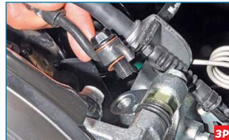
Снимаем болт-штуцер с двумя медными уплотнительными шайбами и наконечником тормозного шланга.
