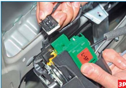
Нажав на фиксатор, отсоединяем колодку жгута проводов от электропривода блокировки замка...
