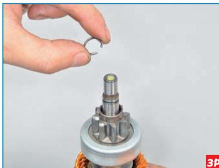
...вынимаем стопорное кольцо из канавки вала якоря.
