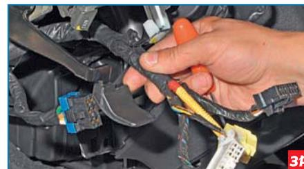
Отводим жгуты проводов от рулевой колонки.
