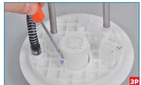
...шлицевой отверткой отжимаем два фиксатора...
