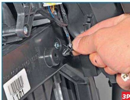
Отсоединяем держатель проводов от крышки радиатора отопителя.
