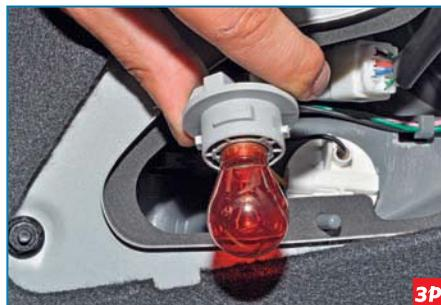
Вынимаем патрон с лампой из корпуса фонаря.
