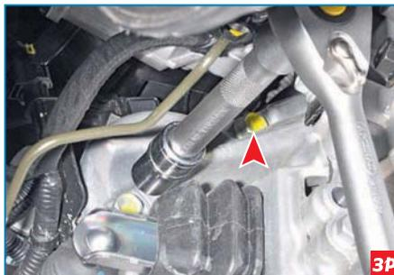
Головкой «на 14» отворачиваем два болта крепления стартера.
