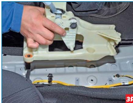
...и снимаем механизм управления коробкой передач.
