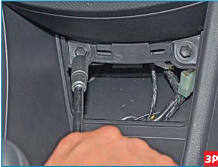
Головкой «на 10» отворачиваем два болта крепления облицовки туннеля пола к панели приборов.
