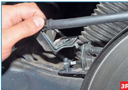
...и снимаем его со шпильки.
