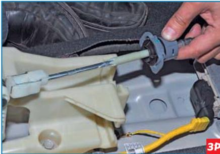
Вынимаем наконечник оболочки троса включения передач из основания механизма управления аналогично тросу выбора передач.
