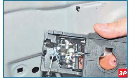
Аналогично отсоединяем наконечник троса от другого рычага ручки и снимаем внутреннюю ручку передней двери. Устанавливаем внутреннюю ручку передней двери в обратной последовательности.
