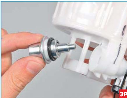
Вынимаем регулятор давления топлива из гнезда корпуса топливного фильтра.
