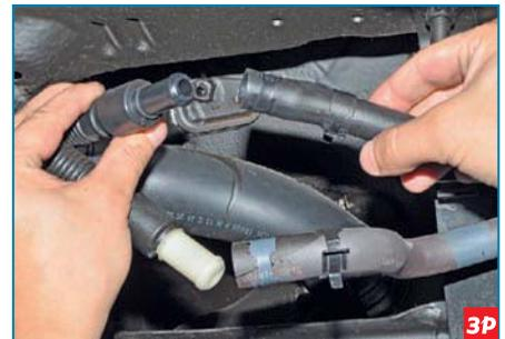
Аналогично отсоединяем шланг от наконечника вентиляционной трубки наливной трубы.
