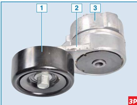
**Автоматическое натяжное устройство в сборе:** 1 – натяжной ролик; 2 – кронштейн ролика; 3 – корпус
