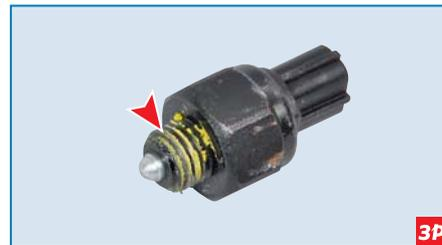
...наносим на резьбовую часть выключателя тонкий слой герметика.
