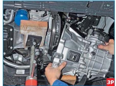
Отводим коробку передач от двигателя, выводя первичный вал из ступицы ведомого диска сцепления, и снимаем коробку передач.
