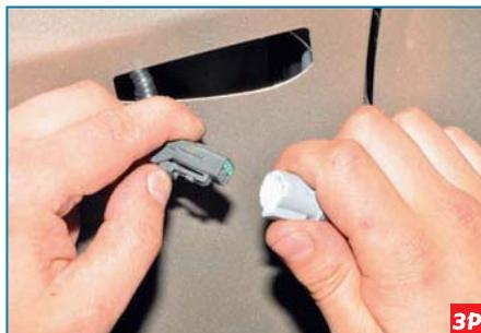
...нажав на фиксатор, отсоединяем колдку проводов от патрона.
