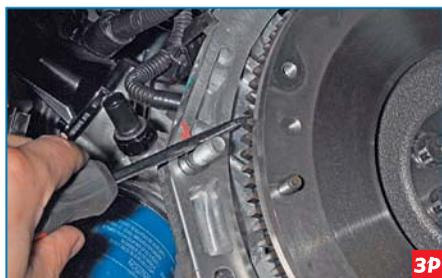
...удерживая вал от проворачивания силовой отверткой, вставленной между зубьями маховика и опирающейся на болт, установленный в отверстие поддона картера.
