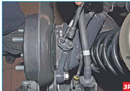
Головкой «на 10» отворачиваем болт крепления датчика к фланцу рычага балки задней подвески...
