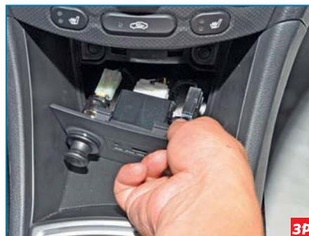
...и преодолев сопротивление фиксаторов, выдвигаем ее из центральной консоли панели приборов.
