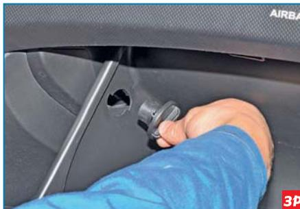
Поворачиваем левый ограничитель открывания вещевого ящика против часовой стрелки и вынимаем его из отверстия.
