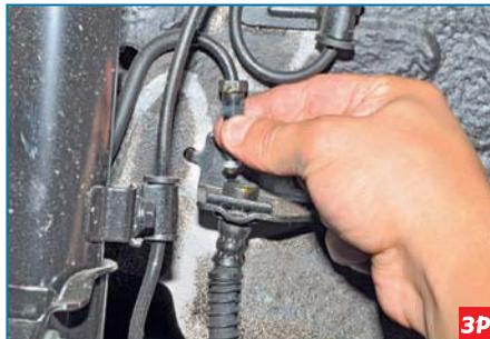
...и отводим штуцер тормозной трубки от верхнего наконечника шланга.
