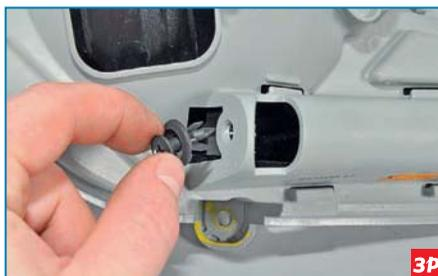
...и вынимаем пистон крепления фары. Аналогично вынимаем другой пистон крепления фары.
