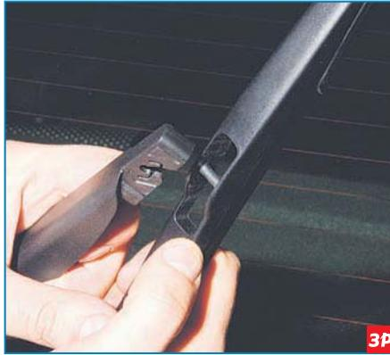
...выталкиваем из фиксаторов рычага и снимаем щетку.
