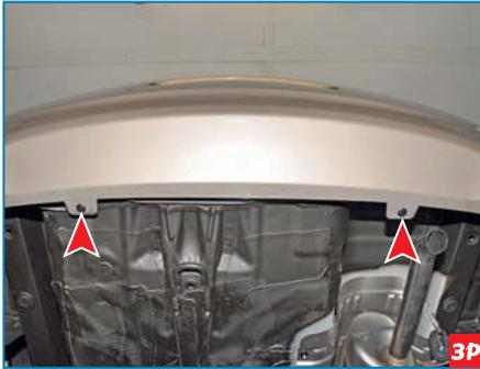
Расположение pistонов нижнего крепления бампера к кронштейнам усилителя.
