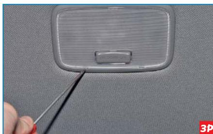
...поддеваем отверткой рассеиватель плафона и...
