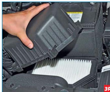
Приподнимаем крышку воздушного фильтра...
