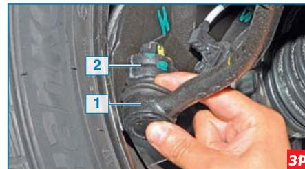
...к корпусу шарового шарнира 1 наружного наконечника рулевой тяги и рычагу поворотного кулака 2, оцениваем их взаимное перемещение.
