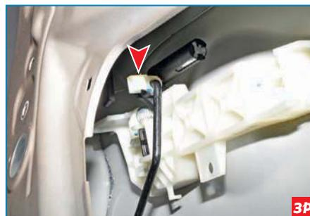
Отжав пластмассовый фиксатор тяги блокировки замка двери, поворачиваем его вокруг оси...
