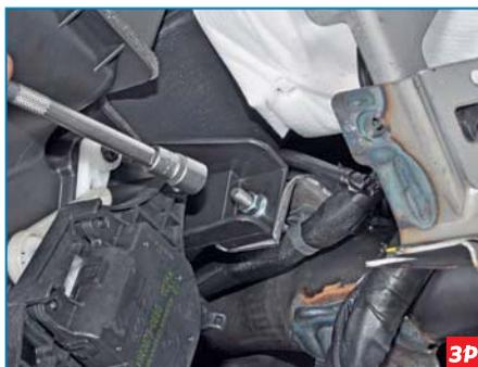
Головкой «на 10» отворачиваем гайку крепления корпуса отопителя к панели приборов.
