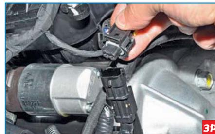
Нажав фиксатор колодки переднего жгута проводов, отсоединяем колодку от колодки жгута проводов датчика положения коленчатого вала.
