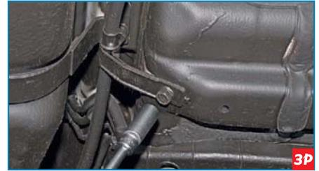
Головкой «на 12» отворачиваем болт крепления держателя оболочки троса, расположенный перед топливным баком...
