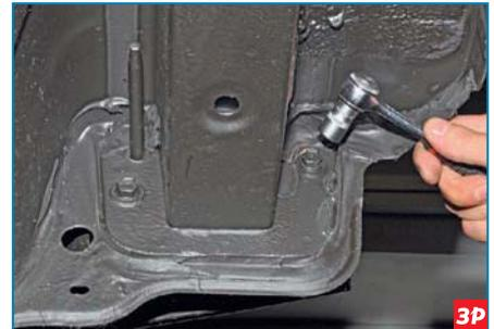
...с каждой стороны автомобиля головкой «на 12» отворачиваем по два болта крепления фланцев усилителя бампера к кузову...
