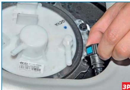
...снимаем наконечник со штуцера крышки модуля.
