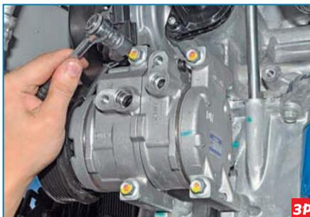
Головкой «на 12» отворачиваем четыре болта крепления компрессора.
