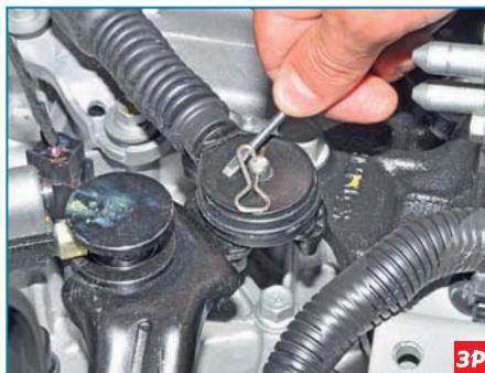
...отверткой поддеваем пружинный шплинт...
