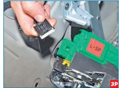
Нажав на фиксатор, отсоединяем колодку жгута проводов от электропривода блокировки замка...
