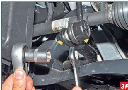
Головкой «на 17» отворачиваем гайку крепления пальца нижнего шарового шарнира стойки к штанге стабилизатора, удерживая палец от проворачивания ключом «на 17».
