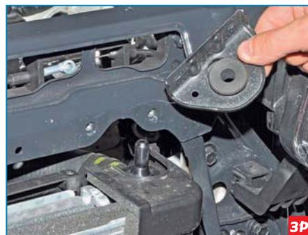
...и снимаем левую опору.
