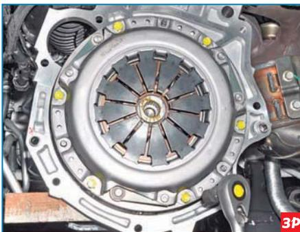
Головкой «на 12» отворачиваем шесть болтов крепления «корзины» сцепления к маховику.
