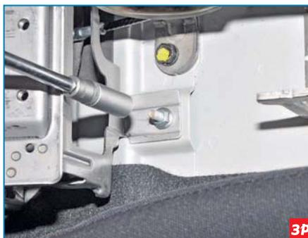
Головкой «на 10» отворачиваем три гайки крепления поддерживающего кронштейна облицовки туннеля пола...
