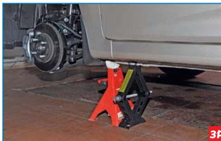
**Не работайте под автомобилем, если он вывешен только на домкрате. Для страховки используйте подставку заводского изготовления.**
