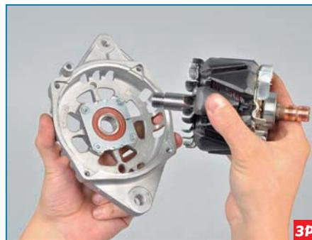
Вынимаем якорь из передней крышки. Для замены переднего подшипника...
