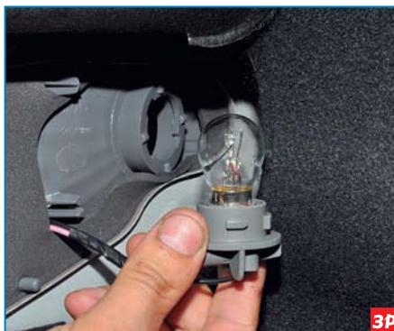
Вынимаем патрон с лампой из корпуса фонаря.
