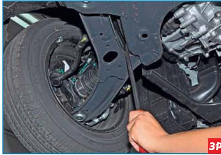
**...вставляем монтажную лопатку между проушиной рычага и подрамником...**
