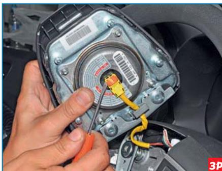
Отверткой поддеваем фиксатор колодки проводов...
