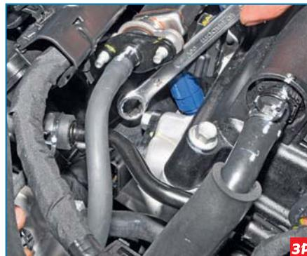
Накидным ключом «на 10» отворачиваем болт крепления датчика к головке блока цилиндров...
