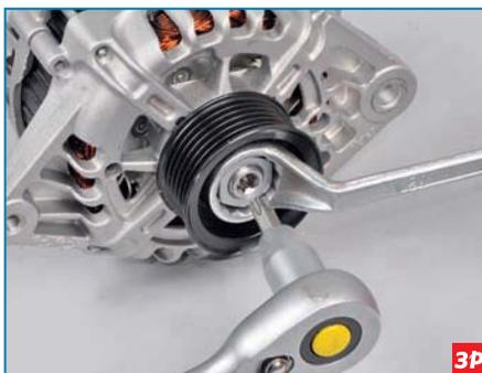
Z-образным ключом «на 24» отворачиваем гайку крепления шкива, удерживая вал ротора ключом Torx T-50.
