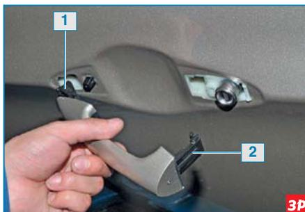
...чтобы поводок 2 ручки вышел из зацепления с рычагом основания ручки, а передний фиксатор 1 вышел из паза основания ручки.
