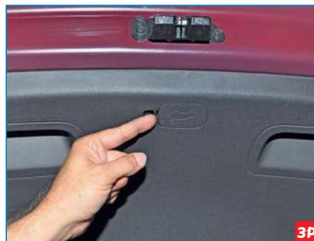
Для удобства снятия обивки, нажимаем на фиксатор...
