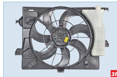
**Кожух вентилятора с расширительным бачком**
