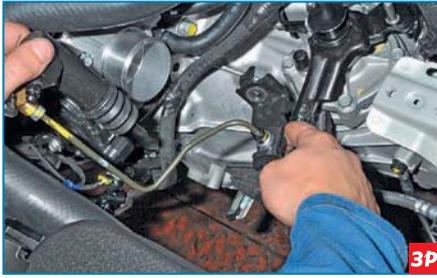
...и отводим его от коробки передач вместе с рабочим цилиндром сцепления.
