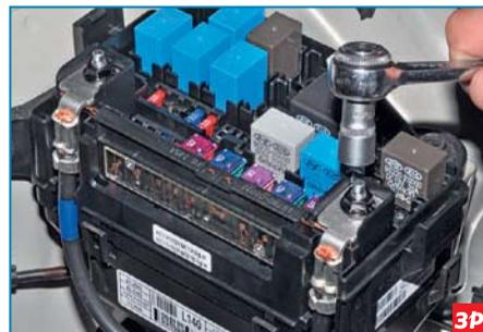
...головкой на «10» отворачиваем гайку крепления блока.
