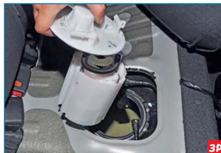
Аккуратно, чтобы не зацепиться поплавком датчика указателя уровня топлива, извлекаем топливный модуль из отверстия топливного бака.
