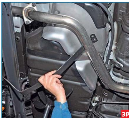
Снимаем хомуты крепления бака. Сдвигаем бак влево, выводя его из-под трубы системы выпуска отработавших газов...
