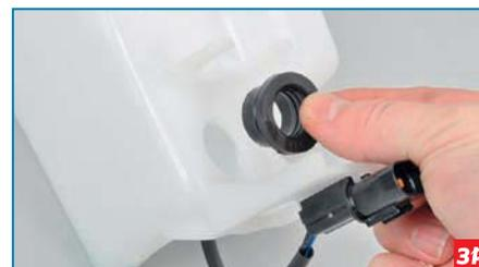
Вынимаем из отверстия бачка резиновое уплотнительное кольцо.
