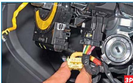
...и отсоединяем колодку проводов желтого цвета от барабанного устройства спирального кабеля подушки безопасности.
