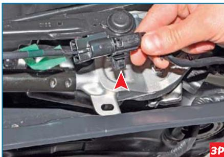
Сжав фиксаторы держателя жгута проводов жгута обогрева зоны остановки щеток стеклоочистителя, снимаем колодку с левого кронштейна очистителя.
