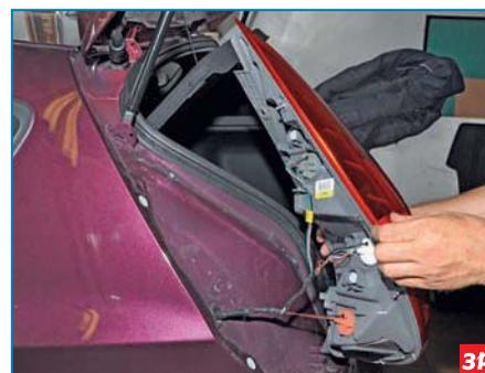
Отводим фонарь от кузова автомобиля.
