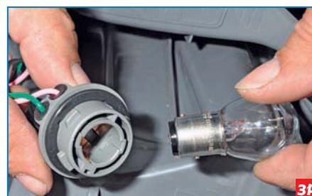
Слегка нажимая на колбу лампы, утапливаем ее в патрон, поворачиваем
