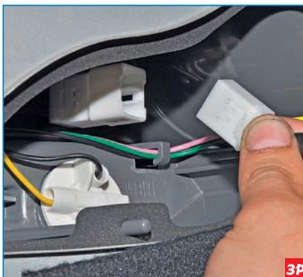
...и отсоединяем колодку от разъема фонаря.
