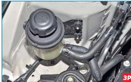
Бачок гидроусилителя рулевого управления установлен в моторном отсеке на кронштейне правого брызговика.
