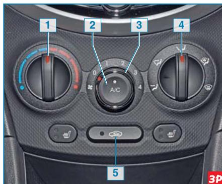
**Блок управления отоплением, вентиляцией и кондиционированием (на автомобилях с ручным включением кондиционера):** 1 – регулятор температуры воздуха; 2 – кнопка выключателя кондиционера; 3 – переключатель режимов работы вентилятора отопителя; 4 – регулятор распределения потоков воздуха; 5 – кнопка выключателя режима рециркуляции воздуха
