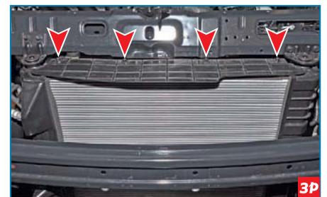
...четыре самореза крепления пластмассового щитка рамки радиатора...
