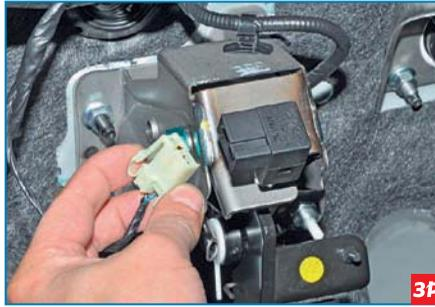
Нажав на фиксатор, отсоединяем колодку жгута проводов от датчика положения педали сцепления.
