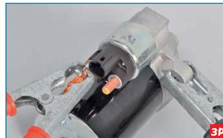
...соединяем проводами «плюсовой» вывод аккумуляторной батареи с левым контактным болтом тягового реле, а «минусовой» вывод – с корпусом стартера.
