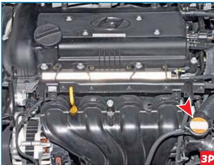
...накрываем крышку заливной горловины системы охлаждения плотной
