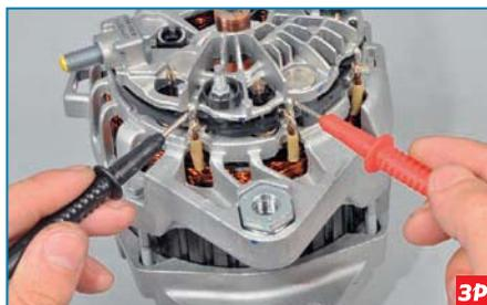
...подсоединяем щупы тестера (в режиме омметра) к выводам обмоток. Если тестер покажет бесконечность, значит в обмотке есть обрыв и нужно заменить статор или генератор. Аналогично проверяем остальные обмотки статора.
