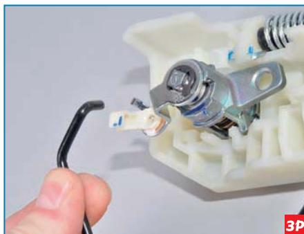
...и вынимаем конец тяги из отверстия рычага цилиндрического механизма замка.
