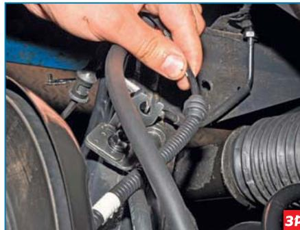
Выводим резиновую втулку жгута проводов из отверстия кронштейна рычага балки задней подвески.
