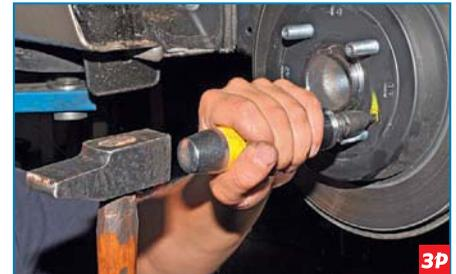
...отворачиваем его ударной отверткой.
