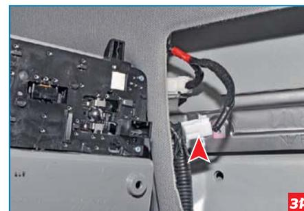
Нажав на фиксатор колодки проводов, отсоединяем ее от разъема плафона...
