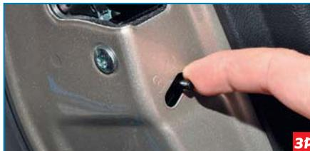
Для блокировки внутренней ручки задней двери перемещаем защелку назад.
