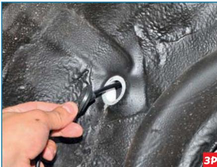
...проталкиваем ее внутрь арки колеса...
