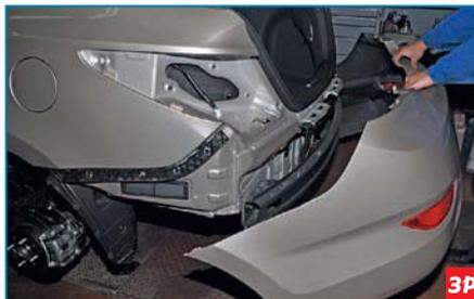
...и снимаем бампер.
