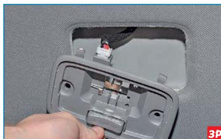
...выводим плафон из отверстия в обивке потолка.
