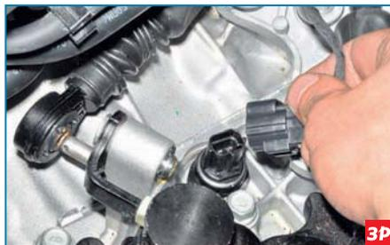
Нажав на фиксатор колодки проводов, отсоединяем ее от разъема выключате-
