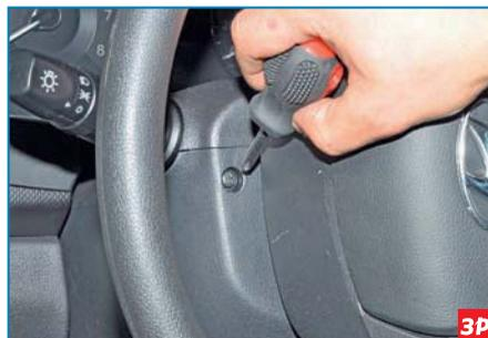
...крестообразной отверткой отворачиваем саморез крепления нижнего кожуха рулевой колонки.
