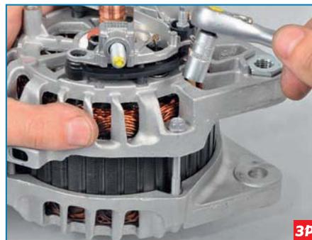
Головкой «на 8» отворачиваем четыре стяжных болта.
