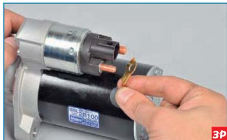
...и снимаем наконечник провода с вывода тягового реле.
