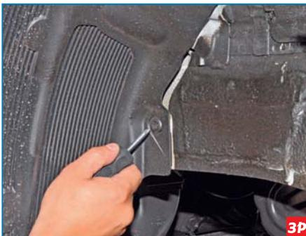
Крестообразной отверткой выворачиваем фиксатор пистона переднего крепления подкрылка...
