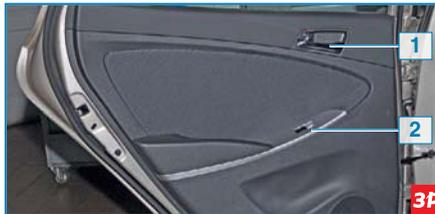
**Задняя дверь:** 1 – внутренняя ручка; 2 – выключатель электростеклоподъемника
