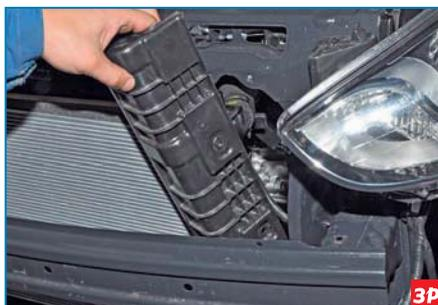
...и снимаем левый направляющий кожух.
