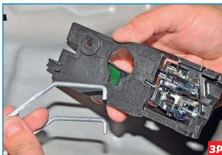
Аналогично вынимаем конец тяги открывания замка двери из другого рычага ручки и снимаем внутреннюю ручку задней двери.
