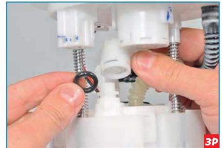
Аналогично с входного штуцера фильтра снимаем наконечник трубки топливного насоса.
