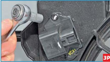
Головкой «на 8» отворачиваем саморез крепления корпуса дополнительного резистора к кожуху вентилятора...
