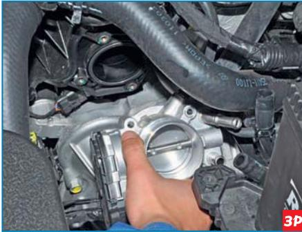
Отводим от впускного трубопровода дроссельный узел.
