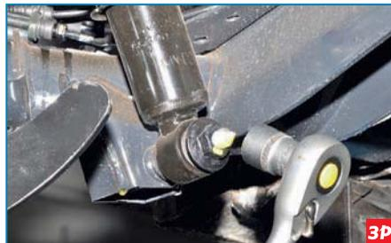
Головкой или ключом «на 19» отворачиваем гайку нижнего крепления амортизатора.
