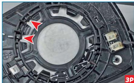
...два фиксатора отражающего элемента.
