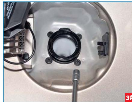
Головкой «на 8» отворачиваем четыре болта крепления наливной трубы к кузову.
