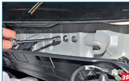
Головкой «на 12» отворачиваем два болта крепления панели приборов к щитку передка.
