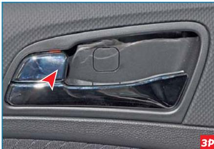
Изнутри автомобиля каждую из боковых дверей можно заблокировать нажатием на клавишу переключателя внутренней ручки двери.
