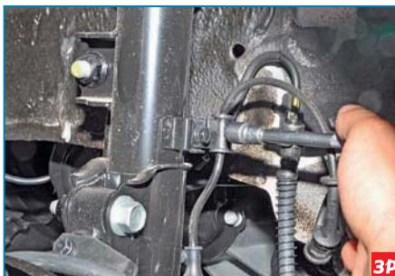
Головкой «на 10» отворачиваем болт крепления держателя жгута проводов к кронштейну амортизаторной стойки.
