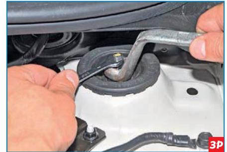
...удерживая при необходимости шток амортизатора от проворачивания ключом «на 7»...
