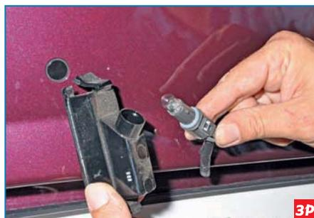
...и вынимаем патрон с лампой из корпуса фонаря.
