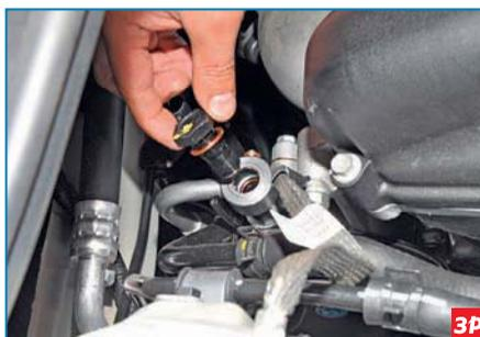
...и вынимаем его вместе с медной прокладкой.
