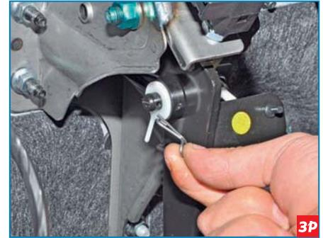
...извлекаем пружинный шплинт из отверстия пальца педали.
