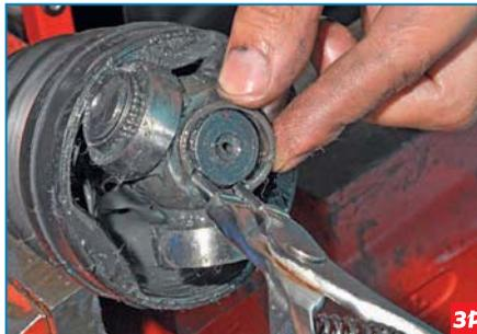
Щипцами для снятия стопорных колец разжимаем и снимаем стопорное кольцо с вала.
