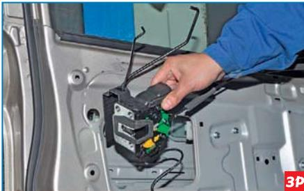
...и выводим его в сборе с электроприводом, тягами и тросами через технологическое отверстие во внутренней панели двери.
