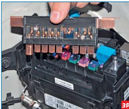
Вынимаем блок силовых предохранителей из монтажного блока...
