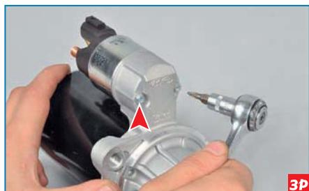
Ключом Torx T-20 отворачиваем два винта...
