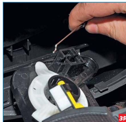
Отсоединяем тягу от регулятора температуры воздуха...
