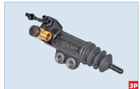
**Рабочий цилиндр гидропривода сцепления**
