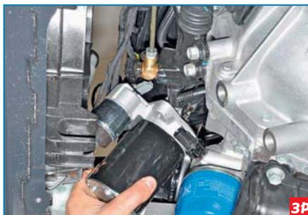
Снимаем стартер. Для оценки исправности привода стартера...
