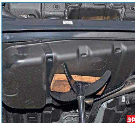
...опускаем бак на регулируемом упоре и снимаем бак.
