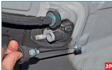
Вытягиваем оболочку троса из отверстия втулки, приваренной к днищу кузова.
