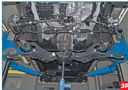
Опускаем упор, снимаем подрамник в сборе с рычагами и штангой стабилизатора поперечной устойчивости.
