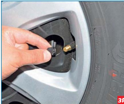
...отворачиваем колпачок колесного вентиля...
