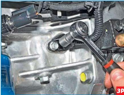
Головкой «на 10» отворачиваем болт крепления датчика...
