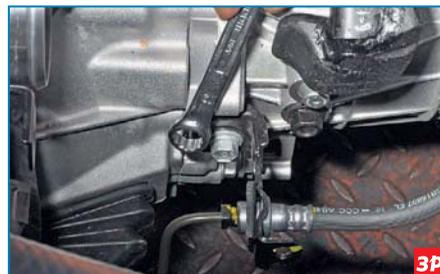
Накидным ключом «на 12» отворачиваем болт крепления кронштейна шланга гидропривода выключения сцепления...
