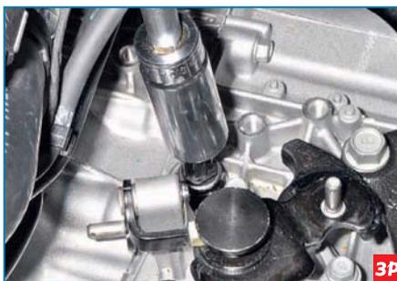
...высокой головкой «на 24» выворачиваем выключатель света заднего хода...
