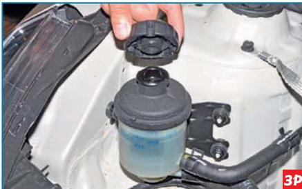
...повернув против часовой стрелки, снимаем крышку бачка.
