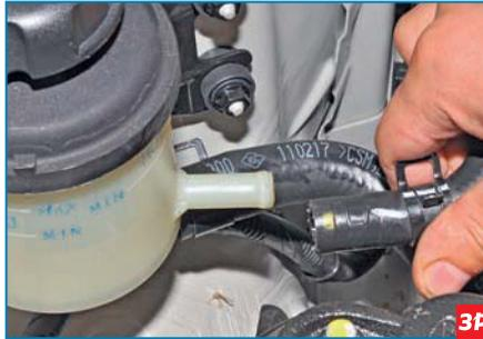
...и снимаем шланг с патрубка бачка.
