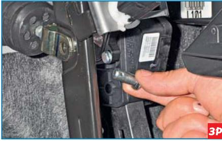
Вынимаем палец из отверстий педали и вилки толкателя.
