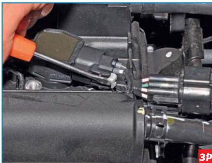
Отверткой сдвигаем фиксатор колодки проводов...
