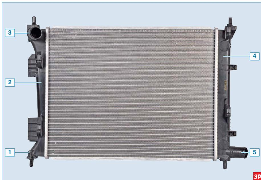
**Радиатор:** 1 – пробка сливного отверстия; 2 – левый бачок радиатора; 3 – подводящий патрубок радиатора; 4 – правый бачок радиатора; 5 – отводящий патрубок радиатора
