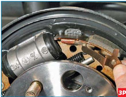
Снимаем регулировочный рычаг.
