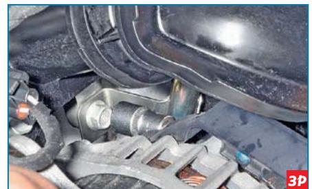
Головкой «на 10» отворачиваем на несколько витков резьбы болт крепления направляющей трубки указателя уровня масла в двигателе.
