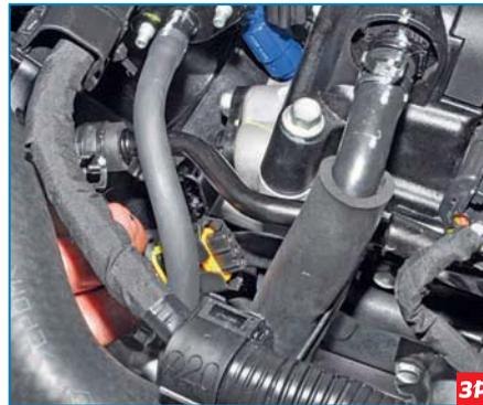
Нажав фиксатор колодки переднего жгута проводов, отсоединяем колодку от разъема датчика положения распределительного вала.
