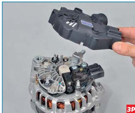
...и снимаем кожух генератора.
