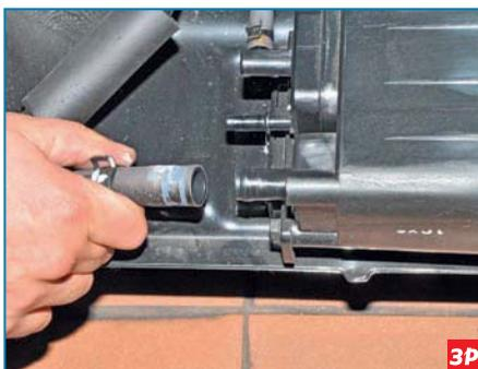
...и снимаем шланг со штуцера адсорбера.
