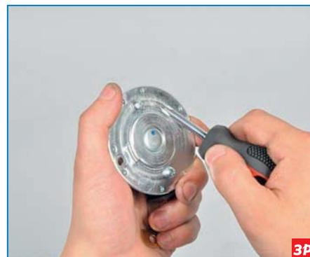
Крестообразной отверткой отворачиваем два винта крепления щеткодержателя.
