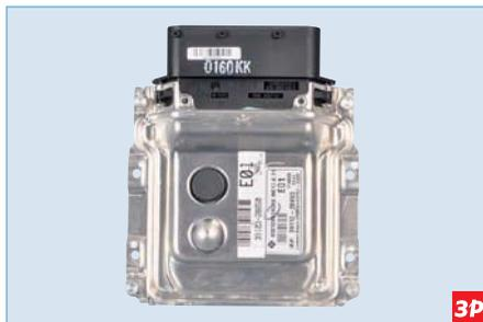
**Электронный блок управления двигателем**
