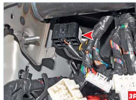
**Реле указателей поворота и аварийной сигнализации**
