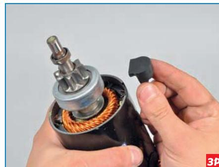
Снимаем уплотнитель рычага.
