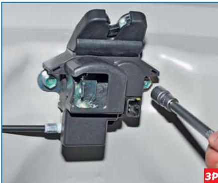
Головкой «на 10» отворачиваем два болта крепления замка к внутренней панели крышки багажника...
