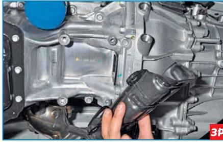
...и снимаем его. Устанавливаем под двигатель и коробку передач регулируемые упоры.
