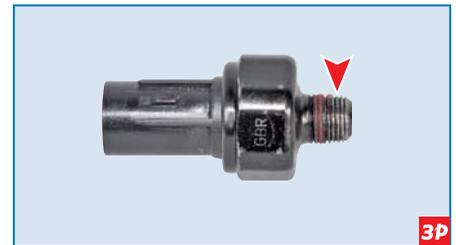
Перед установкой датчика наносим на его резьбовую поверхность тонкий слой герметика.
