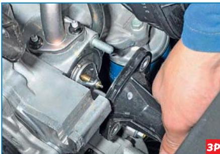
...и сдвигаем крышку термостата со шпилек блока цилиндров, не отсоединяя от крышки отводящий шланг радиатора.
