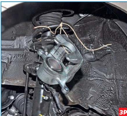
...и подвязываем суппорт к пружине амортизаторной стойки.
