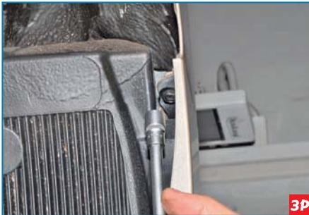
Головкой на 10» отворачиваем с обеих сторон автомобиля саморезы крепления бампера к задним крыльям.
