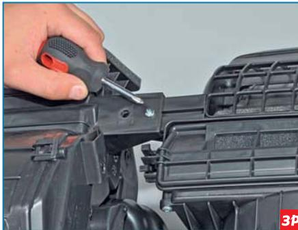
Крестообразной отверткой отворачиваем саморез центрального верхнего...
