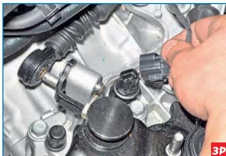
Нажав на фиксатор, отсоединяем колодку проводов от выключателя света заднего хода.
