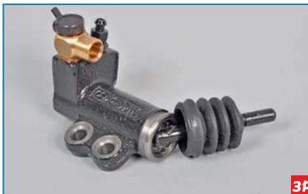
Для замены пыльника сдвигаем его с кольцевой канавки корпуса рабочего
