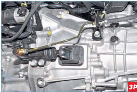
Рабочий цилиндр закреплен на картере сцепления двумя болтами
