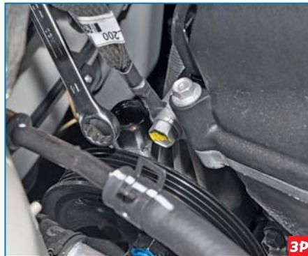
Накидным ключом «на 14» отворачиваем болт крепления насоса гидроусилителя рулевого управления, который также крепит наконечник провода «массы» к головке блока цилиндров двигателя.
