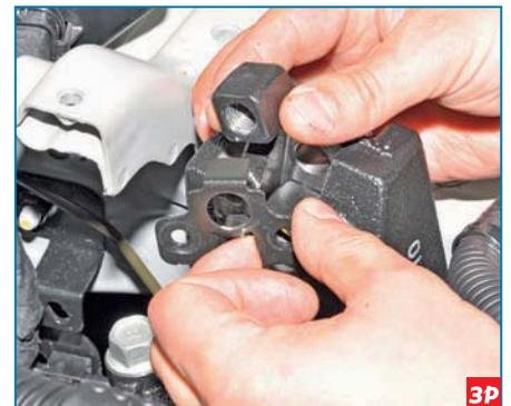
Снимаем стопорную пластину и вынимаем из паза кронштейна две закладные гайки болтов крепления опоры. Устанавливаем левую опору силового агрегата в обратной последовательности.
