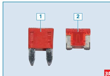
На автомобиле установлены предохранители 2 с короткими контактами.
