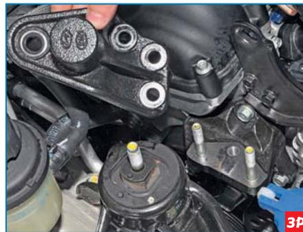
Снимаем кронштейн опоры со шпилек кронштейна двигателя.
