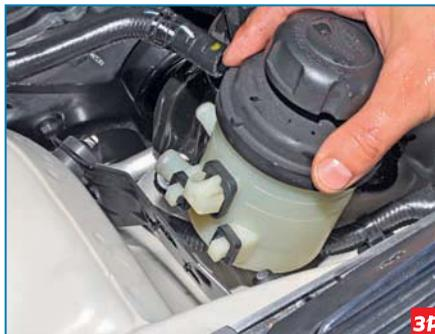
...и снимаем бачок с кронштейна.
