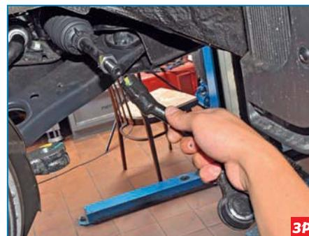
Снимаем наконечник рулевой тяги.
