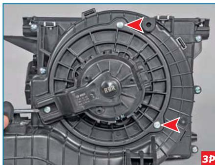
Крестообразной отверткой отворачиваем три самореза (для наглядности показано на снятом корпусе вентилятора)...
