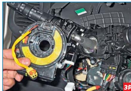
Снимаем барабанное устройство спирального кабеля.
