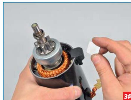
Снимаем опору рычага.
