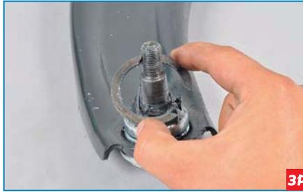
...вынимаем его из проточки шаровой опоры.
