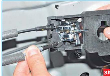
...вынимаем наконечник оболочки троса блокировки замка из паза основания ручки.
