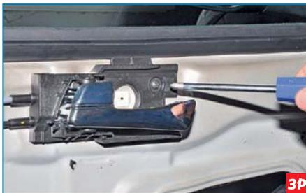
Крестообразной отверткой отворачиваем саморез крепления основания
