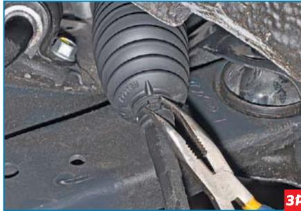
Пассатижами разжимаем малый хомут крепления защитного чехла и снимаем его с чехла и рулевой тяги.
