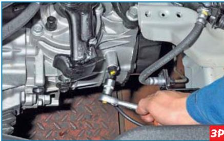
Головкой «на 12» отворачиваем болт крепления наконечника провода «массы».
