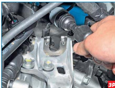
...и вынимаем втулку оболочки троса включения передач из кронштейна.
