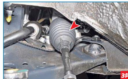
Проверяем состояние чехлов рулевого механизма.
