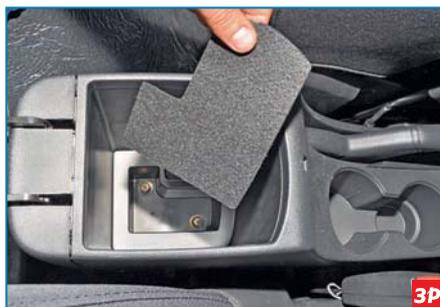
Вынимаем из ниши для мелких вещей прокладку.
