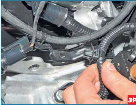
Вынимаем держатель жгута проводов датчика из отверстия в кронштейне.
