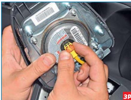
...и выдвигаем фиксатор.
