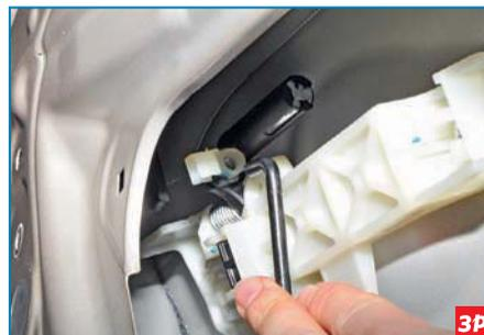
...и вынимаем конец тяги из отверстия рычага основания ручки.
