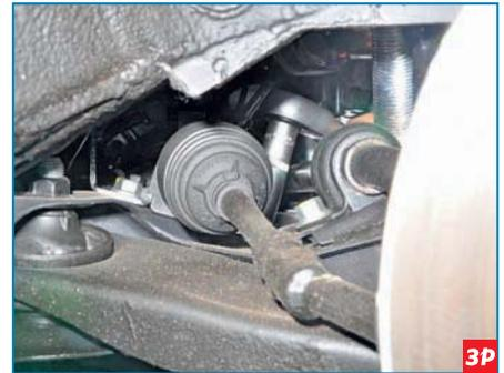
Головкой «на 17» отворачиваем по два болта крепления рулевого механизма к подрамнику с правой и левой его стороны.
