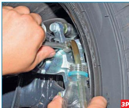
Накидным ключом «на 10» отворачиваем штуцер прокачки на 1/2–3/4 оборота.
