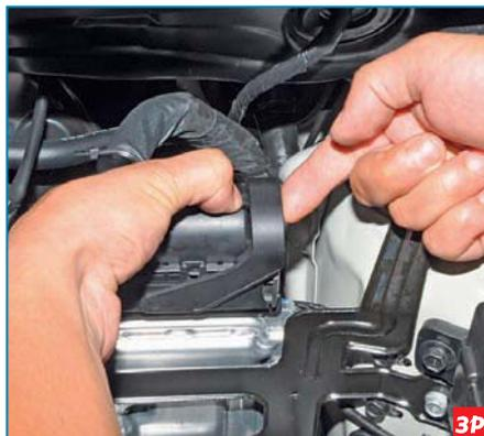
Нажав фиксатор, поднимаем скобу крепления колодки переднего жгута проводов...
