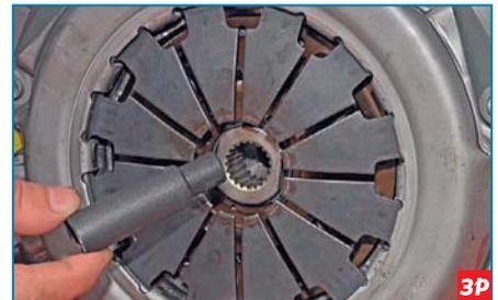
Вставляем центрирующую оправку (подходит оправка для сцепления автомобилей ВАЗ) в шлицы ступицы ведомого диска и вводим хвостовик оправки в отверстие фланца коленчатого вала.
