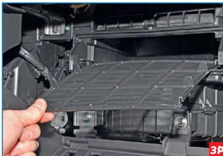
Вынимаем фильтр из корпуса отопителя.
