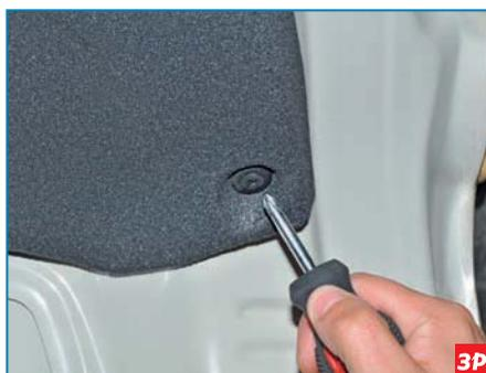
Крестообразной отверткой выворачиваем фиксаторы девяти pistонов крепления обивки крышки багажника...
