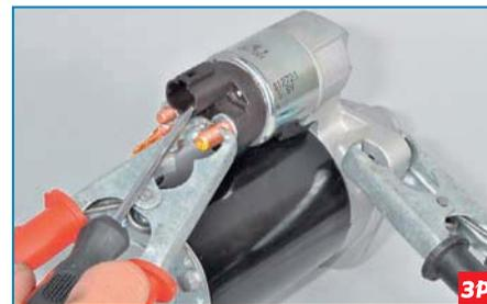
Отверткой перемикаем правый контактный болт и управляющий вывод тягового реле.
