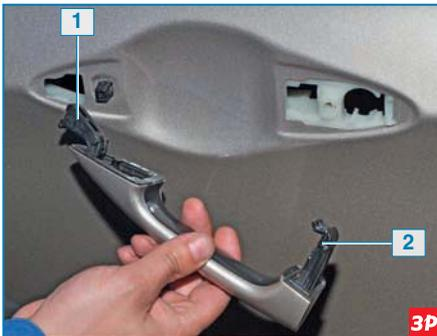
...чтобы поводок 2 ручки вышел из зацепления с рычагом основания ручки, а передний фиксатор 1 вышел из паза основания ручки.
