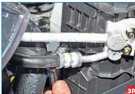
...и болт верхнего крепления правого направляющего кожуха к кронштейну бачка радиатора.
