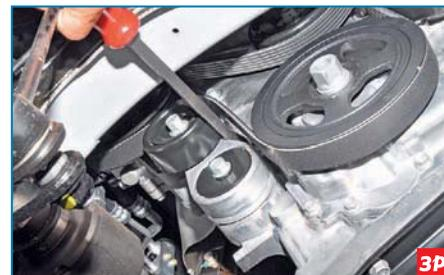
Монтажной лопаткой отжимаем кронштейн натяжного ролика, ослабляя натяжение ремня...
