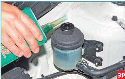
Доливаем жидкость в бачок до метки MAX.
