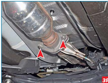
...и дополнительному глушителю с резонатором.
