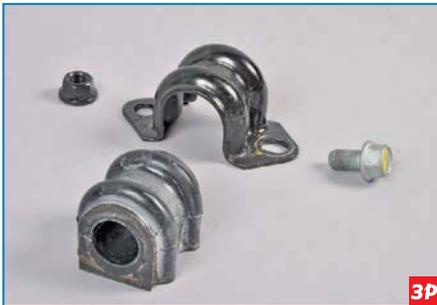
Разрез в подушке должен быть направлен к передней части автомобиля. В круглое отверстие кронштейна входит шпилька подрамника, а в овальное отверстие – болт крепления кронштейна. Устанавливаем новые подушки на штангу и крепим ее к подрамнику. Болты и гайки крепления кронштейнов штанги стабилизатора затягиваем предписанными моментами (см. «Приложения», с. 266).
