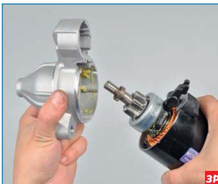
Снимаем переднюю крышку стартера.
