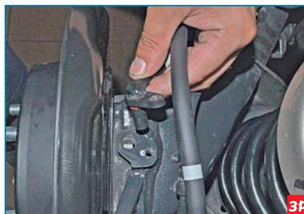
...и снимаем датчик.
