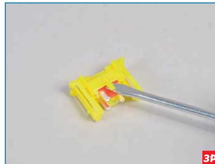
Поддев отверткой фиксатор...
