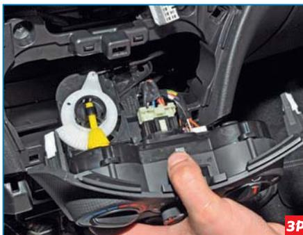
...и отводим блок от панели приборов.
