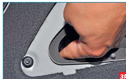
Поворачиваем против часовой стрелки патрон лампы противотуманного света
