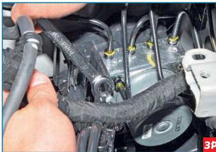
Специальным ключом «на 11» для штуцеров тормозных трубок отворачиваем две тормозные трубки, соединяющиеся с главным тормозным цилиндром
