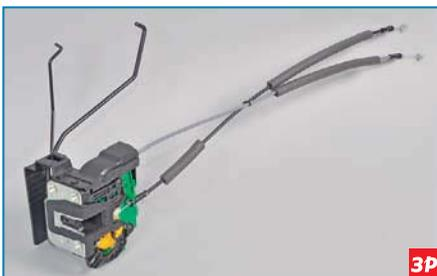
Замок передней двери в сборе с электроприводом, тягами наружной ручки и тросами внутренней ручки.
