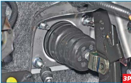
Головкой «на 12» отворачиваем четыре гайки крепления вакуумного усилителя.
