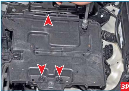
Тем же инструментом отворачиваем четыре болта крепления площадки под аккумуляторную батарею (задний болт на фото не виден).
