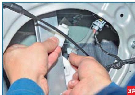
...вынимаем из отверстия стекла составные части держателя стекла. Аналогично снимаем части другого держателя.
