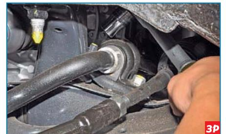
Накидным ключом или головкой «на 14» отворачиваем один болт и одну гайку крепления кронштейна штанги стабилизатора к подрамнику.
