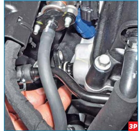
...и вынимаем датчик из гнезда головки блока цилиндров.
