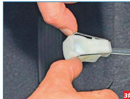
Разжимаем пружинную скобу наконечника троса включения передач (для наглядности показано на снятом наконечнике)...
