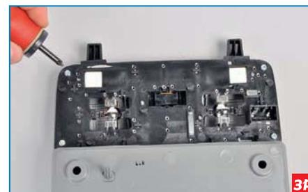
...крестообразной отверткой отворачиваем четыре самореза крепления платы к корпусу плафона.
