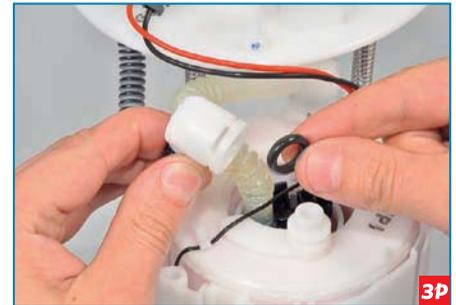
Снимаем наконечник трубки с выходного штуцера топливного фильтра и вынимаем уплотняющее соединение резиновое кольцо.
