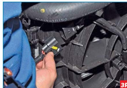
Нажав фиксатор, отсоединяем колодку жгута проводов от разъема дополнительного резистора вентилятора.
