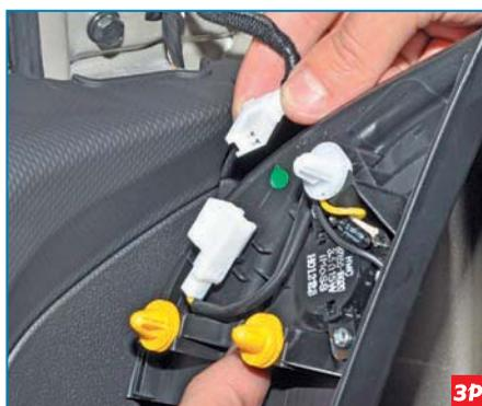
Разъединяем колодки жгутов проводов.
