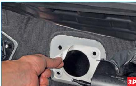
Проверяем состояние уплотнительной прокладки между вакуумным усилителем и щитком передка кузова. При необходимости заменяем новой. Устанавливаем вакуумный усилитель тормозов в обратной последовательности. Прокачиваем гидропривод
