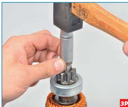
Оправкой (можно использовать подходящую высокую головку) спрессовываем ограничительное кольцо хода шестерни привода.
