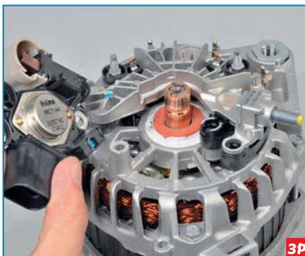
...и снимаем щеткодержатель с регулятором напряжения в сборе.
