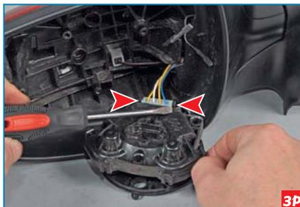
Шлицевой отверткой нажимаем на два фиксатора колодки проводов...
