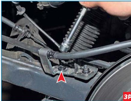
Головкой «на 12» отворачиваем гайку крепления держателя оболочки троса к рычагу балки заднего моста...
