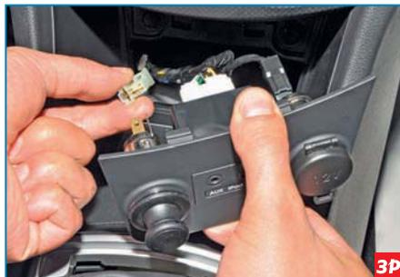
Снимаем панель дополнительного оборудования...
