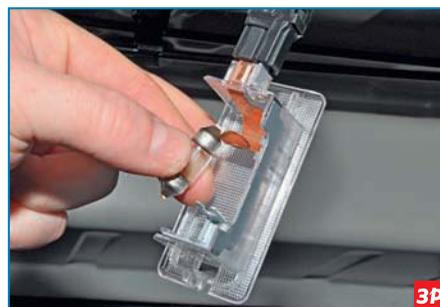
**Вынимаем лампу из плафона.**
