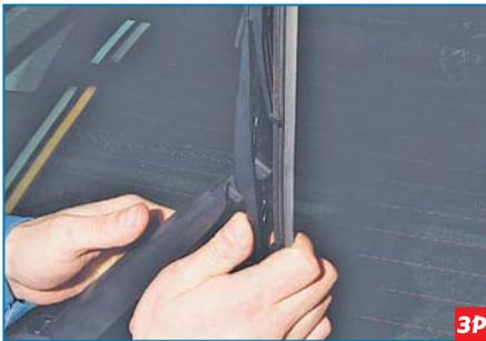
Поворачиваем щетку, примерно, под углом 45° к рычагу и, нажав на нее...
