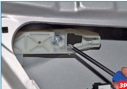
Крестообразной отверткой отворачиваем саморез переднего крепления основания наружной ручки...
