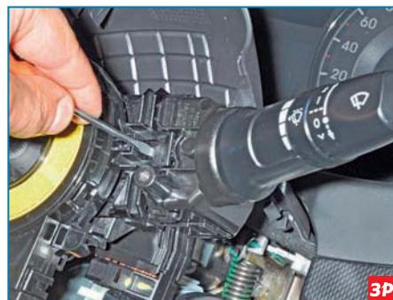
Отверткой нажимаем на фиксатор переключателя...
