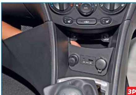
...рукой нажимаем изнутри на панель дополнительного оборудования...
