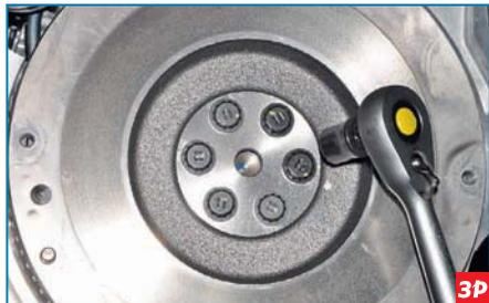
Двенадцатигранной головкой «на 14» отворачиваем шесть болтов крепления маховика к фланцу коленчатого вала...
