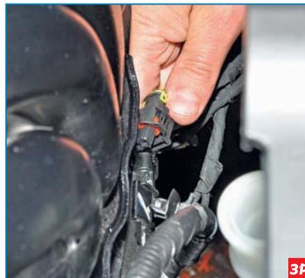
Нажав на фиксатор колодки переднего жгута проводов, отсоединяем ее от колодки жгута проводов датчика детонации.
