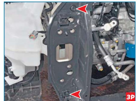
Головкой «на 12» отворачиваем с каждой стороны рамки по два болта ее крепления к лонжеронам...
