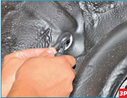
Отверткой извлекаем резиновую уплотнительную втулку из отверстия кузова в арке заднего колеса...
