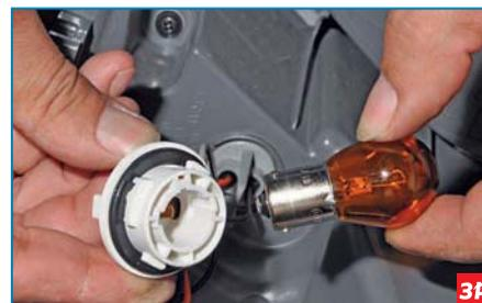
Слегка нажимая на колбу лампы, утапливаем ее в патрон, поворачиваем против часовой стрелки и вынимаем из патрона.
