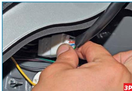
...нажимаем на фиксатор колодки проводов...
