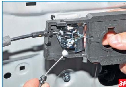
Отсоединяем наконечник троса от рычага блокировки замка двери.
