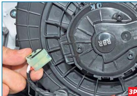
...нажав на фиксатор колодки, отсоединяем колодку проводов от электродвигателя вентилятора (для наглядности показано на снятой панели приборов). Для удобства работы можно...
