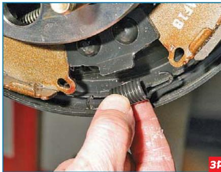
Аналогично снимаем нижнюю стяжную пружину. Придерживая опорную стойку передней колодки с обратной стороны тормозного щита...
