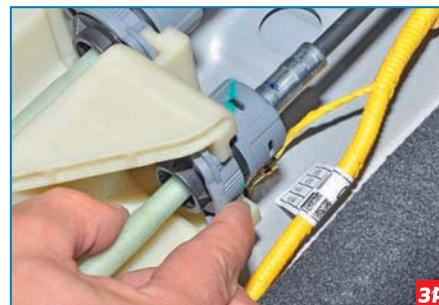
Поджимаем фиксатор наконечника оболочки троса назад...
