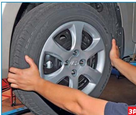
Помощник, взявшись за колесо, качает его в горизонтальной плоскости – несколько раз поочередно резко тянет заднюю часть колеса на себя, а переднюю часть – от себя, и наоборот.
