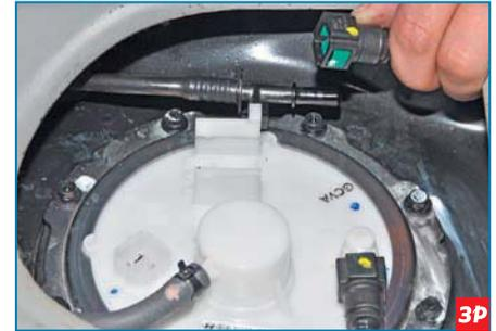
Нажав на фиксаторы наконечника трубки подвода паров топлива к клапану продувки адсорбера, отсоединяем наконечник от трубки, соединяющейся со штуцером адсорбера.
