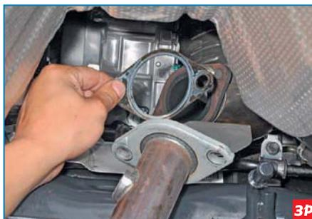
Сдвигаем фланец промежуточной трубы со шпилек на фланце катколлектора, снимаем уплотнительную прокладку и промежуточную трубу.
