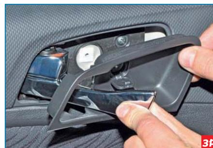
Снимаем декоративную накладку внутренней ручки, выводя рычаг ручки через отверстие в накладке.
