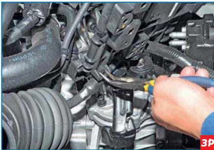
...пассатижами сжимаем фиксатор держателя жгута проводов.
