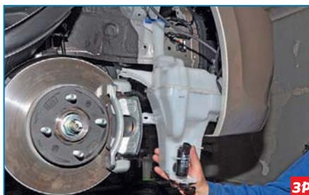
Снимаем бачок с насосом и датчиком уровня.
