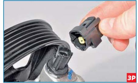
...отсоединяем ее от датчика давления рабочей жидкости.
