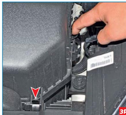
Отстегиваем две пружинные защелки.
