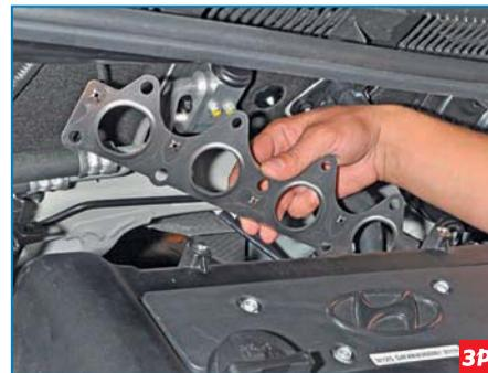
Снимаем металлическую прокладку катколлектора.
