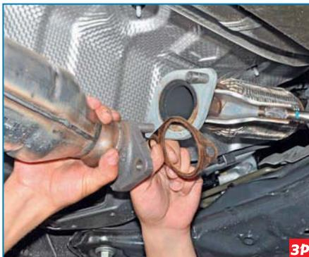
Сдвигаем назад фланец резонатора со шпилек фланца промежуточной трубы и снимаем уплотнительную прокладку.
