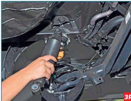
Снимаем амортизатор в сборе с защитным кожухом.
