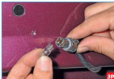
Потянув лампу за колбу, вынимаем ее из контактных зажимов патрона.
