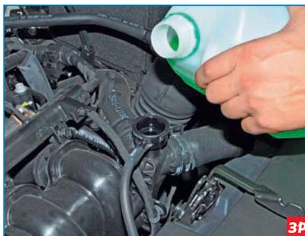
Заливаем охлаждающую жидкость через заливную горловину до тех пор, пока жидкость не потечет в расширительный бачок.
