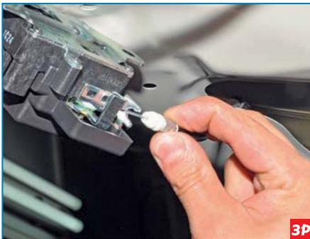
Отводим замок от внутренней панели крышки багажника...
