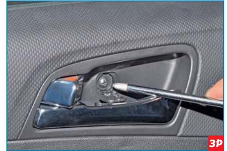
Крестообразной отверткой отворачиваем саморез крепления декоративной накладки к внутренней панели двери.
