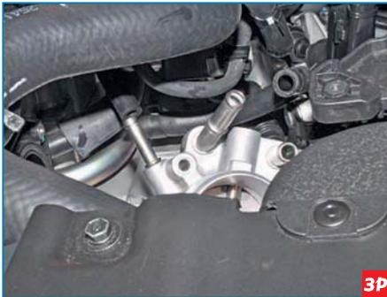
...и снимаем шланг со штуцера дроссельного узла.
