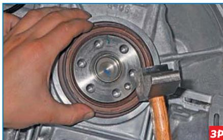
...и запрессовываем его в гнездо с помощью старого сальника.
