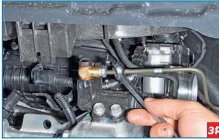
Специальным ключом «на 11» для штуцеров тормозных трубок, отворачиваем штуцер трубки подвода жидкости к рабочему цилиндру...
