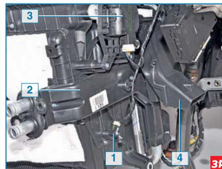
Корпус отопителя: 1 – датчик температуры воздуха, поступающего в салон; 2 – крышка радиатора; 3 – электропривод распределительных заслонок; 4 – воздуховод к ногам водителя.
