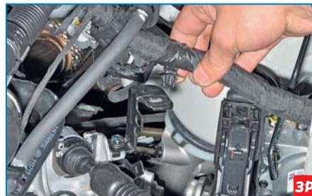
Сжав фиксаторы держателя жгута проводов, вынимаем держатель из отверстия кронштейна коробки передач.
