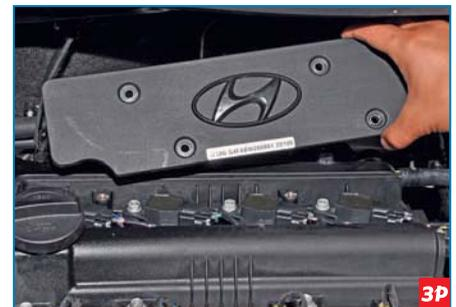
...и снимаем крышку.
