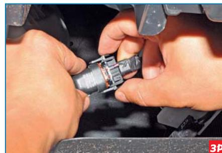
Сжимаем фиксаторы колодки проводов...
