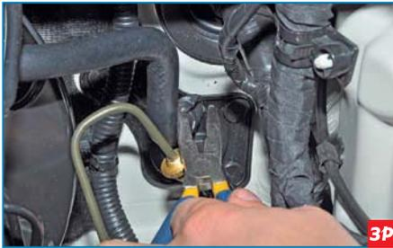
Пассатижами сжимаем концы хомута крепления шланга подвода рабочей жидкости к главному цилиндру сцепления, сдвигаем его по шлангу...
