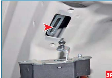
Поворачиваем замок так, чтобы рычаг замка вышел из паза тяги привода цилиндрического механизма замка и снимаем замок крышки багажника.
