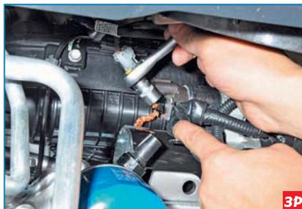
Головкой «на 12» отворачиваем гайку...
