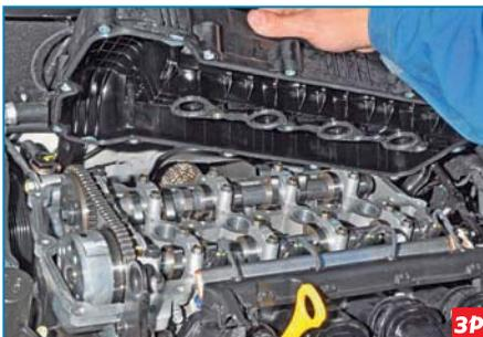
...и снимаем крышку.
