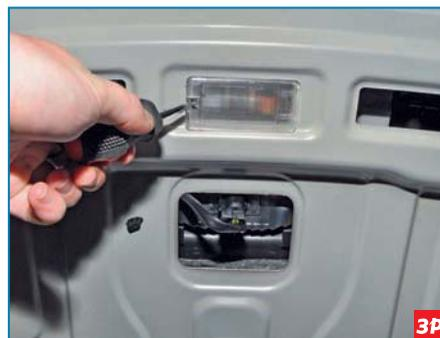
Шлицевой отверткой с тонким лезвием нажимаем на фиксатор плафона...
