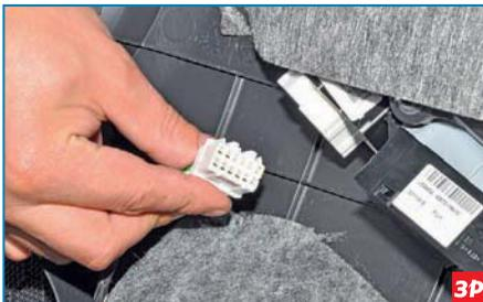
Нажав на фиксатор, отсоединяем колодку проводов от разъема регулятора управления электропривода наружных зеркал заднего вида...
