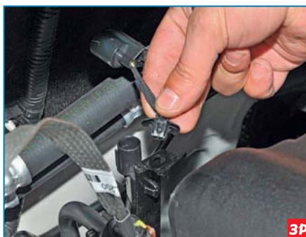
...и вынимаем держатель из кронштейна колодки.
