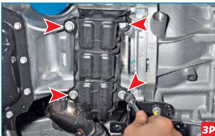
...головкой «на 12» отворачиваем четыре болта крепления воздуховода обдува внутреннего шарнира привода правого колеса...
