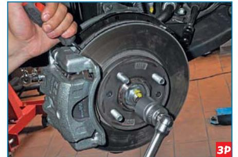
Удерживая от проворачивания приводной вал отверткой, вставленной в отверстие для вентиляции тормозного диска, головкой «на 32» отворачиваем гайку ступицы (отвертка упирается в тормозную скобу).
