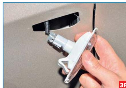
...вынимаем указатель из отверстия в переднем крыле.
