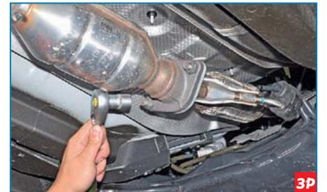
Головкой «на 19» отворачиваем две гайки шпилек крепления фланцев промежуточной трубы и резонатора.
