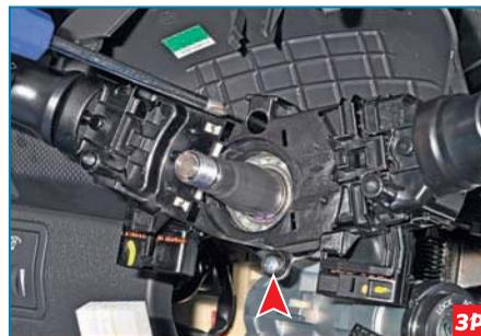
Крестообразной отверткой отворачиваем два винта...
