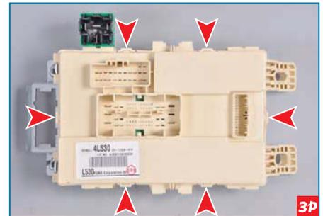
Расположение фиксаторов нижней крышки.
